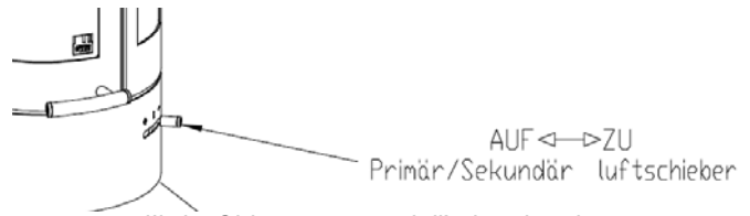
III. 3 : Chiusura presa dell'aria primaria
