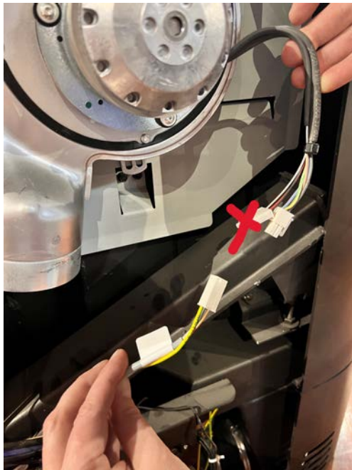
Fig. 9: Raccorder les câbles
