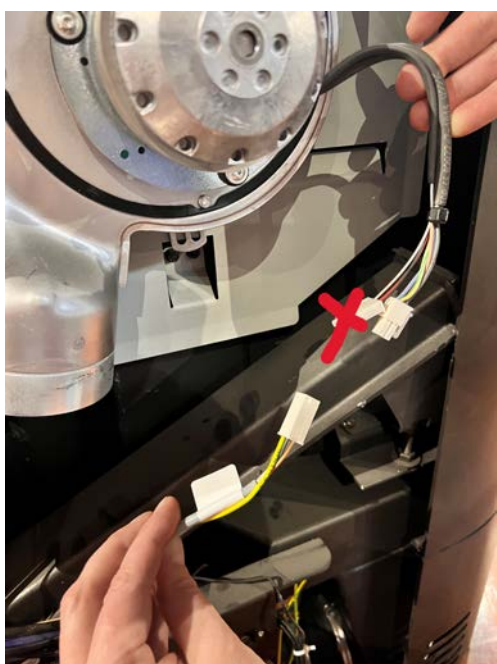
Fig. 23: Collegamento del cavo
