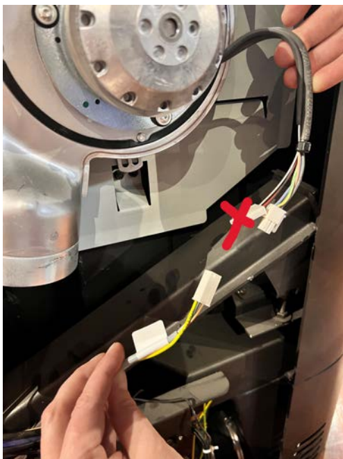
Fig. 38: Raccorder les câbles
