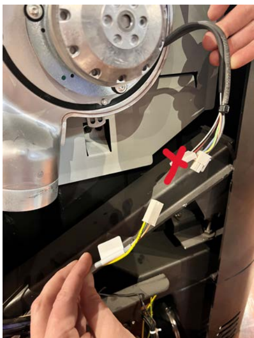
Fig. 38: Collegamento del cavo
