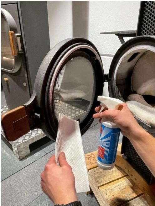
Fig. 25: Pulizia del vetro della camera di combustione
