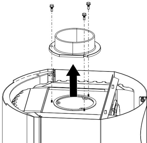
Fig. 32: Démontez la tubulure de fumées
