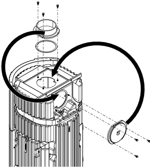
Fig. 23: Échanger le recouvrement et la tubulure
