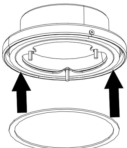
Fig. 33: Poser le joint sur la tubulure tournante
