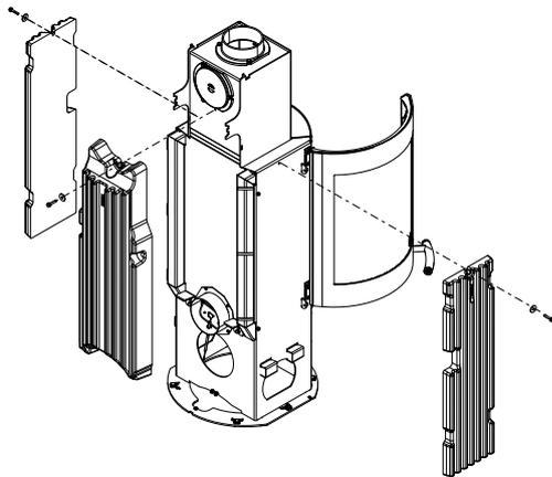
Fig. 26: Installer les pierres HMS
