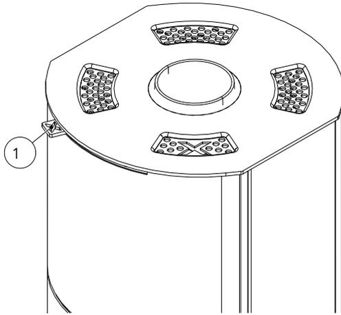
Fig. 46: Manette de régulation de l'air de convection
