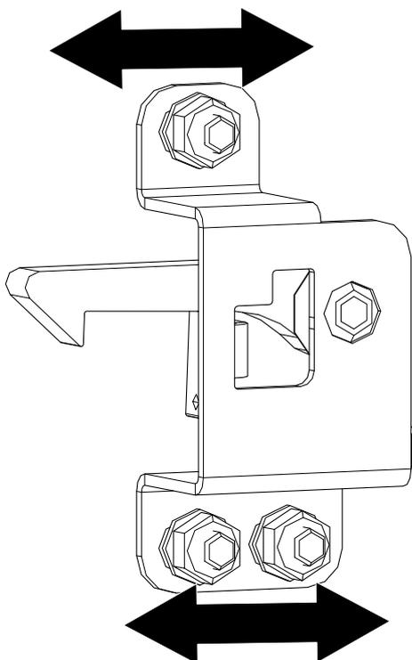
Fig. 26: Regolazione della serratura dello sportello
