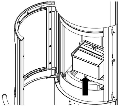
Fig. 33: Rimozione e svuotamento del box cenere
