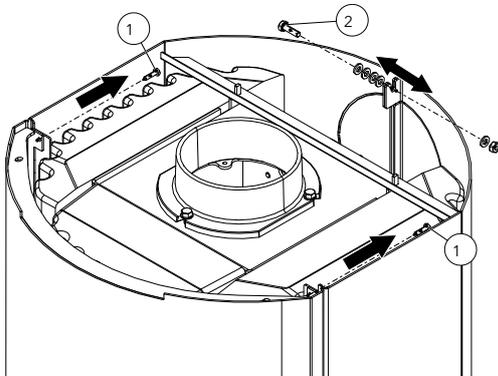
Fig. 37: Svitamento delle viti
