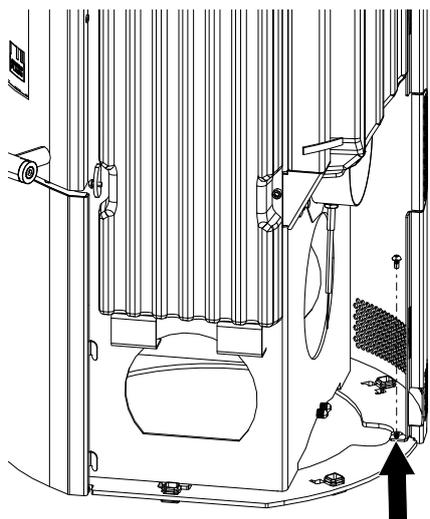
Fig. 43: Svitamento delle viti posteriori del rivestimento laterale
