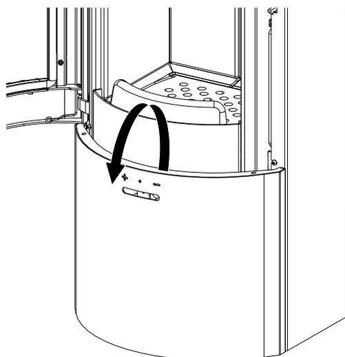
Fig. 40: Rimozione della copertura inferiore
