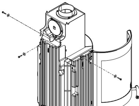
Fig. 47: Rimozione delle pietre HMS
