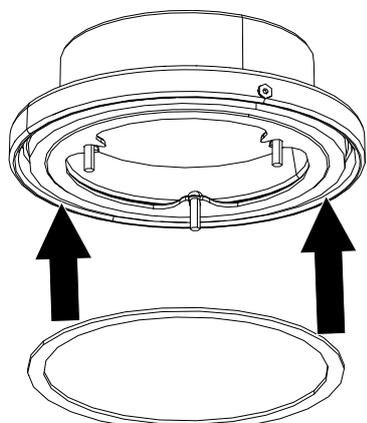
Fig. 22: Montaggio della guarnizione sul giunto girevole
