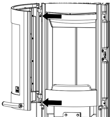
Fig. 44: Svitamento delle viti della porta
