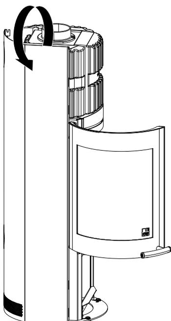
Fig. 45: Rimozione del rivestimento laterale sinistro
