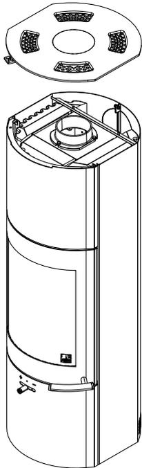
Fig. 36: Rimozione del coperchio
