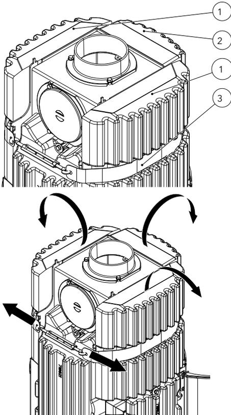
Fig. 46: Rimozione della cinghia di fissaggio e delle pietre HMS superiori
