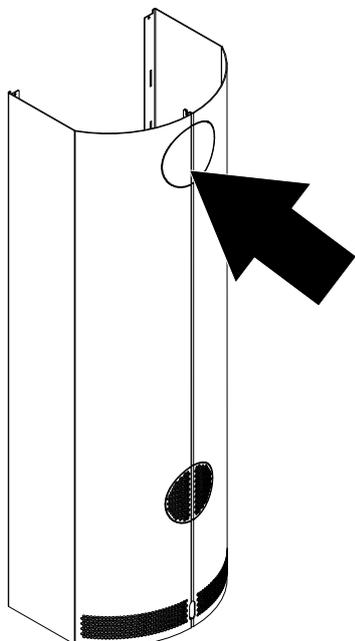
Fig. 10: Rimozione del taglio perforato
