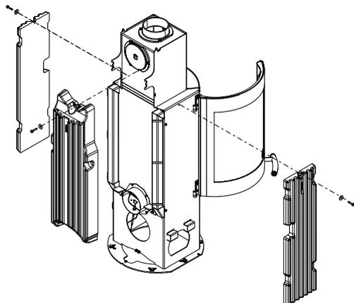
Fig. 15: Montaggio delle pietre HMS
