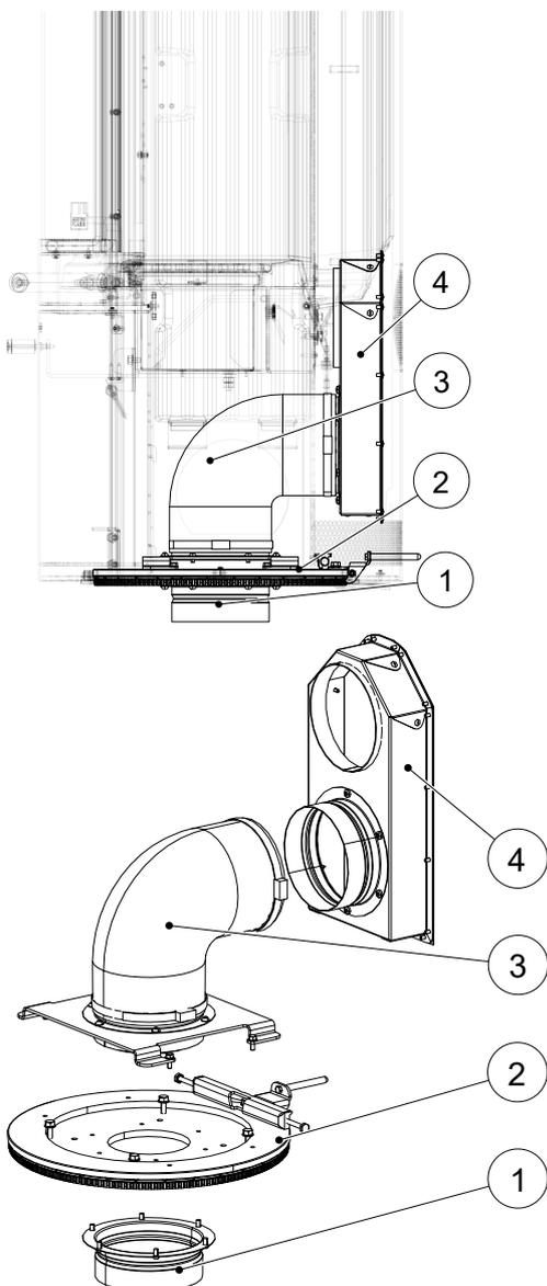
Fig. 25: Montaggio della connessione dell'aria esterna nella parte inferiore
