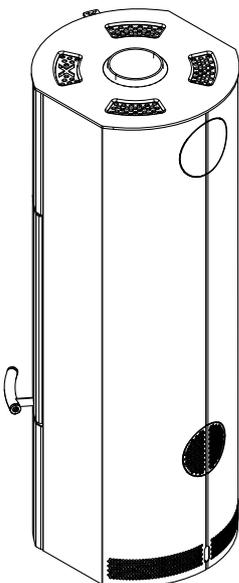
Fig. 14: Montaggio del rivestimento laterale e posizionamento del coperchio
