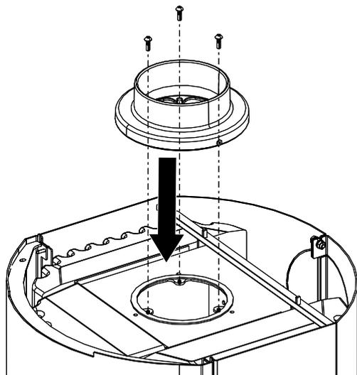
Fig. 23: Montaggio del giunto girevole
