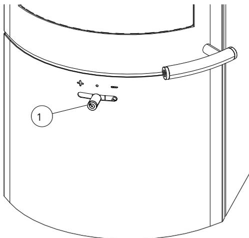
Fig. 27: Regolatore dell'aria primaria/secondaria
