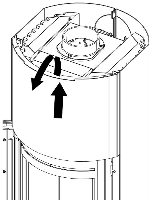
Fig. 38: Rimozione della copertura superiore
