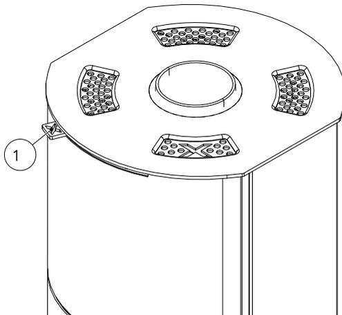
Fig. 34: Regolatore della convezione dell'aria
