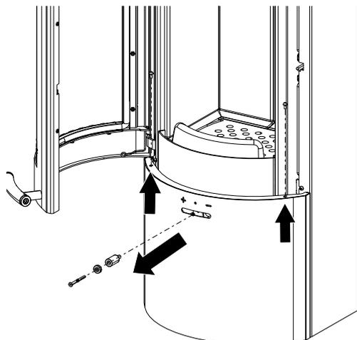
Fig. 39: Rimozione della copertura inferiore
