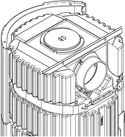
Fig. 13: Coperchio e pezzo di collegamento sostituiti
