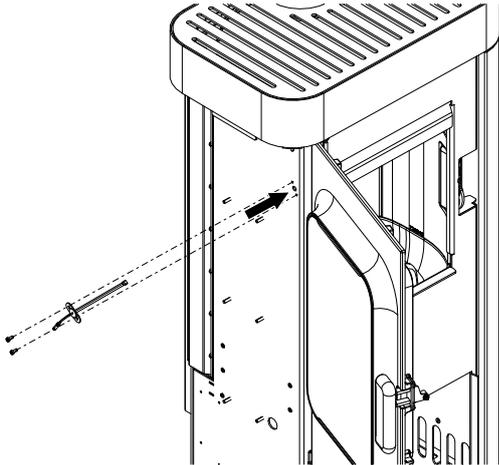
Abb. 23: Feuerraumtemperaturfühler befestigen
