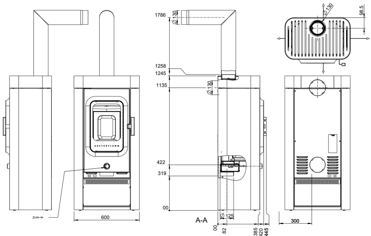
Abb. 2: Abmessungen Grundgerät
