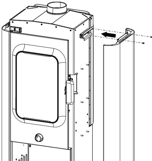
Abb. 6: Seitenverkleidung an Halterung befestigen
