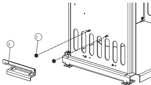
Abb. 26: Halterung montieren
