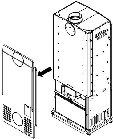
Abb. 9: Rückwand demontieren
