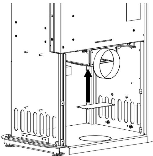
Abb. 19: Luftanschluss hinten
