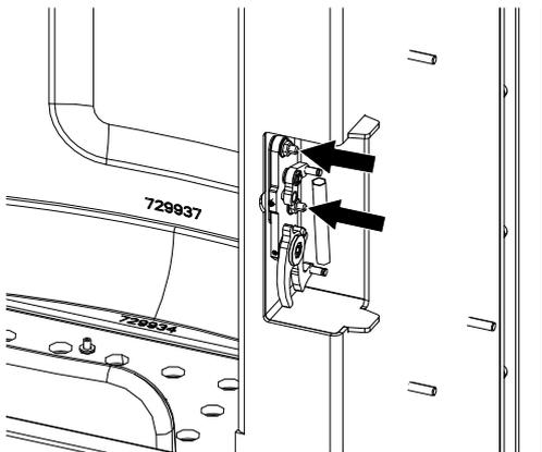
2) Mit den gekennzeichneten Schrauben kann der Türverschluss nach oben, unten, vorne und zurück eingestellt werden.
