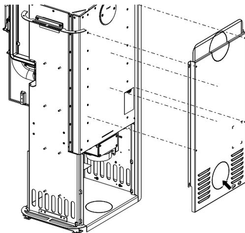
Abb. 15: Rückwand demontieren und den perforierten Ausschnitt entfernen
