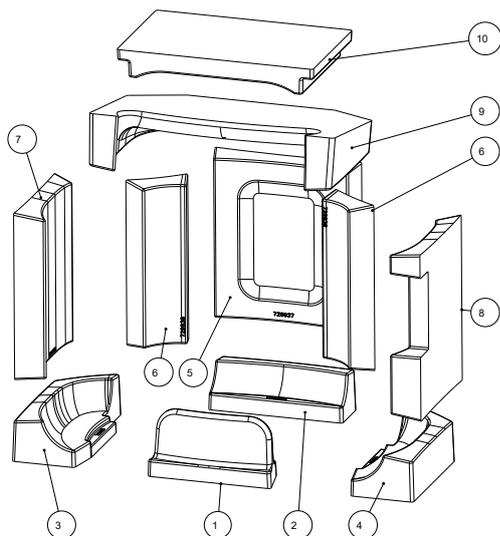
Abb. 37: Keramott Einbaureihenfolge
