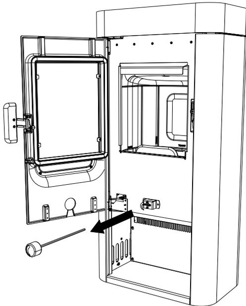
Abb. 20: Drehreglereinheit ausbauen
