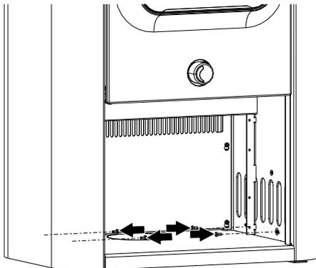
Abb. 7: Seitenverkleidung unten innen befestigen
