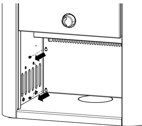
Abb. 34: Sockelblende demontieren
