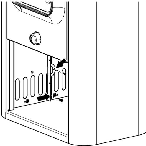
Abb. 35: Sockelblendehalterung montieren
