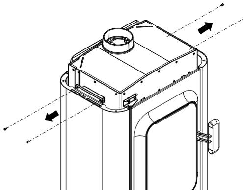
Abb. 51: Schrauben li + re lösen
