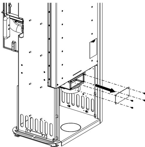
Abb. 16: hinteren Deckel demontieren
