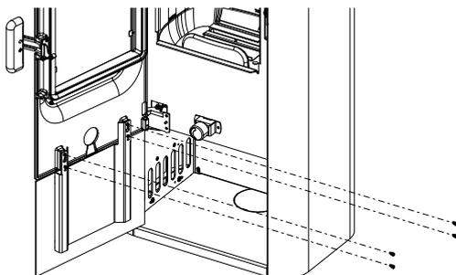
Abb. 33: Sockeltür montieren
