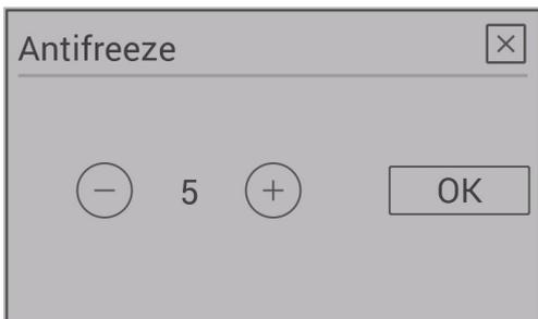
Le menu Protection antigel sert au démarrage automatique du poêle à une température donnée. Ce menu ne fonctionne que lorsque la fonction Programmation horaire est activée (dans le menu Programmation horaire).
