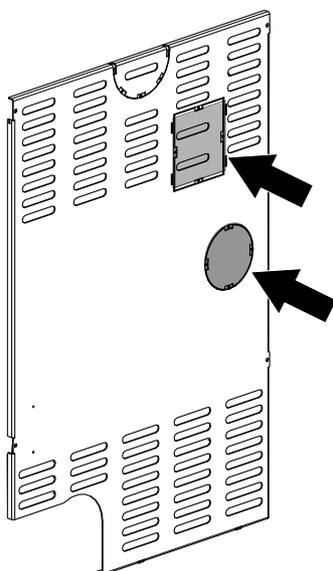
Fig. 80: Rimozione della parte perforata
