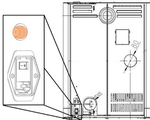
La stufa è dotata nella parte posteriore di un limitatore di temperatura di sicurezza (1)
