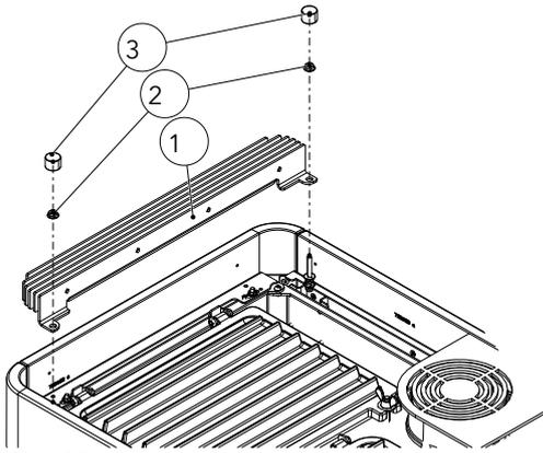
Fig. 69: Montaggio delle alette di convezione a sinistra.
