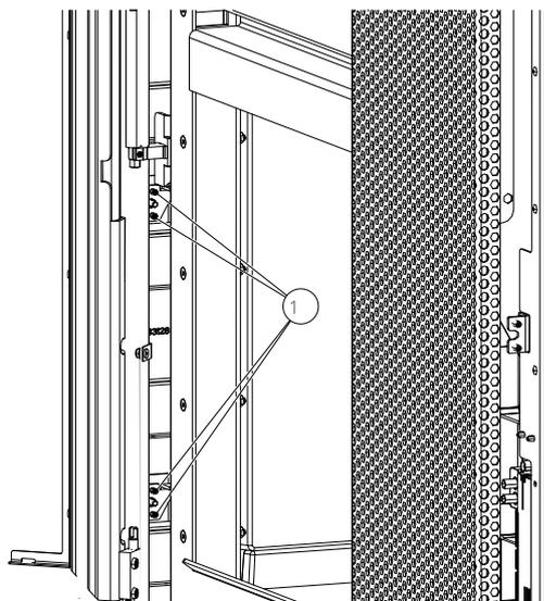
Fig. 57: Allineamento del rivestimento in acciaio
