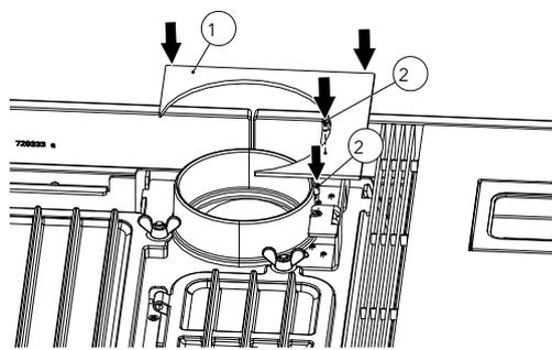
Fig. 67: Montaggio della copertura
