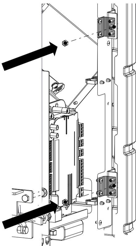
Fig. 32: Fissaggio e allineamento del rivestimento laterale
