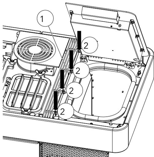
Fig. 66: Montaggio delle alette di convezione sulla destra
