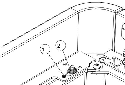
Fig. 52: Allineamento dell'anello superiore
