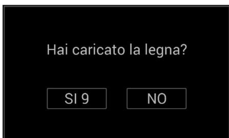
La risposta a questa domanda influisce sull'ulteriore funzionamento della stufa. Appare ogni volta che si chiudono gli sportelli della camera di combustione.
