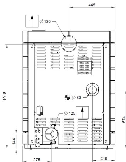
Fig. 83: Collegamento dell'alimentazione esterna di aria comburente
