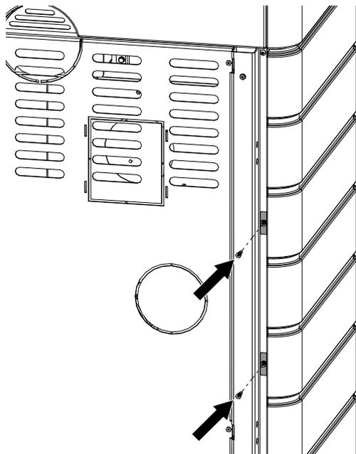
Fig. 26: Fissaggio del rivestimento in ceramica da dietro
