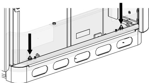
Fig. 15: Montaggio e serraggio dei dadi
