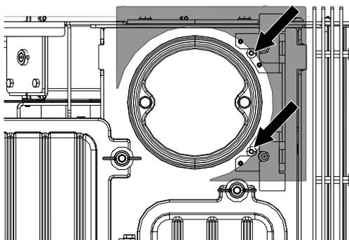
Fig. 20: Svitamento delle viti e rimozione della copertura
