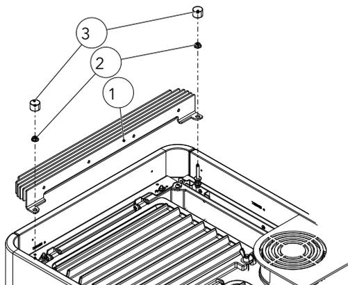
Fig. 40: Montaggio delle alette di convezione a sinistra.
