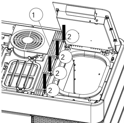
Fig. 38: Montaggio delle alette di convezione sulla destra
