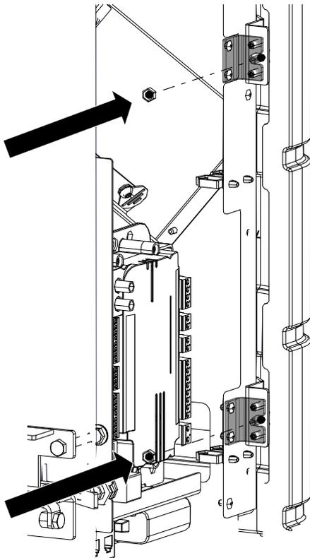
Fig. 60: Fissaggio e allineamento del rivestimento laterale
