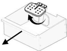
Fig. 99: Rimozione del vassoio per la cenere
