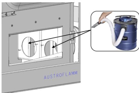
Fig. 137: Pulizia dei passaggi dei gas di scarico
