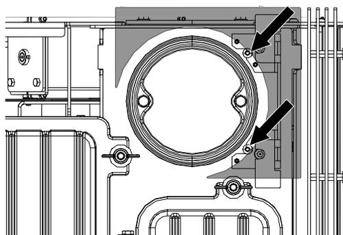
Fig. 49: Svitamento delle viti e rimozione della copertura
