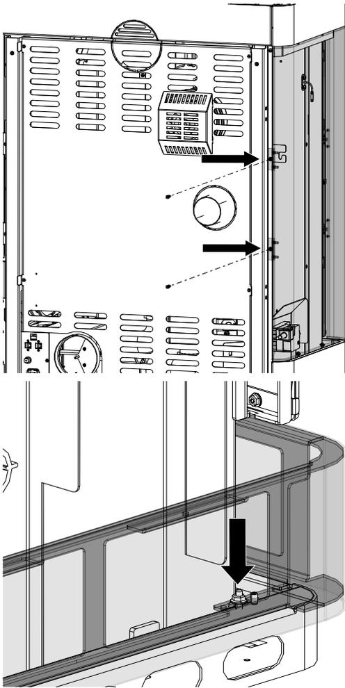
Fig. 55: Fissaggio del rivestimento in acciaio da dietro
