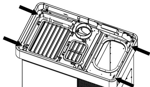
Fig. 23: Allineamento dell'anello superiore
