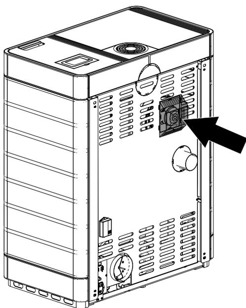
Fig. 82: Fissaggio del coperchio alla parete posteriore
