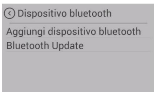
Per la vostra stufa combi è disponibile come opzione il radiotermostato SMART SPOT. Lo SMART SPOT funziona con tecnologia Bluetooth. Per poterlo utilizzare occorre attivarlo una sola volta in questa voce di menu.
