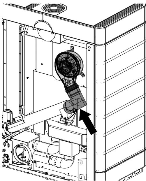
Fig. 79: Collegamento del tubo
