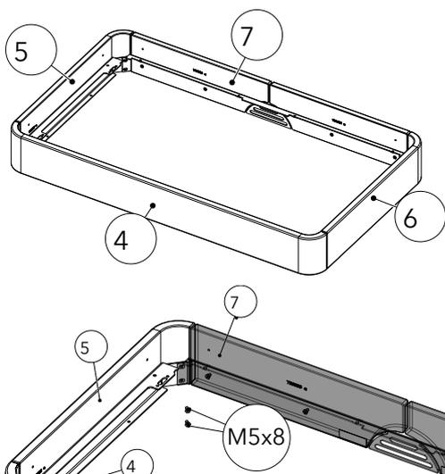
Fig. 17: Montaggio della struttura in ceramica superiore
