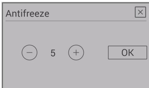
Il menu della protezione antigelo serve all'avvio automatico della stufa a una temperatura determinata. Questo menu funziona solo se è attiva la funzione timer (da impostare nel menu Timer).
