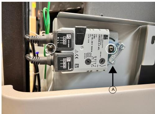
Fig. 16: Smontaggio del motore della griglia ribaltabile
