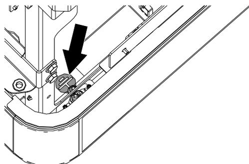
Fig. 78: Collegamento della messa a terra centrale
