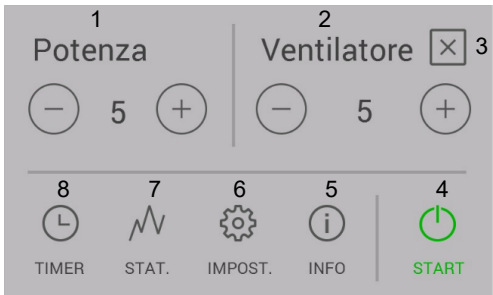
Fig. 100: Indicazione della potenza di riscaldamento
