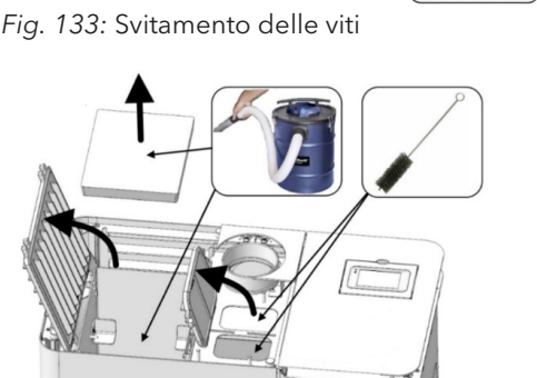
Fig. 134: Pulizia dei passaggi dei gas di scarico
