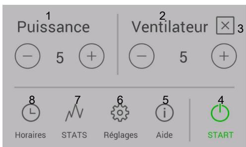
Fig. 57: Affichage de la puissance de chauffage
