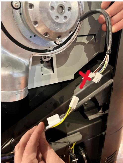
Fig. 35: Raccorder les câbles
