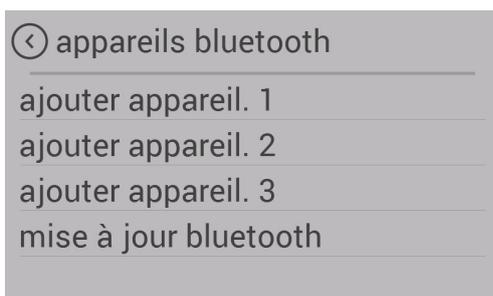
Le SMART SPOT est un capteur de température sans fil disponible en option pour votre poêle à pellets. Celui-ci fonctionne sur la base de la technologie Bluetooth. Pour pouvoir l'utiliser, il suffit de l'activer une unique fois dans ce point de menu.
