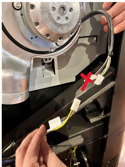
Fig. 20: Raccorder les câbles
