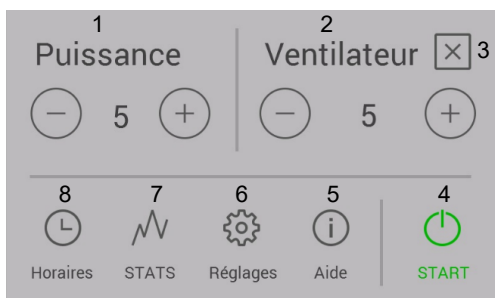
Fig. 45: Affichage de la puissance de chauffage
