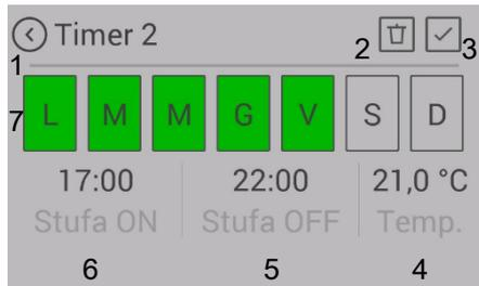
Fig. 59: Predisposizione degli orari di riscaldamento
