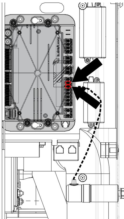
Fig. 23: Collegamento del modulo del diffusore dell'aria
