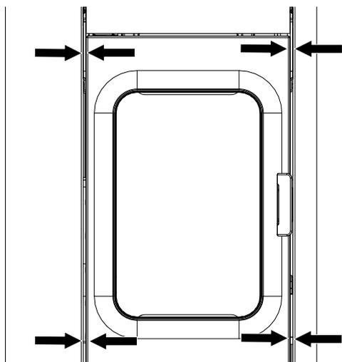
Fig. 42: Regolazione della distanza
