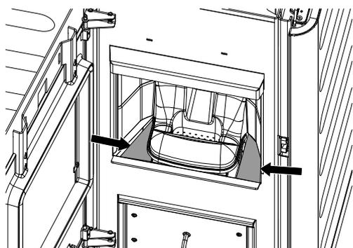
Fig. 90: Pulizia della camera di combustione
