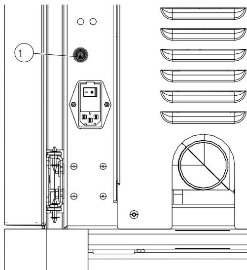
La stufa a pellet è dotata nella parte posteriore di un limitatore di temperatura di sicurezza (1)
