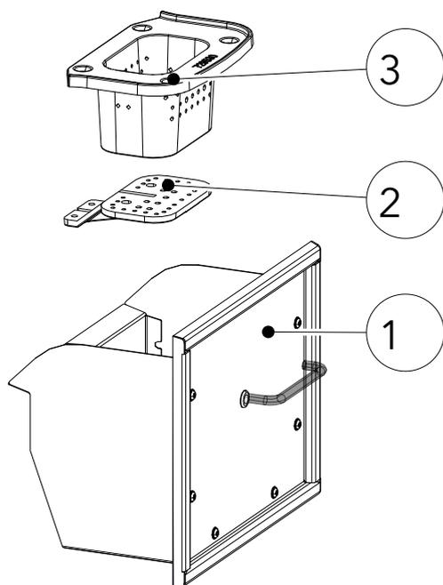
Nel caso di stufa a pellet con griglia ribaltabile automatica (2), ogni volta che la stufa si spegne i resti della combustione rimasti sulla griglia vengono rovesciati nel box cenere (1), che deve essere svuotato quando è pieno. Pulizia solo a stufa a pellet spenta e fredda.
