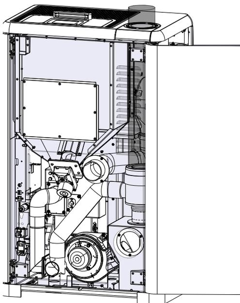
Fig. 14: Collegamento del tubo dei gas di scarico
