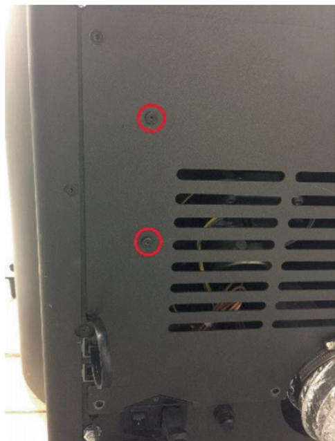
1) Sulla parete posteriore della stufa sono stati predisposti 2 fori sul lato destro con viti ISK (a esagono incassato) M4 x 8 per il montaggio del WiRCU-Box. Queste viti devono essere svitare con una chiave a brugola da 2 mm prima dell'installazione.
