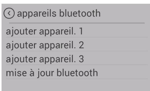
Le SMART SPOT est un capteur de température ambiante sans fil disponible en option pour votre poêle à pellets. Celui-ci fonctionne sur la base de la technologie Bluetooth. Pour pouvoir l'utiliser, il suffit de l'activer une unique fois dans ce point de menu.
