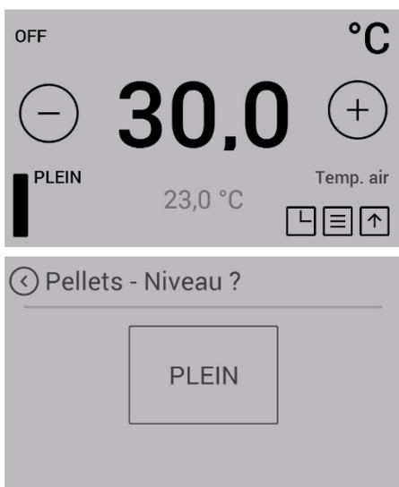
Cet indicateur vous informe sur le niveau de remplissage du réservoir à pellets. Une alarme s'affiche à l'écran lorsque le niveau de remplissage tombe sous un seuil déterminé. L'indicateur doit être mis à jour manuellement à chaque remplissage.
