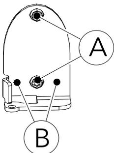
Fig. 60: Viti di regolazione dello sportello
