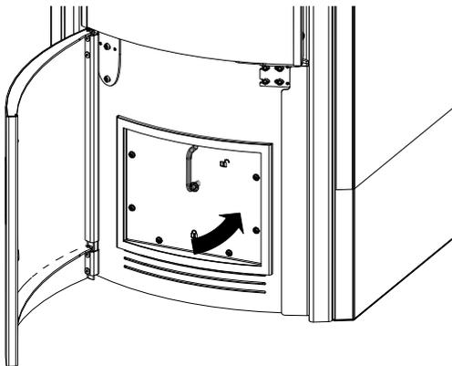
Fig. 74: Rotazione della leva verso l'alto
