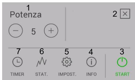
Fig. 33: Indicazione della potenza di riscaldamento
