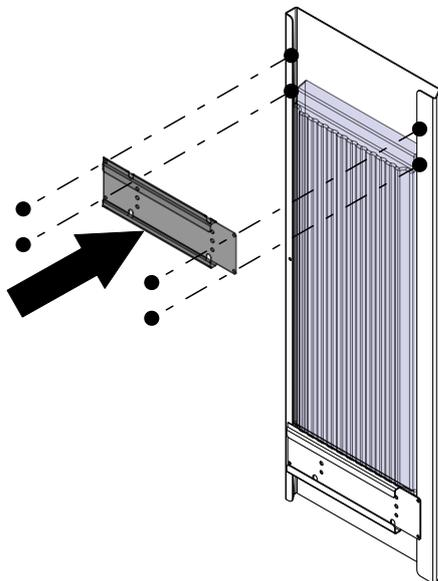
Fig. 15: Montaggio della pietra HMS sulla parte laterale
