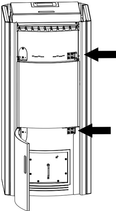
5) Le cerniere dello sportello possono essere regolate tramite 2 spine filettate (B) e i fori longitudinali (A). Più si avvitano le spine (B), più lo sportello si allontana dalla camera di combustione. Lo sportello può essere spostato verso sinistra e verso destra mediante i fori longitudinali (A).
