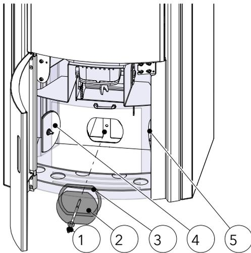
Fig. 76: Rimozione dell'anello di ispezione
