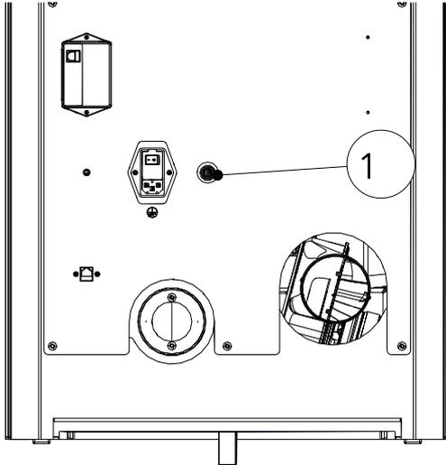
La stufa a pellet è dotata nella parte posteriore di un limitatore di temperatura di sicurezza (1)
