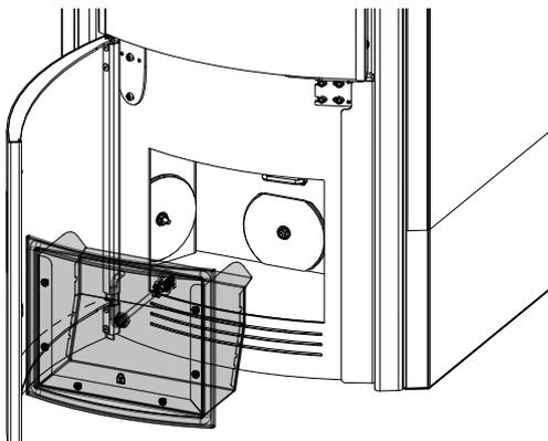
Fig. 75: Rimozione del box cenere
