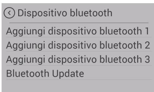
La stufa a pellet dispone quale opzione di un sensore di temperatura ambiente senza cavo SMART SPOT. Lo SMART SPOT funziona con tecnologia Bluetooth. Per poterlo utilizzare occorre attivarlo una sola volta in questa voce di menu.
