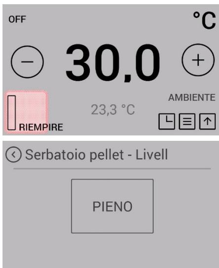
L'indicazione di livello offre informazioni sullo stato di riempimento del serbatoio dei pellet. Quando il livello scende al di sotto di un certo livello, sul display viene visualizzato un avviso. L'indicatore di livello deve essere aggiornato manualmente dopo ogni riempimento.
