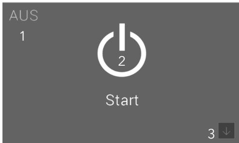
Premendo il tasto Avvio/Arresto per più di 2 secondi si accende o si spegne la stufa.
