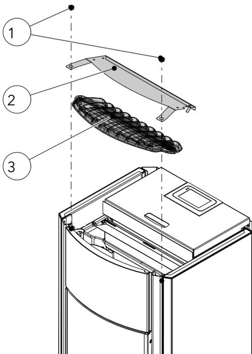
Fig. 71: Rimozione della lamiera anti-irradia-mento e del coperchio in fusione
