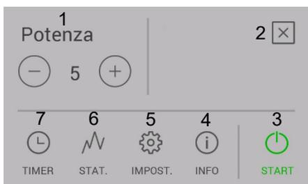
Fig. 39: Indicazione della potenza di riscaldamento
