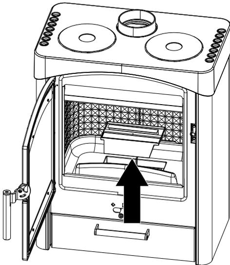
Abb. 38: Aschebox rausnehmen und entleeren
