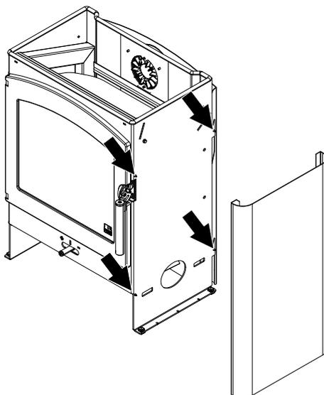
Abb. 11: Seitenverkleidung montieren
