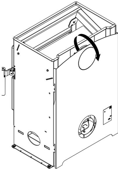
Abb. 9: Rückwand nach oben heben und entfernen
