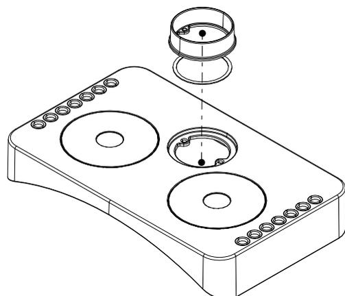
Abb. 23: Stutzen und Dichtung vom Deckel demontieren
