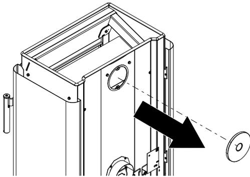
Abb. 24: Abdeckung demontieren
