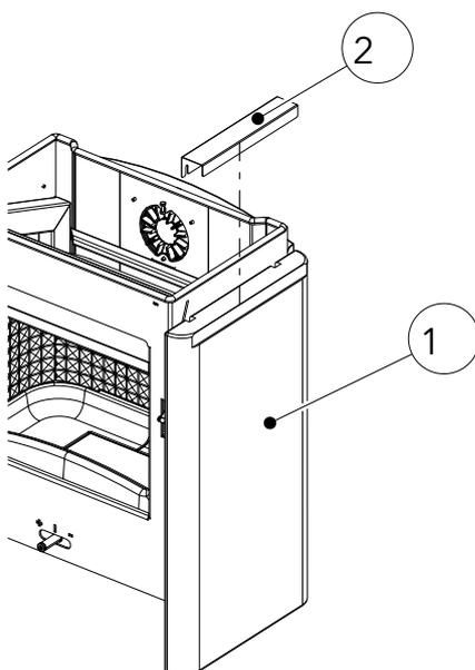
Abb. 15: Specksteinseitenverkleidung einhängen
