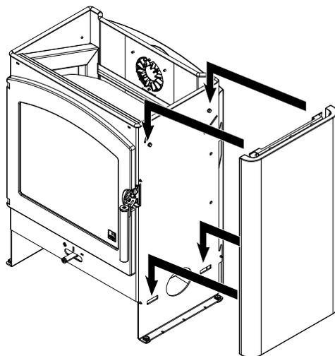
Abb. 13: Keramikseitenverkleidung einhängen
