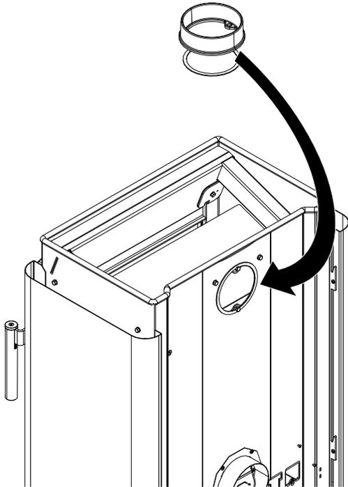
Abb. 25: Stützen hinten montieren
