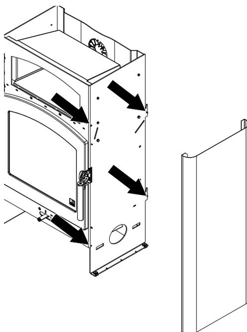
Fig. 10: Montaggio del rivestimento laterale
