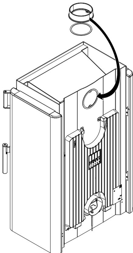
Fig. 25: Montaggio del pezzo di collegamento posteriormente
