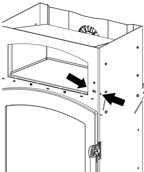
Fig. 9: Rimozione delle viti preassemblate
