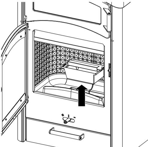
Fig. 38: Rimozione e svuotamento del box cenere
