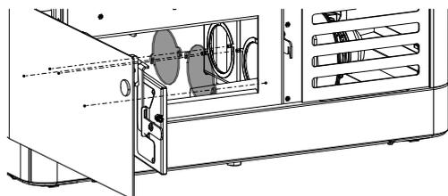
Fig. 98: Déposer les recouvrements
