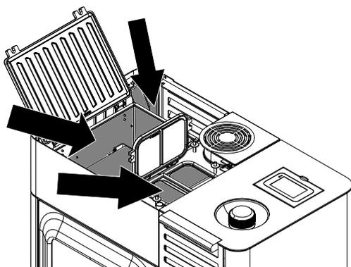
Fig. 94: Nettoyer le circuit de fumées en haut
