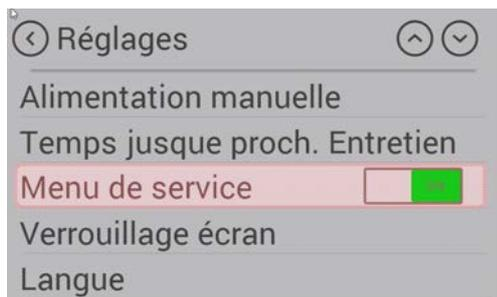
14) Pour activer l'option « Module d'air chaud », sélectionner le menu de service dans les réglages.
