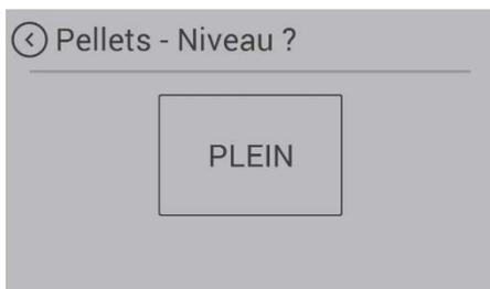
Cet indicateur vous informe sur le niveau de remplissage du réservoir à pellets. Une alarme s'affiche à l'écran lorsque le niveau de remplissage tombe sous un seuil déterminé. L'indicateur doit être mis à jour manuellement à chaque remplissage.
