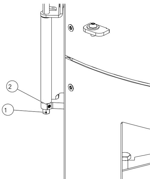
Fig. 79: Régler la force de fermeture de la porte
