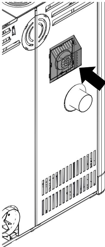
Fig. 31: Mettre le recouvrement sur le panneau arrière
