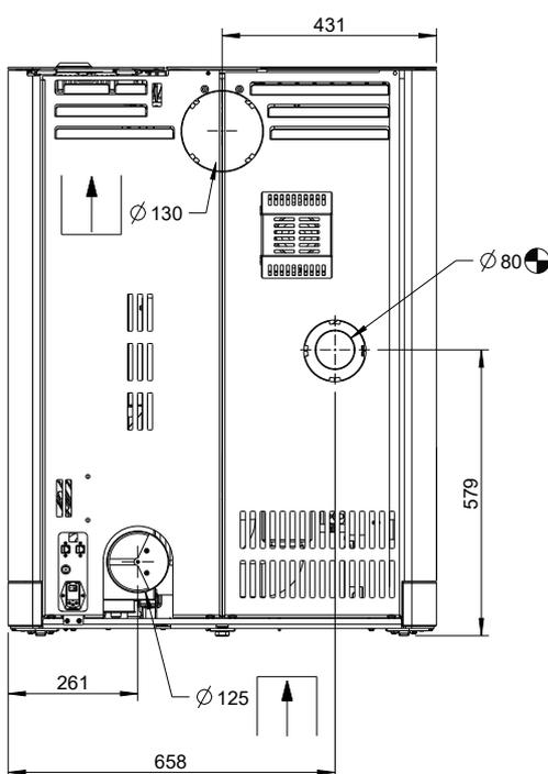
Fig. 32: Raccordement de l'alimentation en air de combustion
