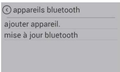
Le SMART SPOT est un capteur de température ambiante sans fil disponible en option pour votre poêle mixte. Celui-ci fonctionne sur la base de la technologie Bluetooth. Pour pouvoir l'utiliser, il suffit de l'activer une unique fois dans ce point de menu.
