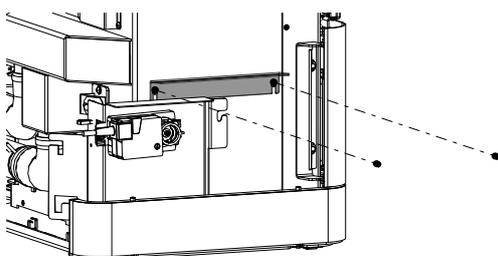
Fig. 14: Installer la fixation HMS latérale
