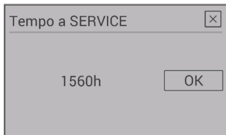
Fig. 83: Intervallo di tempo senza manutenzioni scaduto
