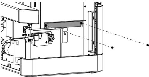
Fig. 47: Montaggio del supporto laterale dell'HMS
