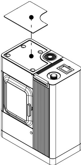
Fig. 17: Rimozione del coperchio dell'area di cottura
