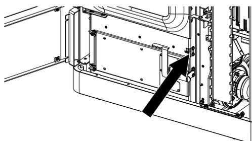
Fig. 98: Regolazione in basso dello sportello sul lato di chiusura
