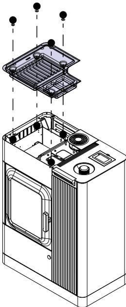
Fig. 112: Rimozione della piastra di cottura
