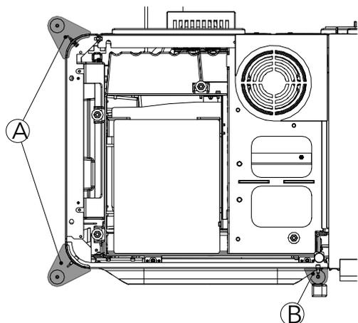
Fig. 14: Montaggio del supporto della barra
