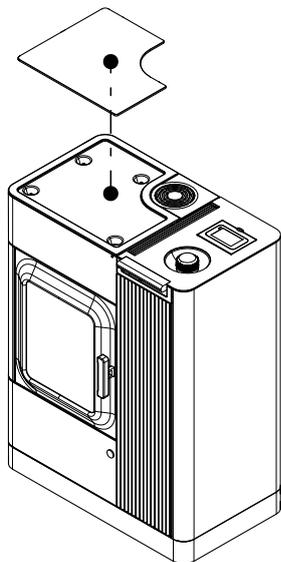
Fig. 9: Rimozione del coperchio dell'area di cottura
