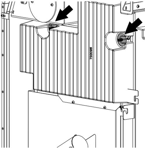
Fig. 46: Montaggio della pietra posteriore dell'HMS
