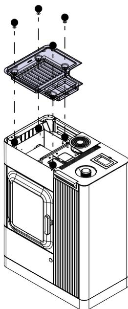
Fig. 10: Rimozione della piastra di cottura
