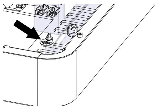
Fig. 38: Collegamento della messa a terra centrale
