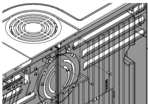
Fig. 127: Rimozione della parete posteriore
