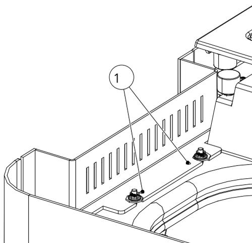
Fig. 103: Regolazione del supporto frontale in alto
