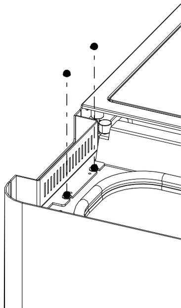
Fig. 26: Fissaggio del supporto frontale in alto
