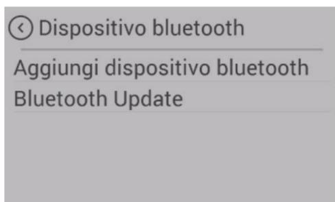
La stufa combi dispone quale opzione di un sensore di temperatura ambiente senza cavo SMART SPOT. Lo SMART SPOT funziona con tecnologia Bluetooth. Per poterlo utilizzare occorre attivarlo una sola volta in questa voce di menu.
