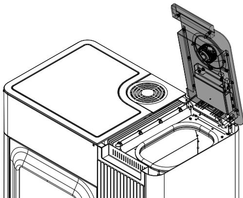
Fig. 123: Aprire il coperchio del contenitore dei pellet.
