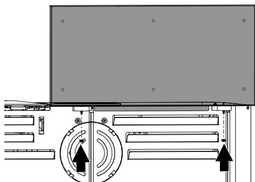
Fig. 20: Montaggio del supporto del pannello a parete
