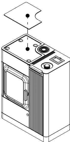
Fig. 111: Rimozione del coperchio dell'area di cottura
