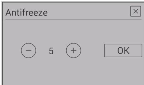
Il menu della protezione antigelo serve all'avvio automatico della stufa a una temperatura determinata. Questo menu funziona solo se è attiva la funzione timer (da impostare nel menu Timer).
