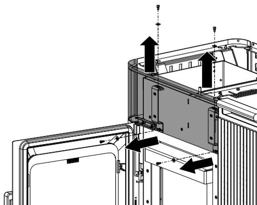
Fig. 11: Smontaggio del pannello anteriore
