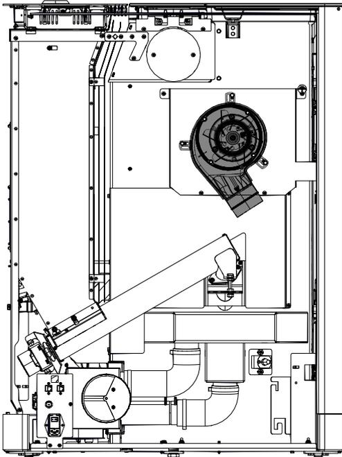
5) Posizionare e fissare alla stufa il modulo del diffusore dell'aria.
