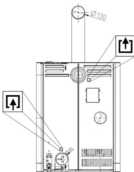
Fig. 49: Collegamento dell'alimentazione esterna di aria comburente
