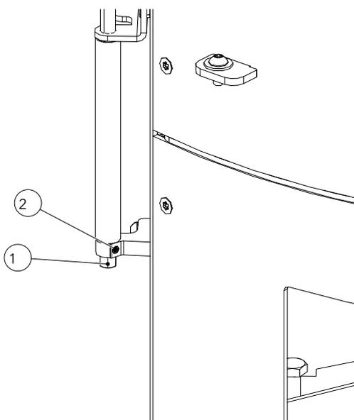
Fig. 95: Regolazione della forza di chiusura dello sportello
