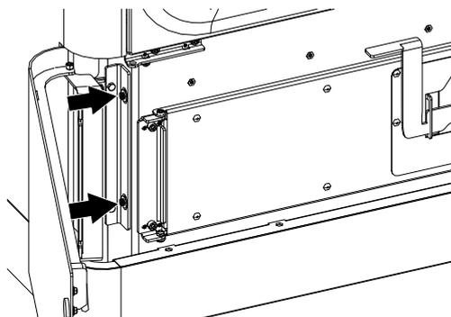
Fig. 97: Regolazione dello sportello inferiore
