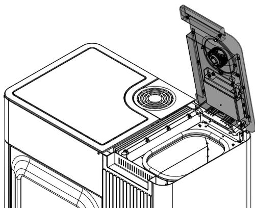
Fig. 29: Aprire il coperchio del contenitore dei pellet.
