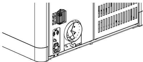
Fig. 126: Togliere la copertura del box WLAN
