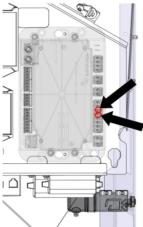
Fig. 37: Collegamento del modulo del diffusore dell'aria
