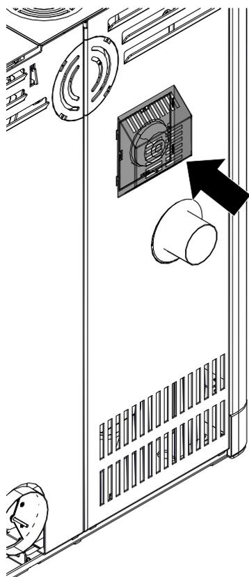
Fig. 42: Fissaggio del coperchio alla parete posteriore
