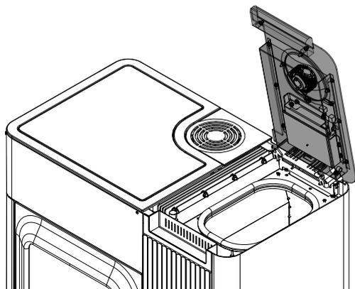
Fig. 121: Aprire il coperchio del contenitore dei pellet.
