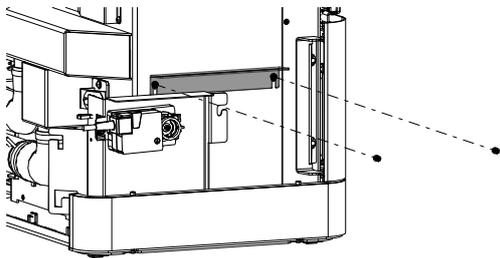
Abb. 48: Seitlichen HMS-Halter montieren
