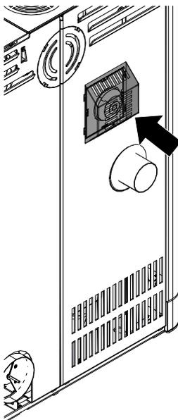
Abb. 43: Abdeckung auf Rückwand anbringen
