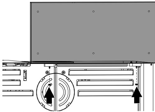
Abb. 21: Boardwandträger montieren
