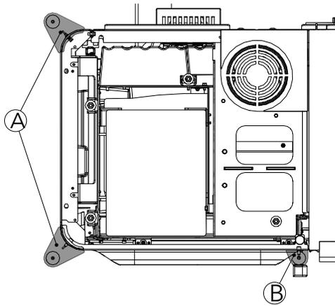
Abb. 15: Railingträger montieren
