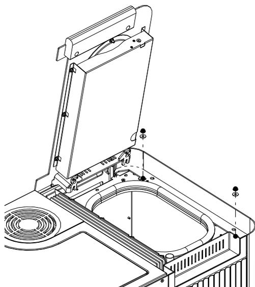
Abb. 126: Seitenverkleidung rechts abnehmen
