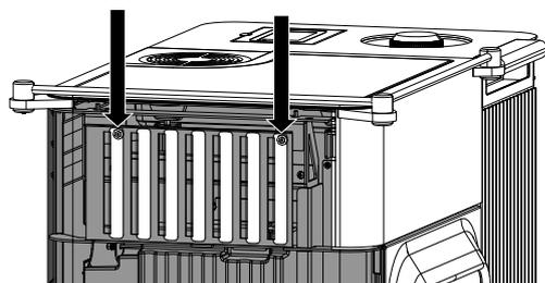
Abb. 125: Seitenverkleidung links abnehmen
