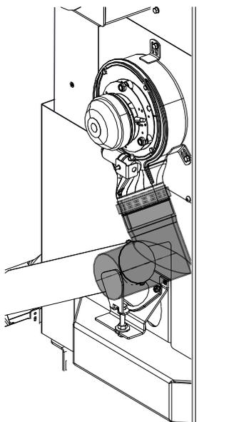
Abb. 40: Rohr raufstecken
