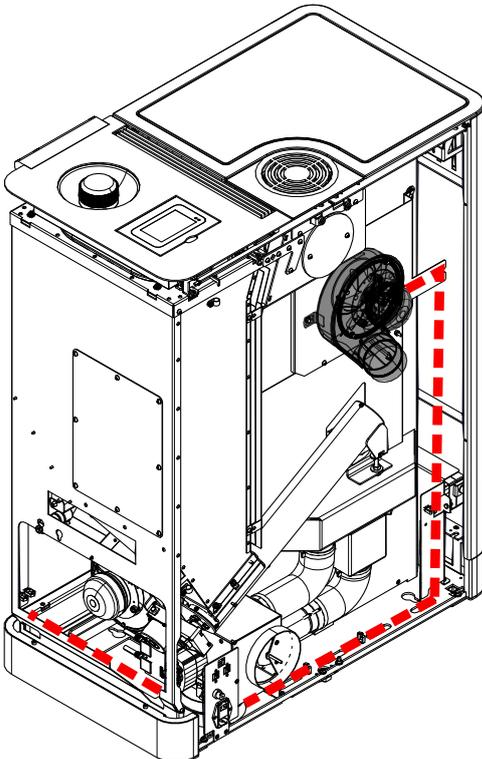
Abb. 36: Kabel verlegen
