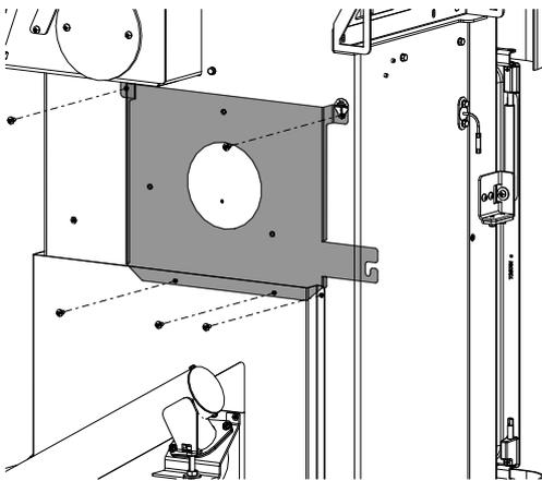
Abb. 45: Blech entfernen
