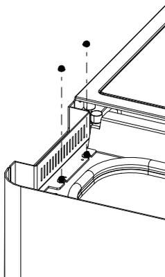
Abb. 27: Fronträger oben befestigen
