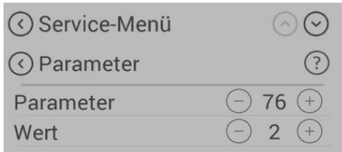
19) Wählen Sie im Service-Menü „Parameter“ und wechseln Sie bei Parameter Nr. „76“ den Wert von 1 auf 2.
