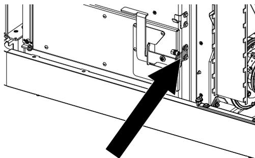
Fig. 77: Réglage de la porte du tiroir à cendres au niveau de la serrure
