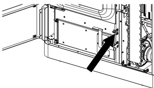
Fig. 80: Régler la porte du bas au niveau de la serrure
