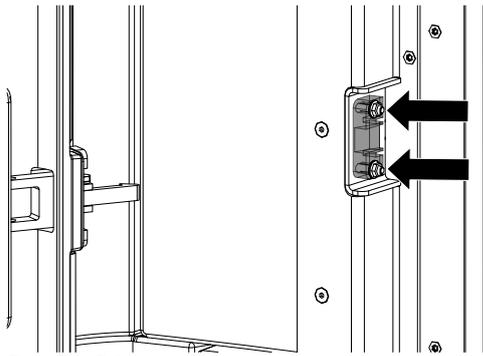
Fig. 72: Réglage au niveau de la serrure
