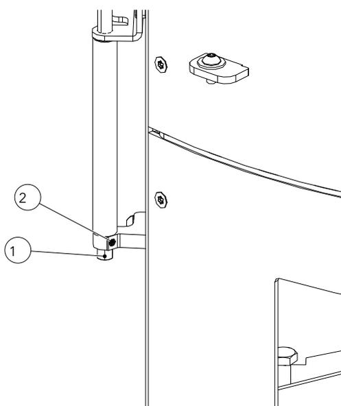
Fig. 74: Régler la force de fermeture de la porte
