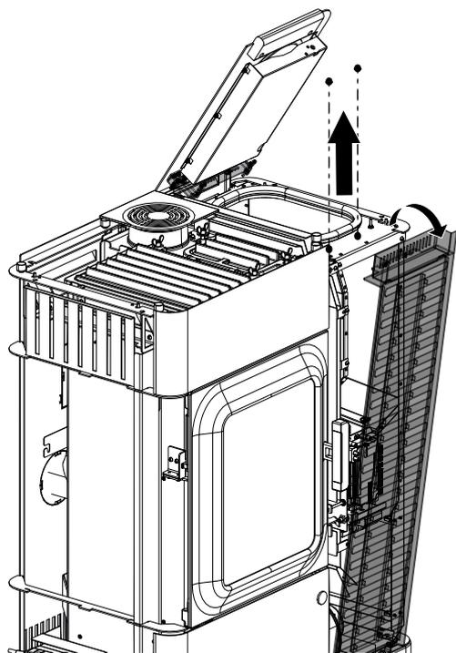
Fig. 100: Déposer l'habillage latéral avant
