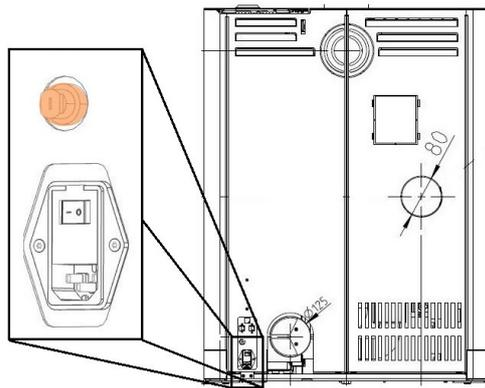
Votre poêle est équipé au dos d'un limiteur de température de sécurité (1).
