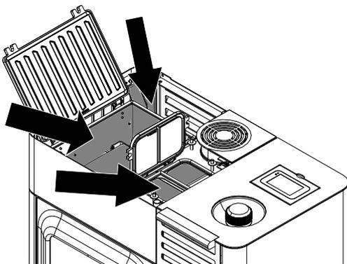
Fig. 89: Nettoyer le circuit de fumées en haut
