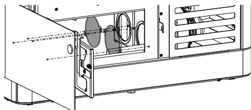
Fig. 93: Déposer les recouvrements
