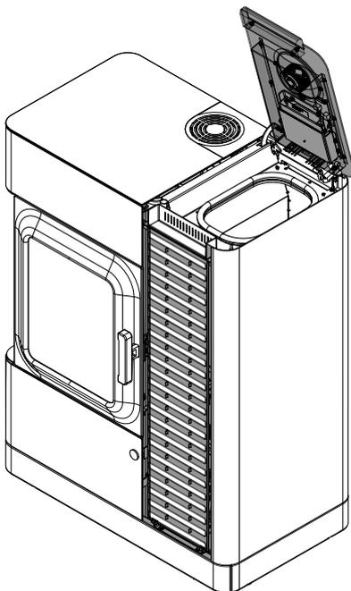
Fig. 68: Déposer le support pour habillage
