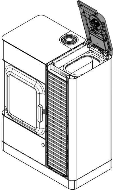
Fig. 35: Remplir les pellets
