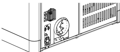
Fig. 102: Enlever le recouvrement de la box WiFi
