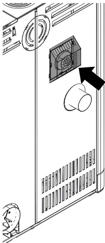
Fig. 25: Mettre le recouvrement sur le panneau arrière
