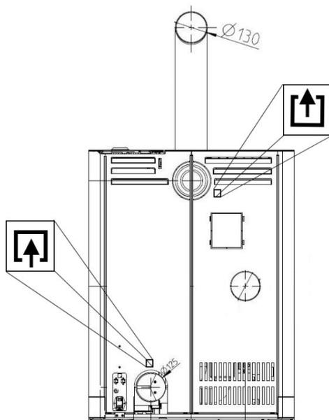
Fig. 26: Raccordement de l'alimentation en air de combustion
