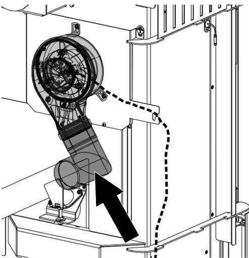
Fig. 22: Mettre le tube sur le kit
