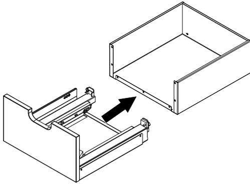
Fig. 22: Rimozione del cassetto di legno dalla guida
