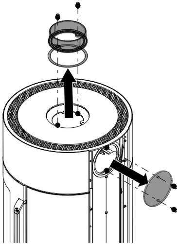
Fig. 13: Smontaggio del coperchio e della presa della canna fumaria
