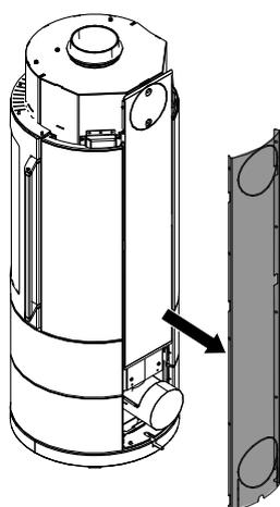
Fig. 31: Rimozione della parete posteriore
