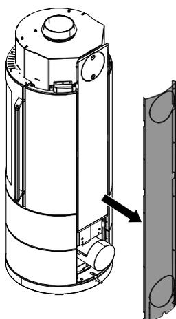
Fig. 38: Rimozione della parete posteriore
