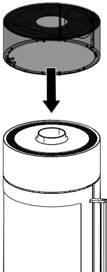
Fig. 19: Montaggio del box portautensili
