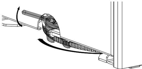
Quando si solleva la leva di comando del piatto girevole, quest'ultimo viene sbloccato ed è quindi possibile ruotare la stufa. Qualora il regolatore si trovi nella posizione più bassa, il bloccaggio si innesta nell'incavo successivo previsto e il piatto girevole è bloccato. A questo punto la stufa non gira più.
