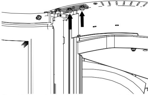
Fig. 43: Regolazione delle cerniere dello sportello
