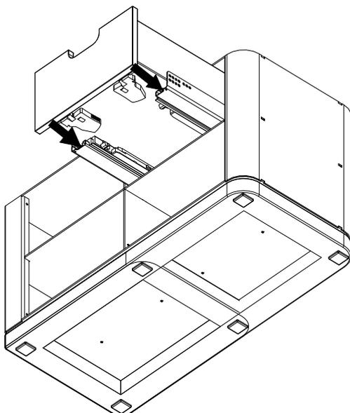
Fig. 24: Inserimento del cassetto di legno nella guida
