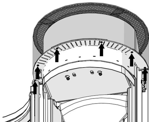
Fig. 30: Rimozione del coperchio
