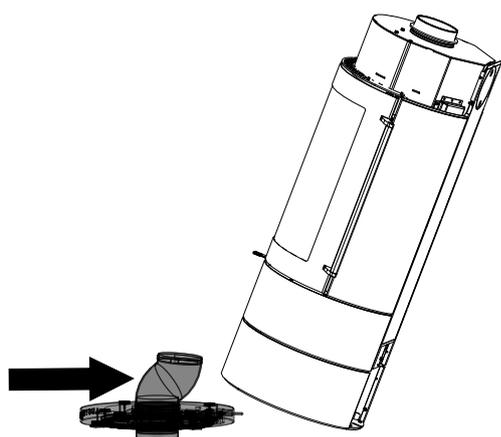
Fig. 35: Inclinamento della stufa
