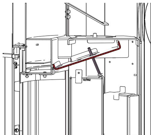
Fig. 61: Rimozione della piastra verso il basso
