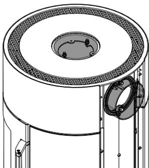
Fig. 15: Copertura e pezzo di collegamento sostituiti
