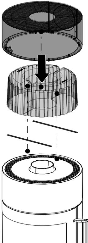
Fig. 18: Montaggio delle pietre HMS
