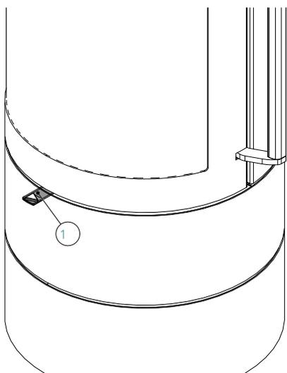
Fig. 45: Regolatore dell'aria primaria/secondaria
