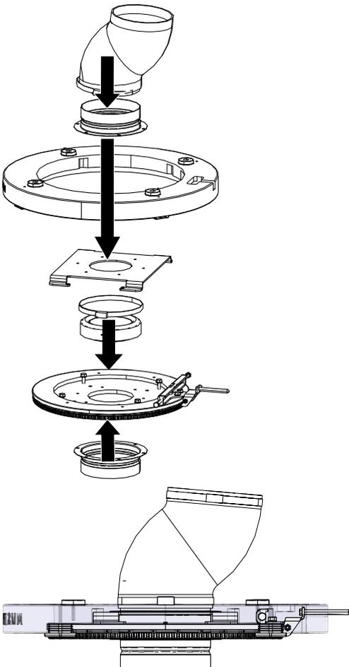
Fig. 34: Assemblaggio della base inferiore con il piatto girevole
