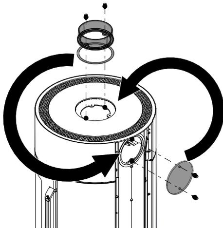
Fig. 14: Sostituzione del coperchio e del pezzo di collegamento
