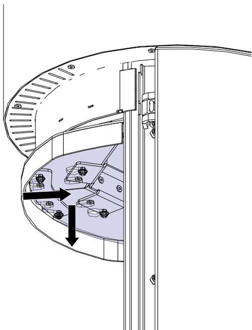
Fig. 58: Rimozione della piastra
