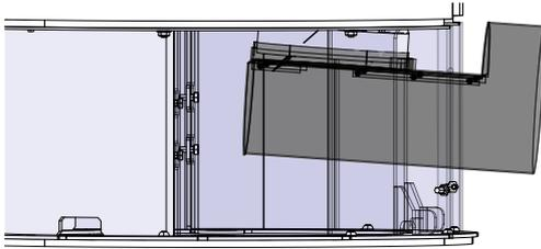
Fig. 28: Montaggio dell'adattatore dell'aria di alimentazione
