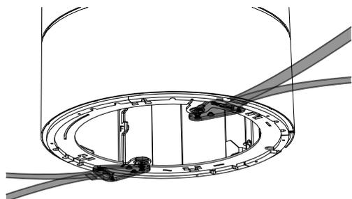
Per trasportare la stufa può essere utilizzato solo un mezzo di trasporto autorizzato e di portata sufficiente. Che deve essere rimosso prima del montaggio.
