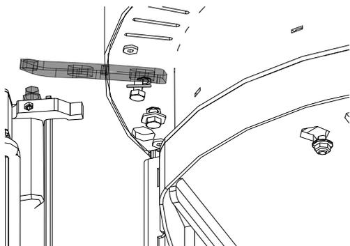
Fig. 57: Rimozione dello sportello dalle cerniere
