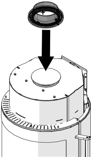
Fig. 33: Montaggio della presa della canna fumaria rotante
