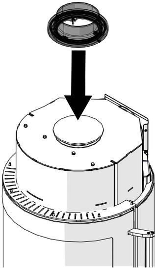
Fig. 40: Montaggio della presa della canna fumaria rotante
