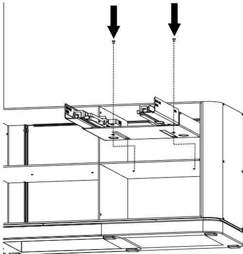
Fig. 23: Montaggio del supporto delle guide
