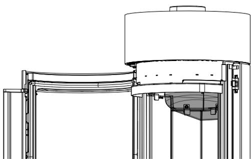
Fig. 59: Rimozione della pietra in Keramott
