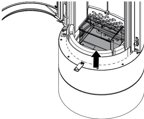
Fig. 53: Rimozione e svuotamento del box cenere
