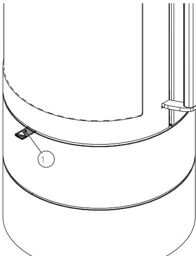
Fig. 44: Regolatore dell'aria primaria/secondaria
