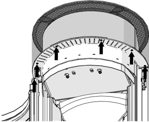
Fig. 29: Rimozione del coperchio
