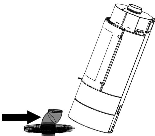
Fig. 34: Inclinamento della stufa
