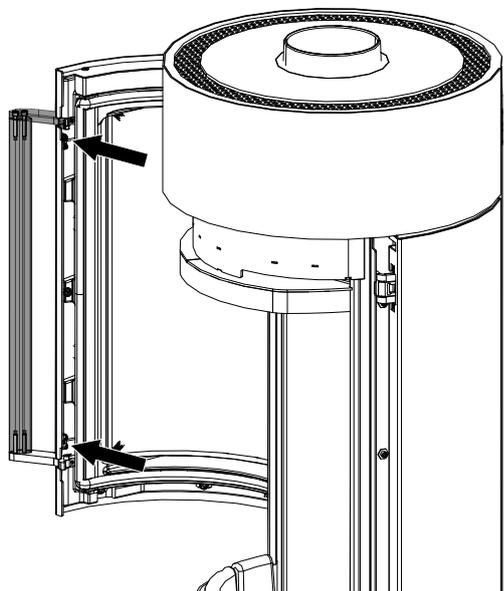
Fig. 43: Regolazione della forza di chiusura della maniglia
