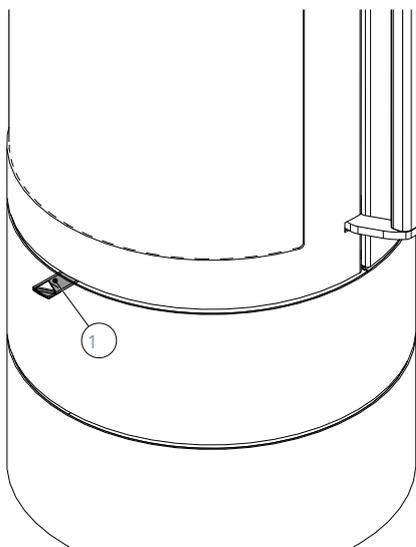
Fig. 4: Regolatore dell'aria primaria/secondaria
