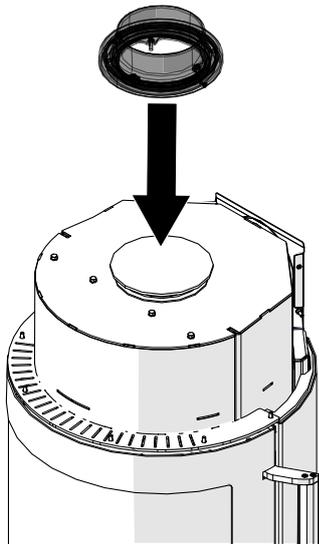
Fig. 32: Montaggio della presa della canna fumaria rotante
