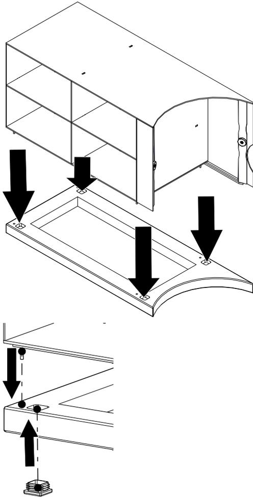
Fig. 19: Montaggio del box laterale
