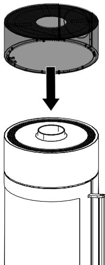
Fig. 18: Montaggio del box portautensili
