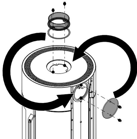
Fig. 13: Sostituzione del coperchio e del pezzo di collegamento
