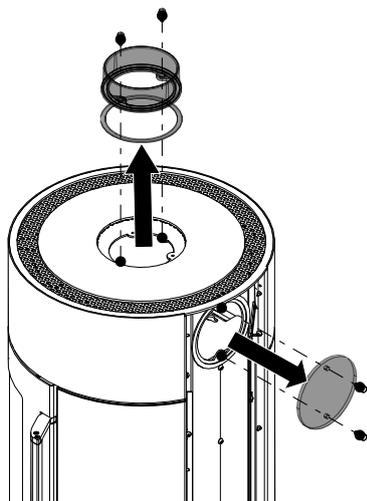
Fig. 12: Smontaggio del coperchio e della presa della canna fumaria
