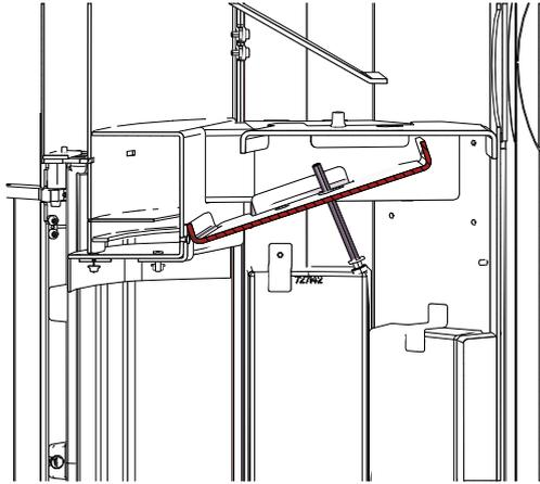
Fig. 60: Rimozione della piastra verso il basso
