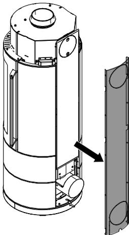
Fig. 30: Rimozione della parete posteriore
