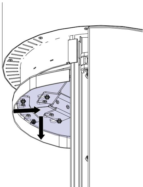
Fig. 57: Rimozione della piastra
