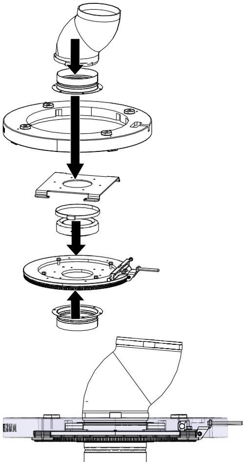
Fig. 33: Assemblaggio della base inferiore con il piatto girevole
