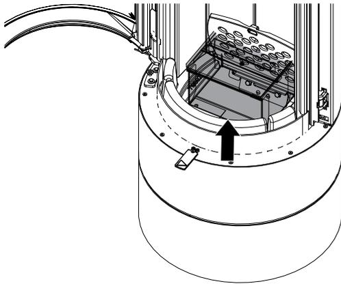
Fig. 52: Rimozione e svuotamento del box cenere
