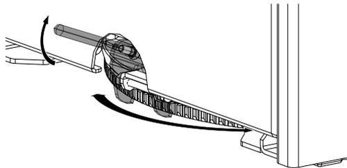
Quando si solleva la leva di comando del piatto girevole, quest'ultimo viene sbloccato ed è quindi possibile ruotare la stufa. Qualora il regolatore si trovi nella posizione più bassa, il bloccaggio si innesta nell'incavo successivo previsto e il piatto girevole è bloccato. A questo punto la stufa non gira più.
