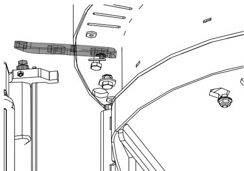
Fig. 56: Rimozione dello sportello dalle cerniere
