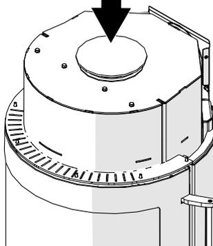
Fig. 39: Montaggio della presa della canna fumaria rotante
