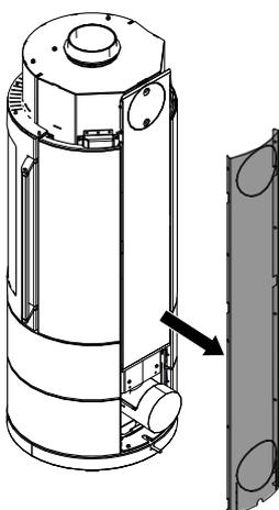
Fig. 37: Rimozione della parete posteriore
