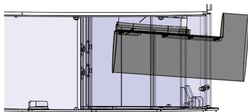
Fig. 27: Montaggio dell'adattatore dell'aria di alimentazione
