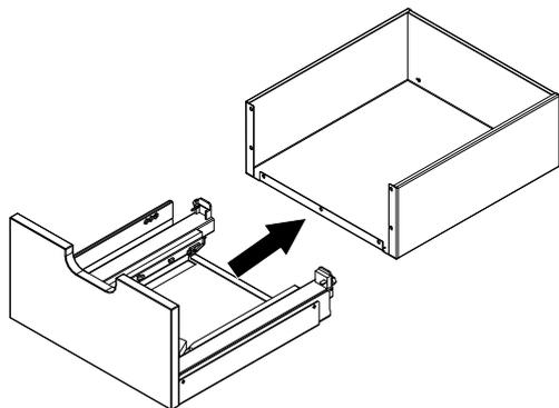
Fig. 21: Rimozione del cassetto di legno dalla guida
