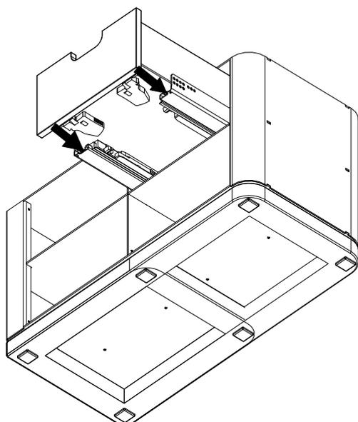
Fig. 23: Inserimento del cassetto di legno nella guida
