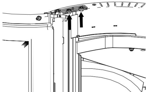
Fig. 42: Regolazione delle cerniere dello sportello
