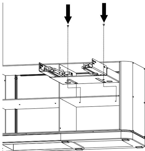
Fig. 22: Montaggio del supporto delle guide
