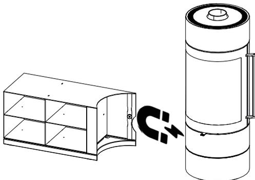
Fig. 20: Collocazione del box laterale presso la stufa
