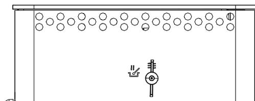
Sélecteur de mode de fonctionnement pour « Chauffage »
