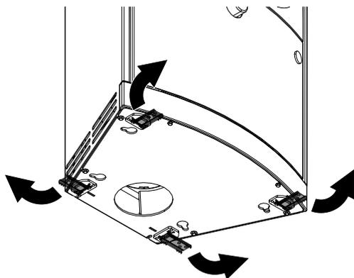
Fig. 5: Rimozione dei fermi di trasporto
