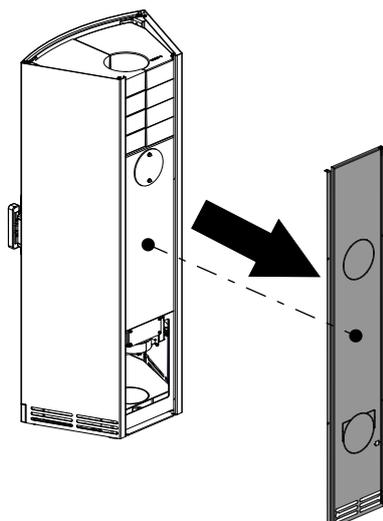
Fig. 33: Svitamento delle viti della parete posteriore
