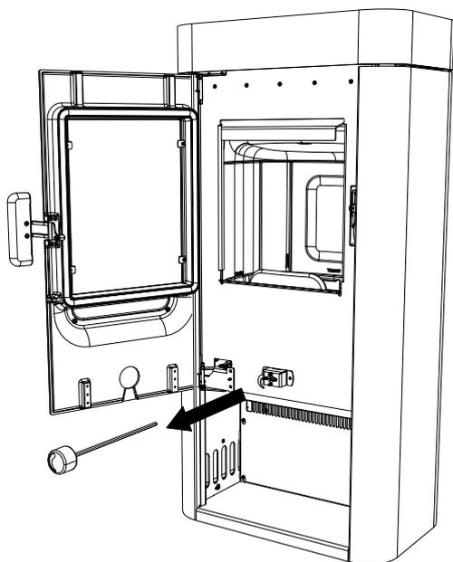
Fig. 14: Rimozione dell'unità del controllo rotativo
