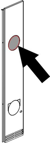
Fig. 7: Rimozione della parte perforata
