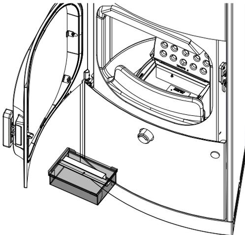
Fig. 30: Rimozione e svuotamento del box cenere
