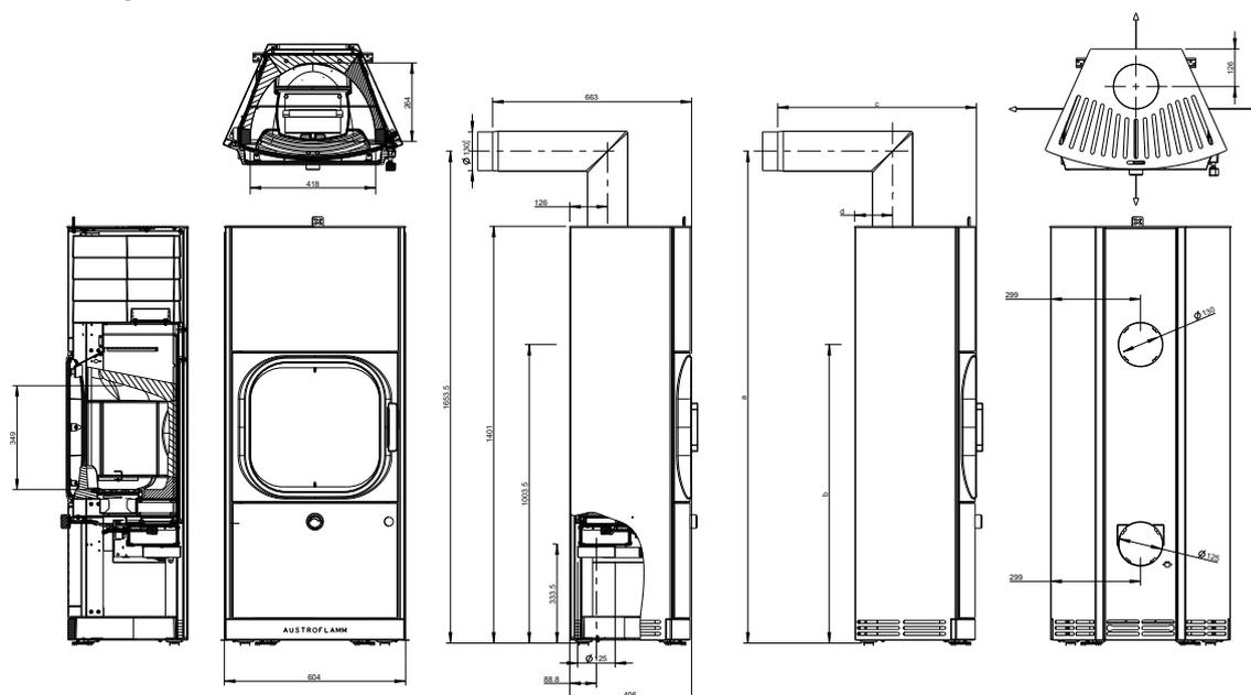
Fig. 1: Dimensioni dell'apparecchio di base
