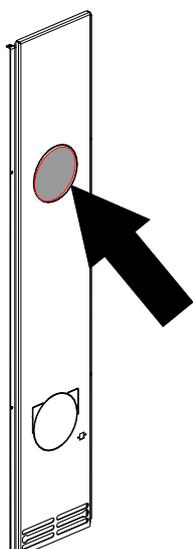
Fig. 9: Rimozione del taglio perforato
