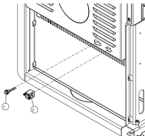
Fig. 20: Montaggio della presa DC e della presa di rete
