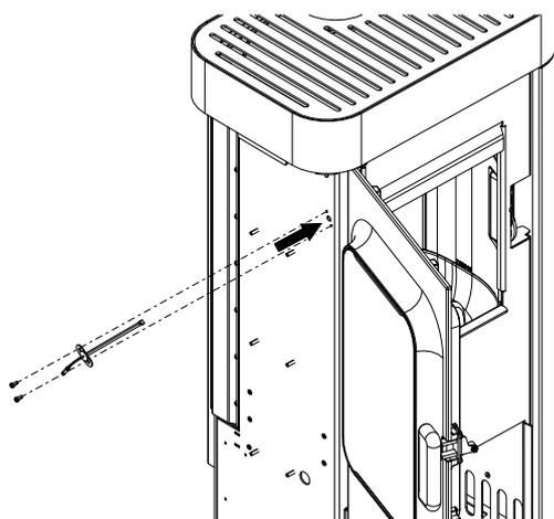
Fig. 19: Fissaggio del sensore di temperatura della camera di combustione
