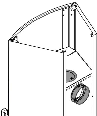
Fig. 13: Coperchio e pezzo di collegamento sostituiti
