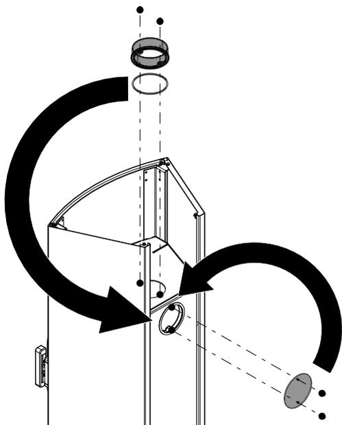
Fig. 12: Sostituzione del coperchio e del pezzo di collegamento
