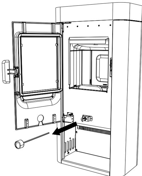
Fig. 16: Rimozione dell'unità del controllo rotativo
