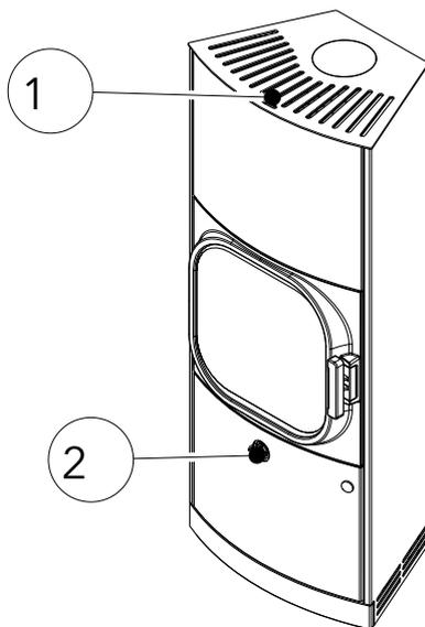
Fig. 25: Regolatore dell'aria primaria/secondaria
