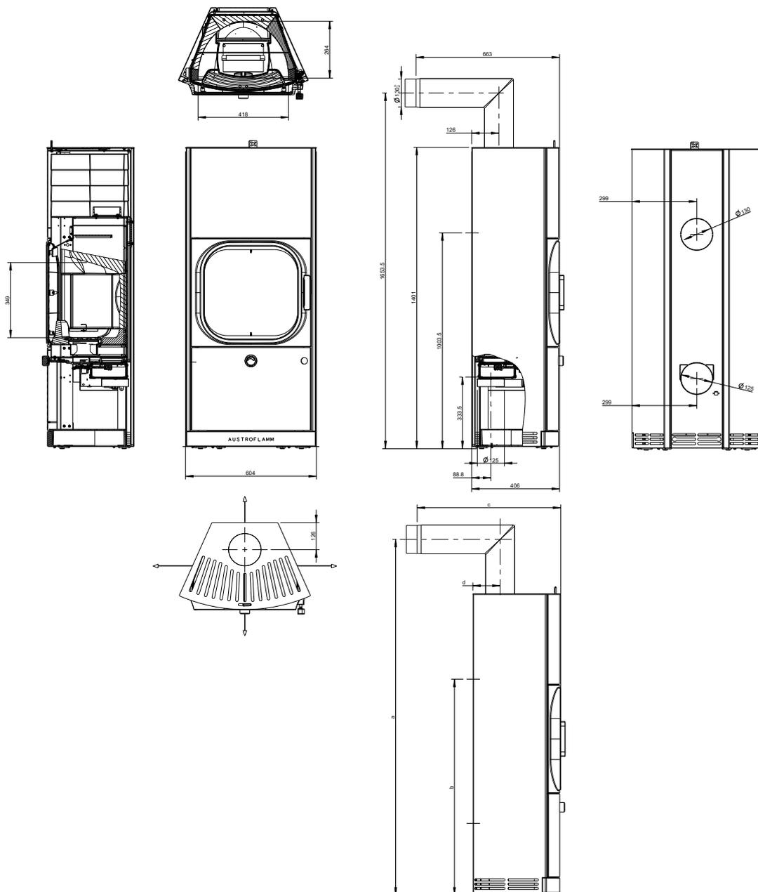
Fig. 2: Dimensioni dell'apparecchio di base
