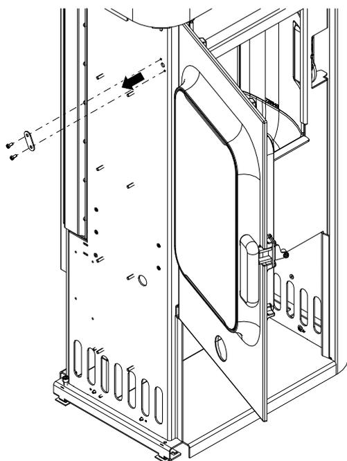
Fig. 17: Rimozione della piastra di copertura
