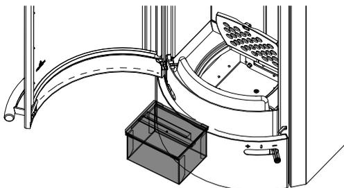
Fig. 32: Rimozione e svuotamento del box cenere
