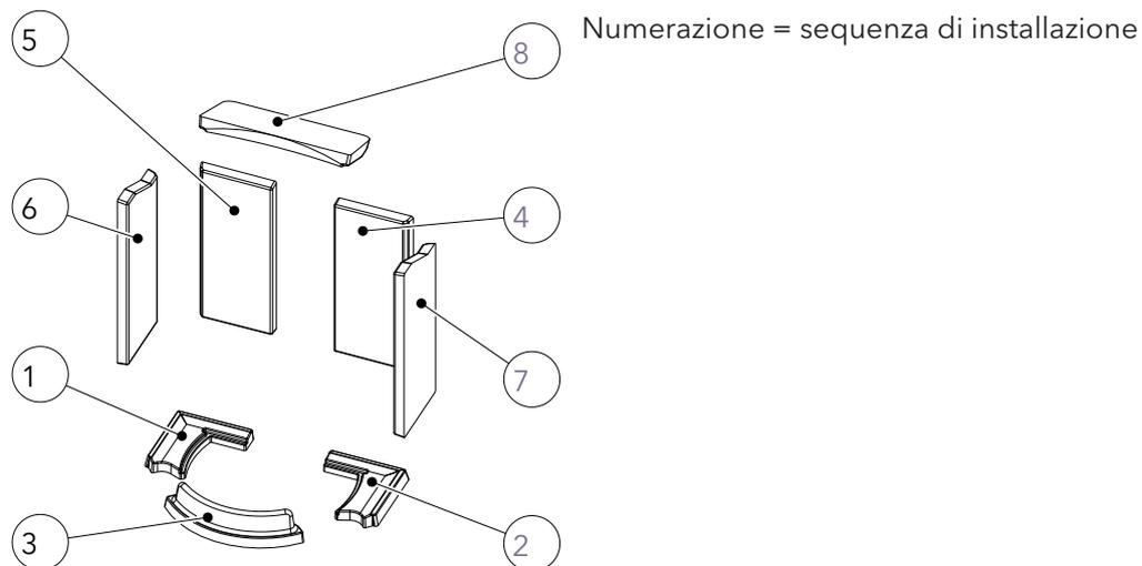
Fig. 16: Installazione del Keramott
