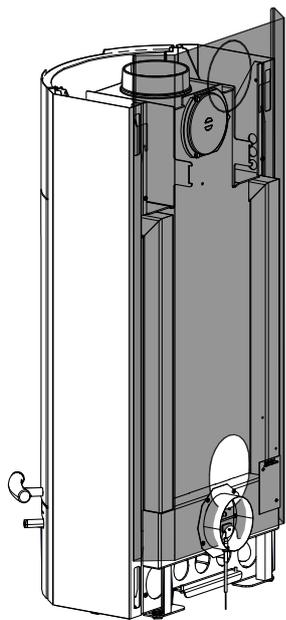
Fig. 10: Rimozione della parte posteriore
