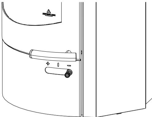
Fig. 26: Regolatore dell'aria primaria/secondaria
