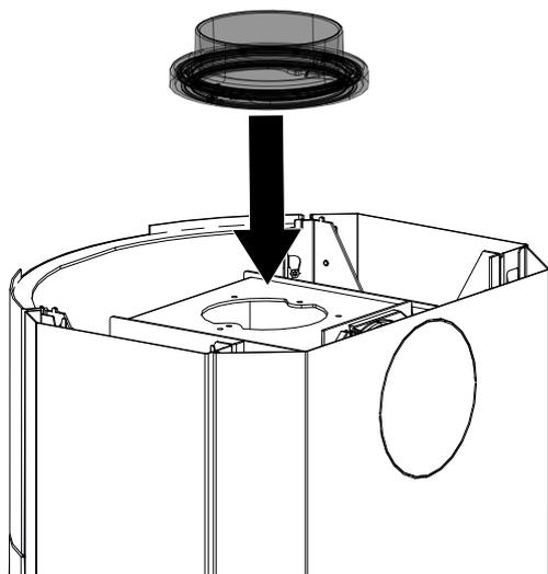
Fig. 20: Montaggio della presa della canna fumaria rotante
