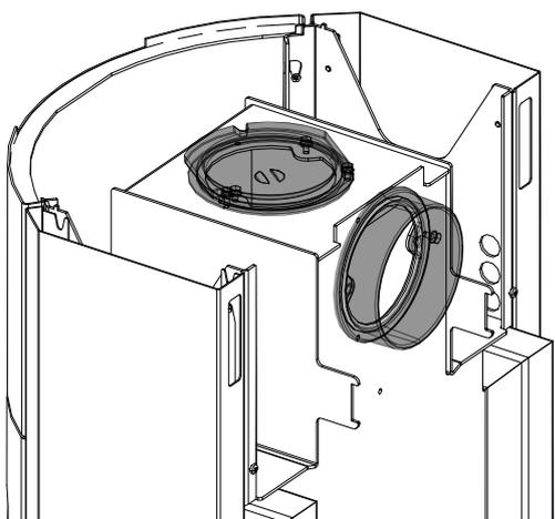
Fig. 14: Copertura e pezzo di collegamento sostituiti
