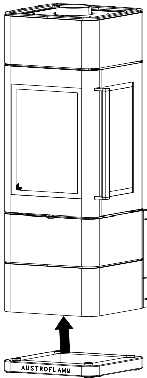
Fig. 14: Rimozione della base in legno
