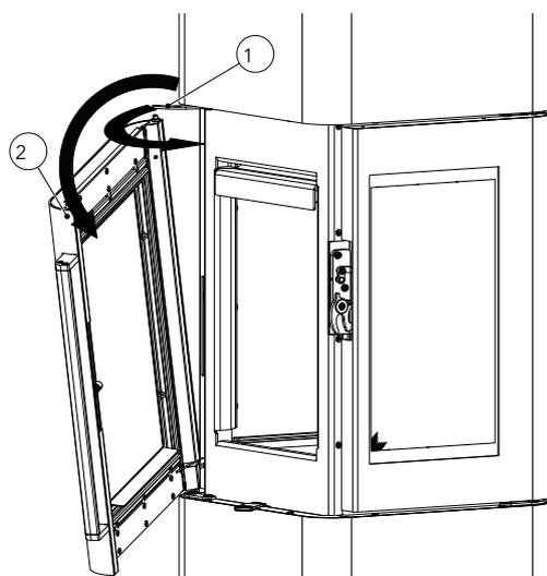
Fig. 43: Rimozione dello sportello
