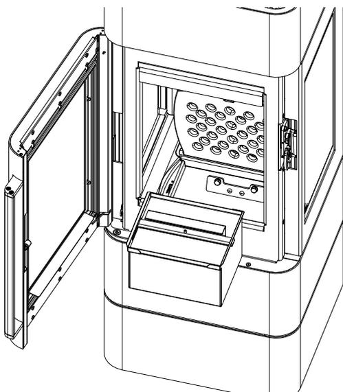
Fig. 39: Rimozione e svuotamento del box cenere
