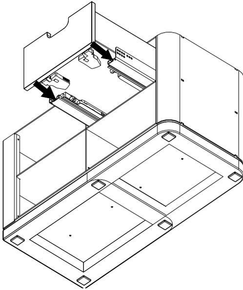
Fig. 22: Inserimento del cassetto di legno nella guida
