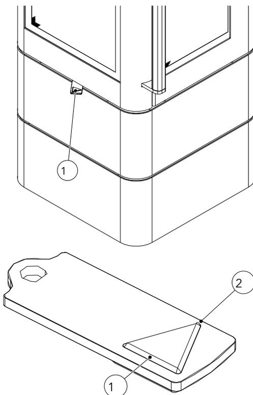
Fig. 32: Regolatore dell'aria primaria/secondaria
