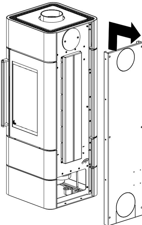
Fig. 41: Rimozione della parete posteriore
