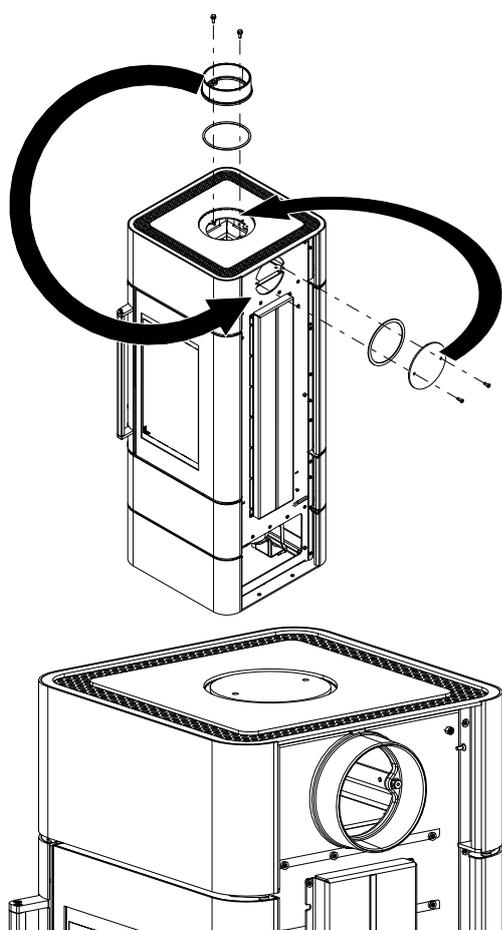
Fig. 11: Sostituzione della copertura e del pezzo di collegamento
