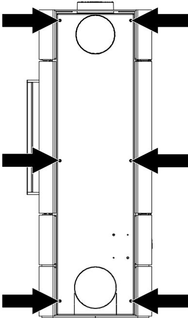
Fig. 40: Svitamento delle viti
