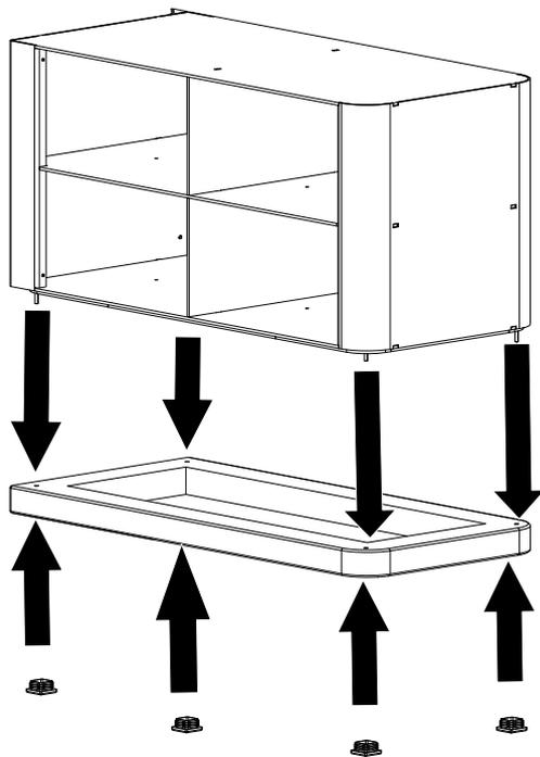
Fig. 17: Montaggio del box laterale
