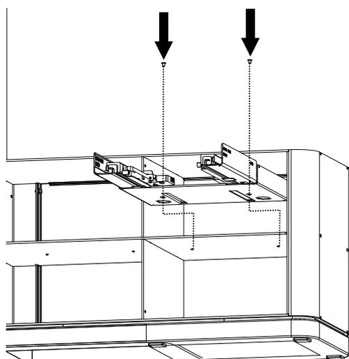
Fig. 21: Montaggio del telaio della guida
