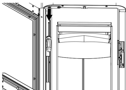
Fig. 42: Apertura dello sportello e svitamento delle viti
