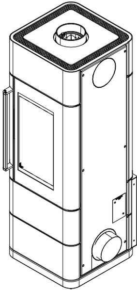
Fig. 26: Rimontaggio della parete posteriore
