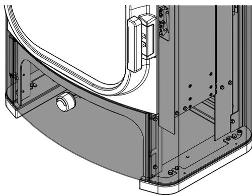
Fig. 33: Montaggio del rivestimento laterale
