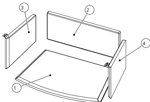
Fig. 26: Keramott - scomparto di cottura
