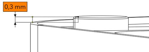
Fig. 15: Tampone di gomma (1) su 0,3 mm
