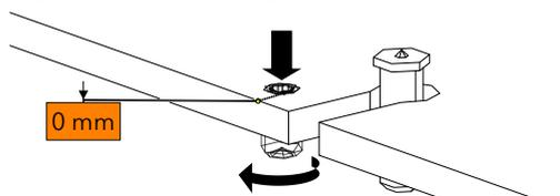
Fig. 16: Viti di regolazione (2) a 0 mm
