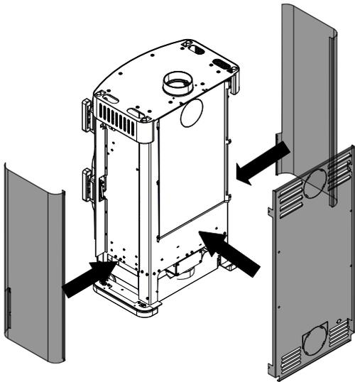
Fig. 18: Montaggio della parete posteriore e del rivestimento laterale
