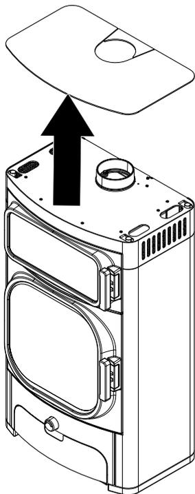
Fig. 9: Rimozione della piastra di cottura
