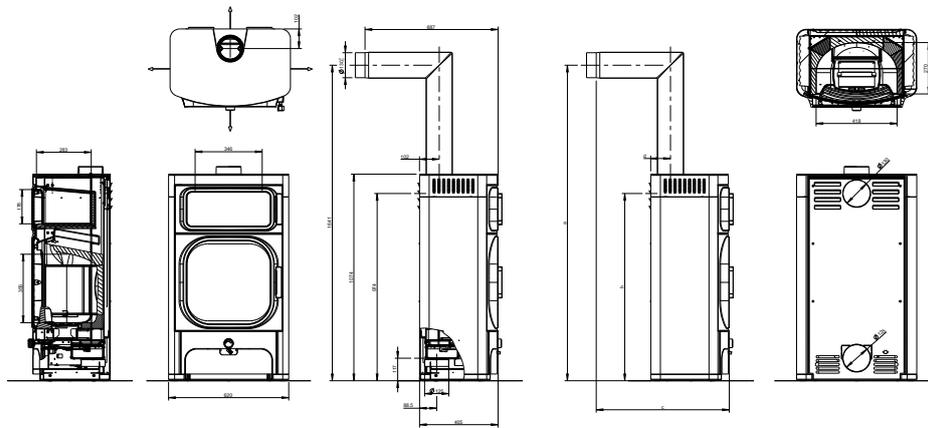
Fig. 1: Dimensioni dell'apparecchio di base
