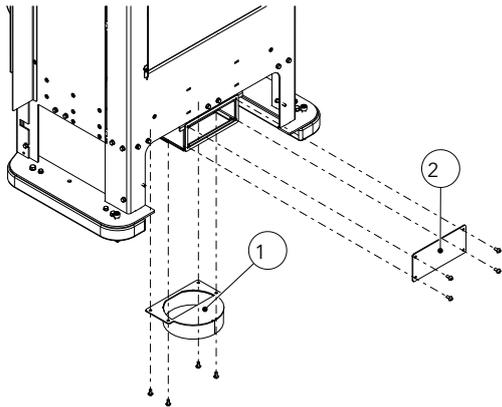
Fig. 28: Smontare della flangia dell'aria di alimentazione
