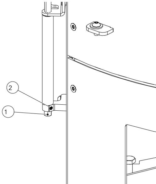
Fig. 41: Regolazione della forza di chiusura dello sportello
