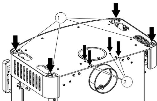
Fig. 14: Regolazione del tampone in gomma e delle viti di regolazione
