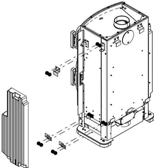
Fig. 22: Montaggio del supporto HMS e della pietra HMS
