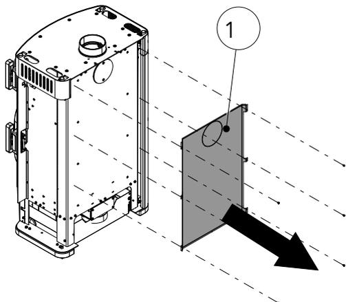
Fig. 20: Smontaggio della protezione anti-irraggiamento
