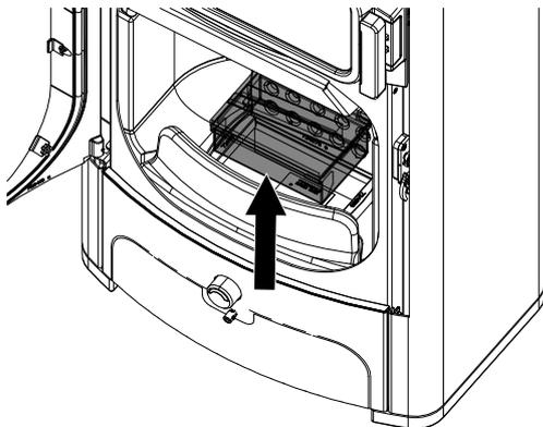
Fig. 54: Rimozione e svuotamento del box cenere
