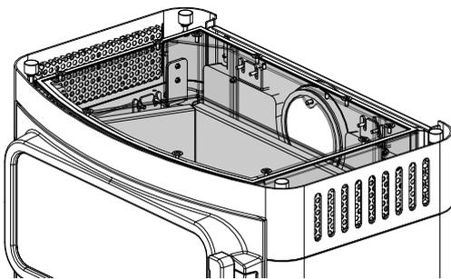
Fig. 50: Pulire i passaggi dei gas di scarico
