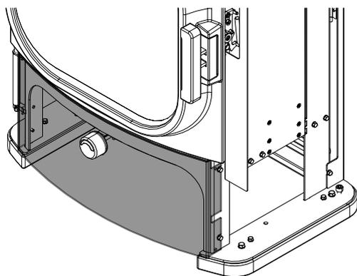
Fig. 32: Fissare il pannello/diaframma nuovo.
