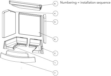
Fig. 50: Installing Keramott
