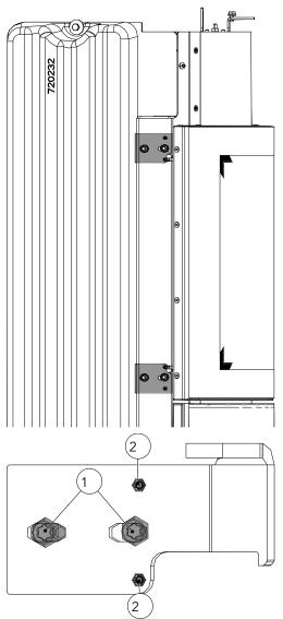
Fig. 54: Adjusting the door
