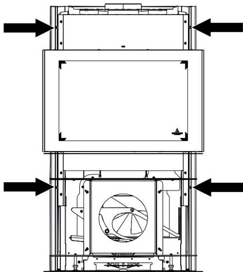
Abb. 71: Schrauben lösen
