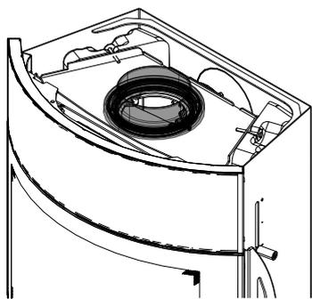
Abb. 46: Drehrauchrohrstützen montieren
