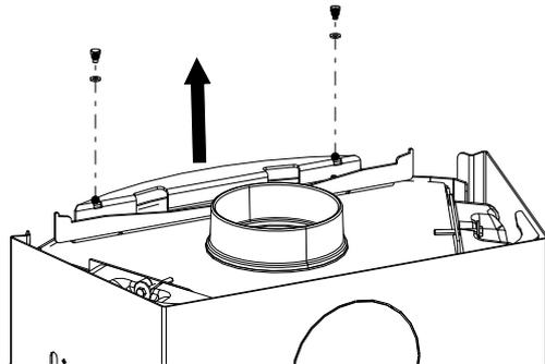
Abb. 30: Schrauben lösen
