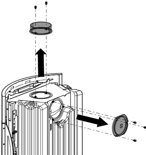
Abb. 10: Abdeckung und Rauchrohrstutzen demontieren
