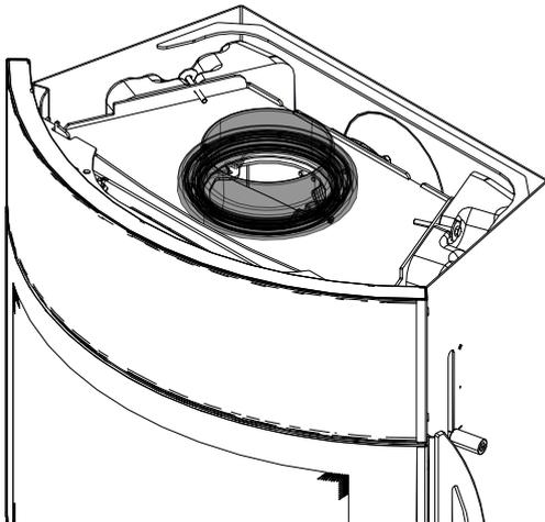
Abb. 40: Drehrauchrohrstutzen montieren
