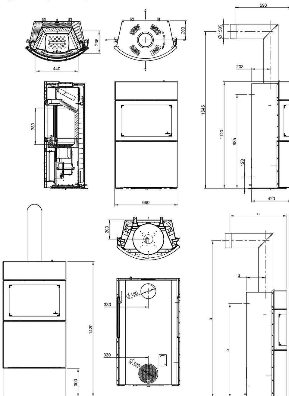
Abb. 2: Abmessungen Grundgerät
