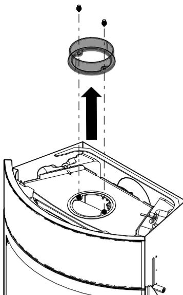
Abb. 45: Rauchrohrstutzen abmontieren
