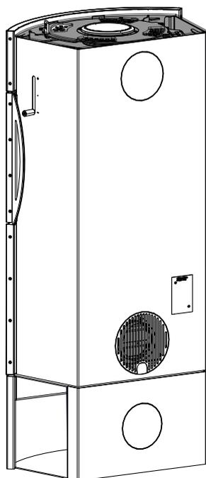
Abb. 28: Seitenverkleidung montieren
