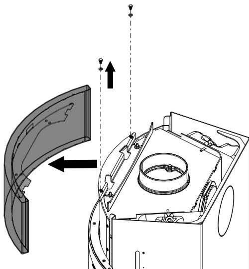
2) Die Schrauben der vorderen oberen Blende lösen und Blende abnehmen.
