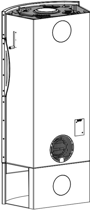
Abb. 49: Seitenverkleidung montieren
