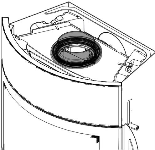
Abb. 36: Drehrauchrohrstutzen montieren
