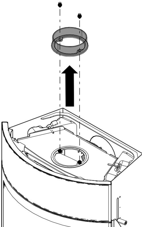
Abb. 35: Rauchrohrstutzen abmontieren
