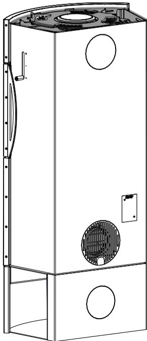
Abb. 23: Seitenverkleidung montieren
