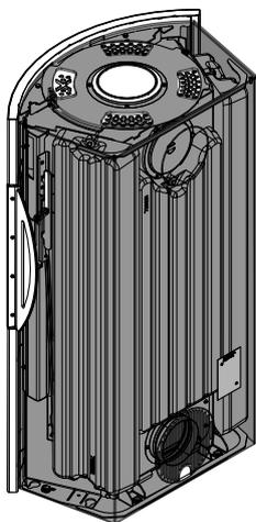
Abb. 13: Seitenverkleidung montieren
