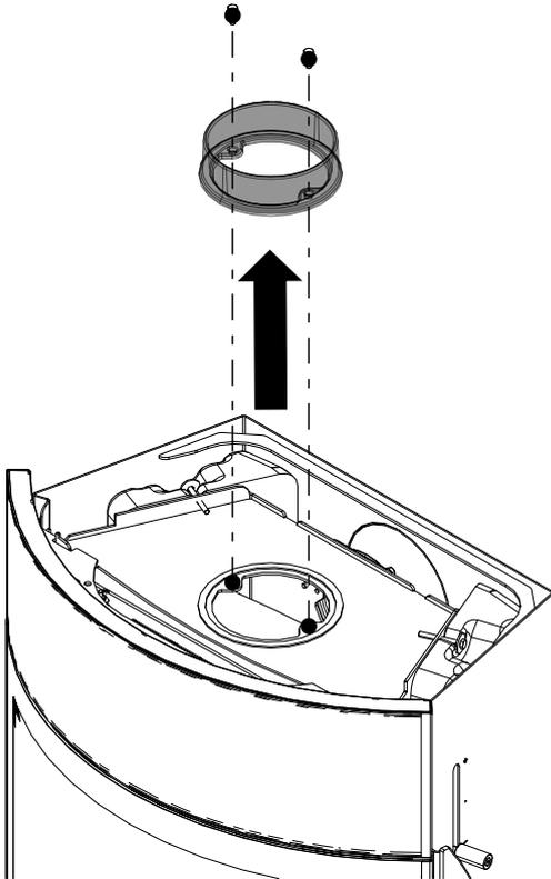
Abb. 39: Rauchrohrstutzen abmontieren
