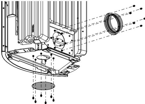
Abb. 25: Stützen und Abdeckung entfernen
