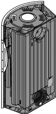
Abb. 15: Seitenverkleidung montieren
