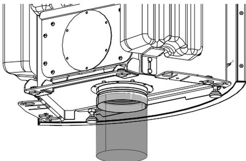
Abb. 18: Rohr befestigen
