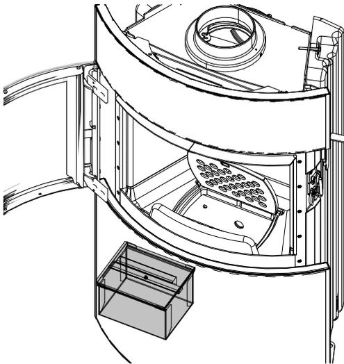
Abb. 67: Aschebox rausnehmen und entleeren
