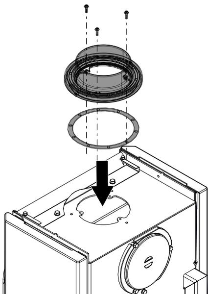
Fig. 17: Installer la tubulure de fumées orientable
