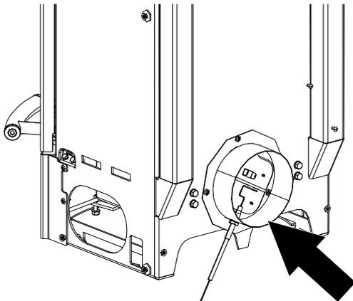
Fig. 14: Fixer le tuyau flexible en alu
