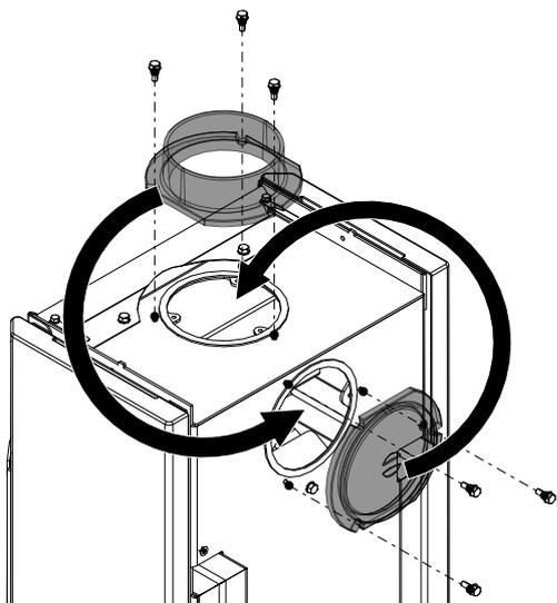
Fig. 10: Échanger le recouvrement et la tubulure
