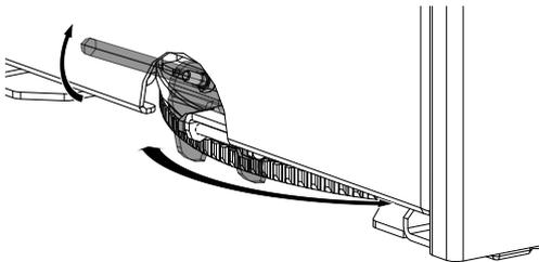
Lorsque le levier du plateau tournant est soulevé, le plateau est déverrouillé et le poêle peut tourner. Par contre, si le levier se trouve en position basse, le système de verrouillage s'enclenche dans l'encoche suivante prévue à cet effet et verrouille le plateau tournant : le poêle ne peut plus tourner.
