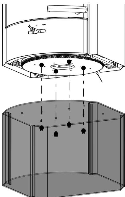
Fig. 22: Fixer le socle par le dessous
