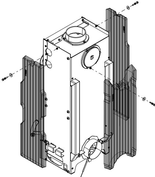
Fig. 47: Dévisser les vis et déposer l'HMS
