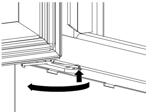
Abb. 44: Feder lösen
