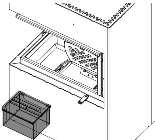
Abb. 39: Aschebox rausnehmen und entleeren
