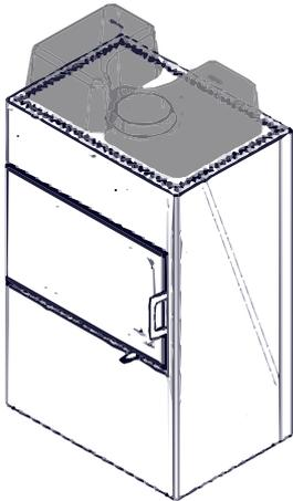
Abb. 21: HMS-Steine montieren
