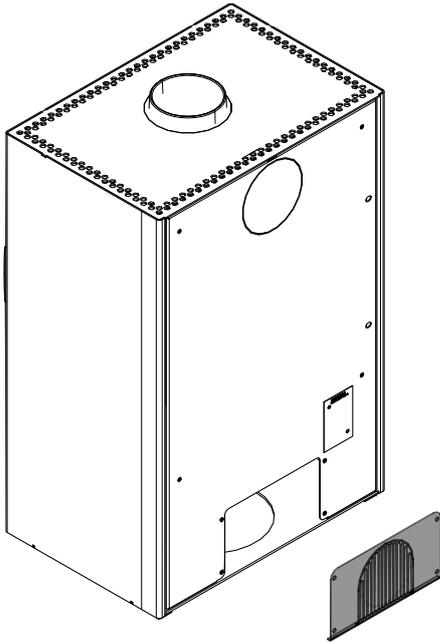
Abb. 11: Revision demontieren
