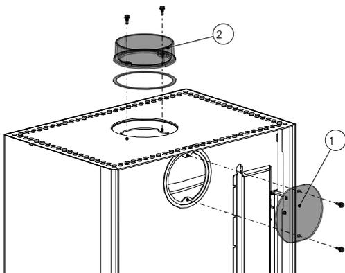
Abb. 15: Abdeckung und Stutzen demontieren
