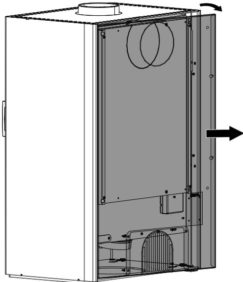
2) Diese Seite an der die Schrauben gelöst wurden, etwas zu sich ziehen und die Rückwand aushängen.
