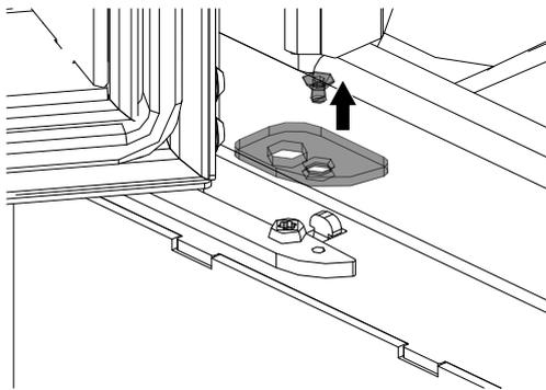
Abb. 43: Federabdeckung lösen
