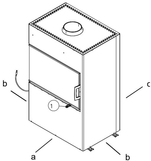
Abb. 4: Sicherheitsabstände (a,b,c) / Luftregler
