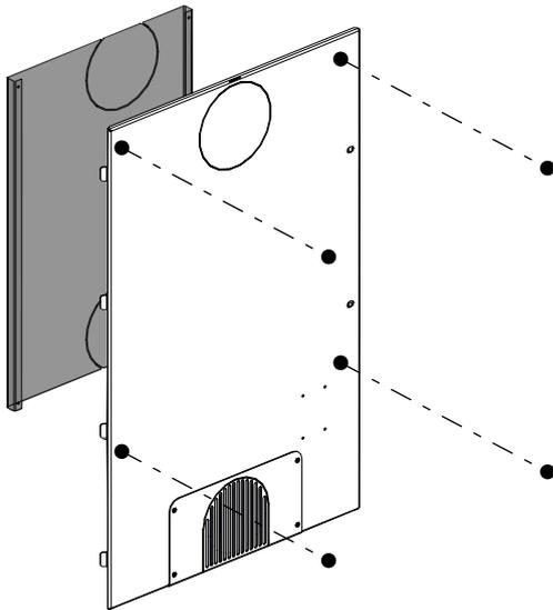
Abb. 13: Strahlenschutz demontieren
