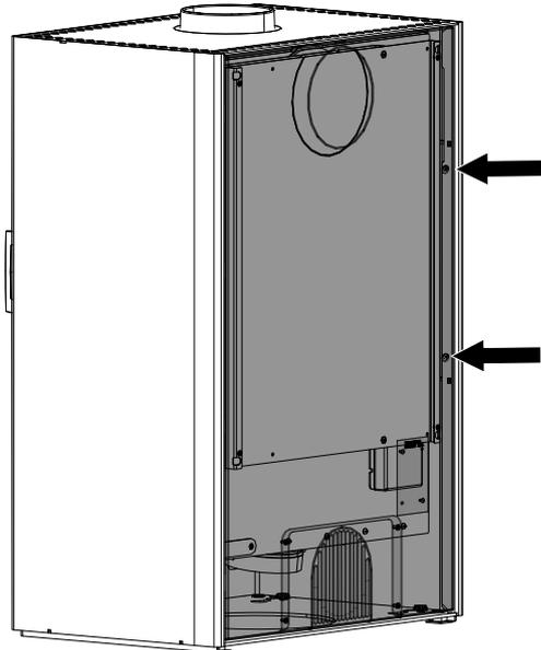
1) Schrauben durch die Langlöcher lösen.
