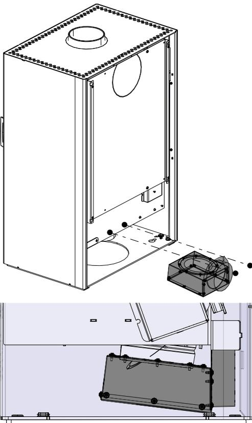
Abb. 12: Zuluftadapter montieren
