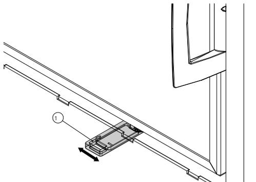
Abb. 32: Primär- Sekundärluftschieber
