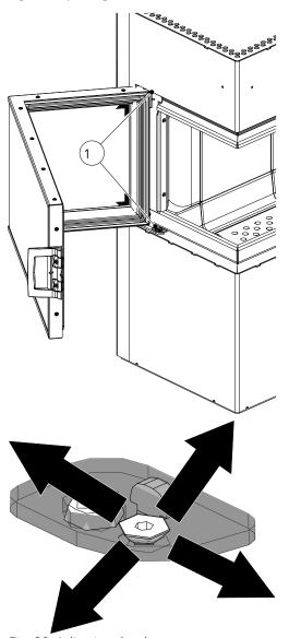
Fig. 30: Adjusting the door
