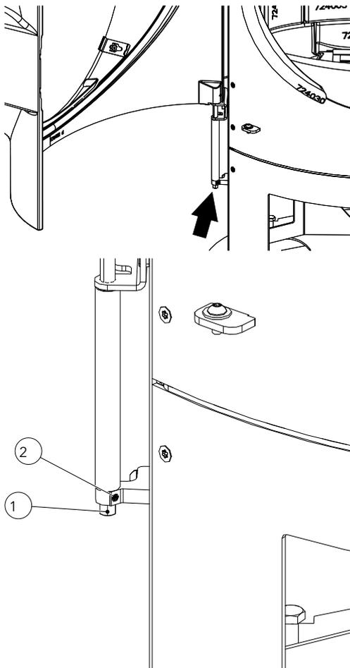
Fig. 24: Régler la force de fermeture de la porte
