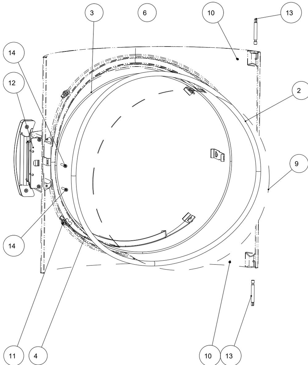
Fig. 38: Porte de la chambre de combustion
