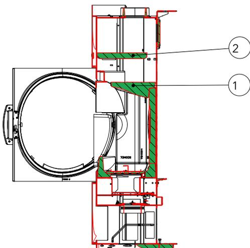
Fig. 42: Enlever la Keramott et la plaque déflectrice
