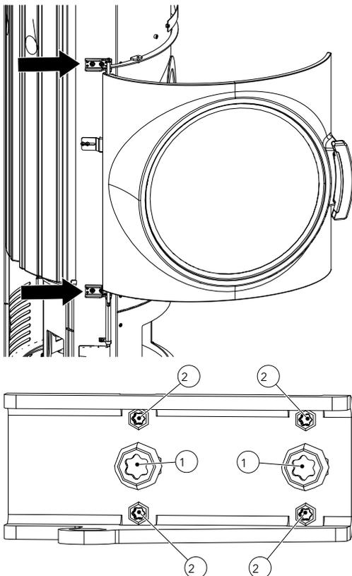
Fig. 19: Vis de réglage de la porte
