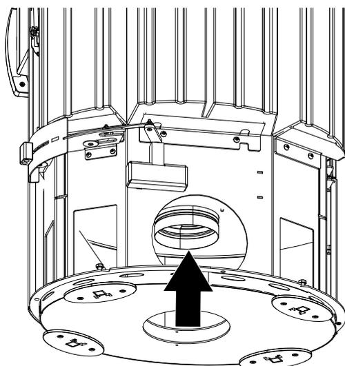
Fig. 14: Fixer le tuyau flexible en alu
