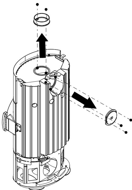
Fig. 9: Démontez le revêtement et la tubulure de fumées
