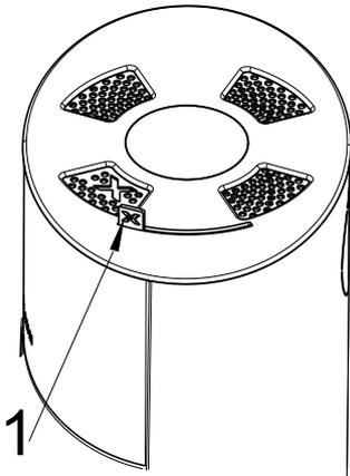
Fig. 33: Manette de régulation de l'air de convection
