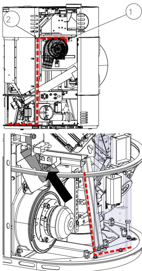
Fig. 25: Poser le câble et fixer le condensateur
