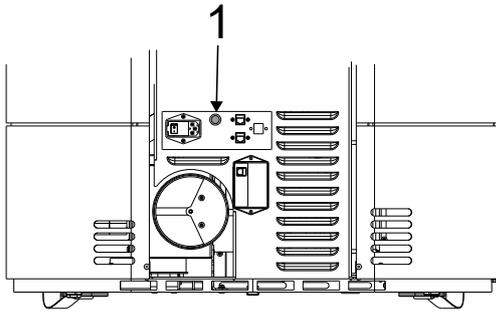
Votre poêle est équipé au dos d'un limiteur de température de sécurité (1).
