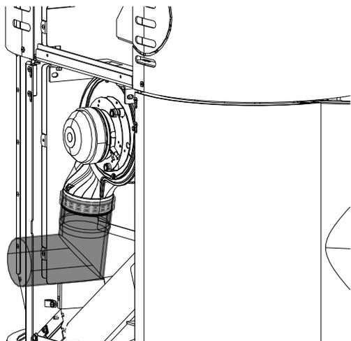
Fig. 29: Mettre le tube sur le kit
