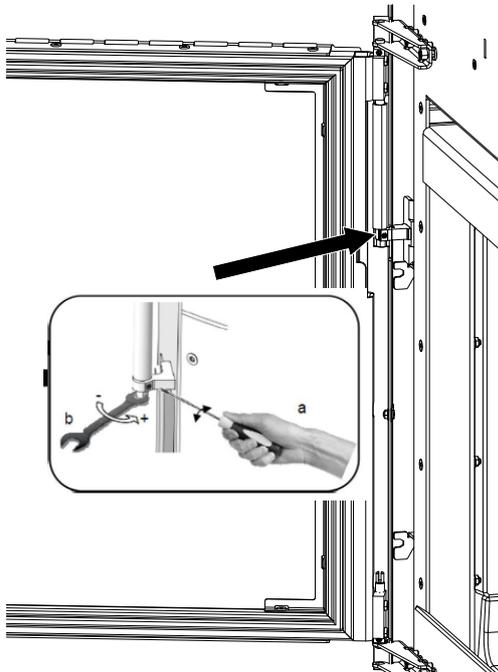
Fig. 74: Ajuster le ressort de tension
