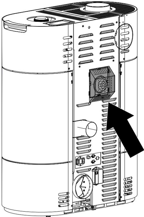
Fig. 32: Mettre le recouvrement sur le panneau arrière
