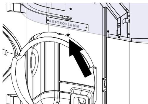
Fig. 94: Ouvrir la porte et dévisser l'écrou.
