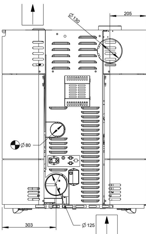
Fig. 33: Raccordement de l'alimentation en air de combustion
