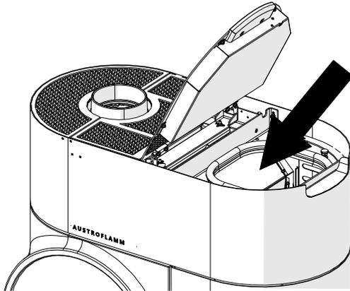
Fig. 41: Remplir les pellets
