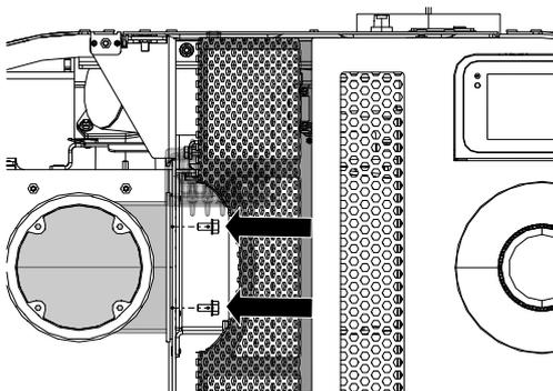
Fig. 15: Déposer le conduit coudé
