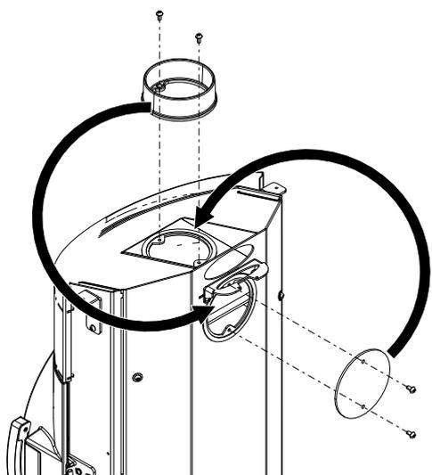
Fig. 8: Échanger le recouvrement et la tubulure
