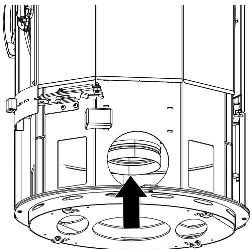
Fig. 12: Fixer le tuyau flexible en alu
