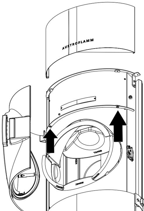
Fig. 23: Déposer l'habillage avant supérieur
