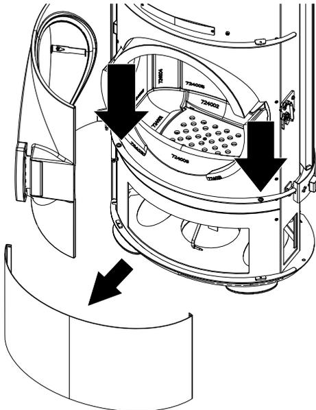
Fig. 27: Déposer l'habillage avant inférieur
