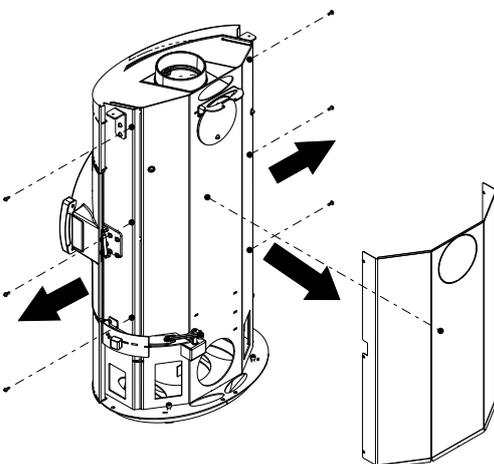
Fig. 6: Démonter le recouvrement
