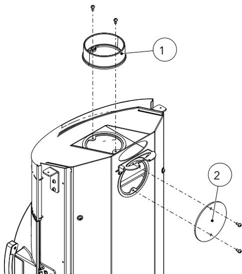
Fig. 7: Démontez la tubulure de fumées et le recouvrement
