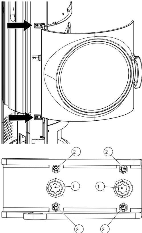
Fig. 25: Vis de réglage de la porte
