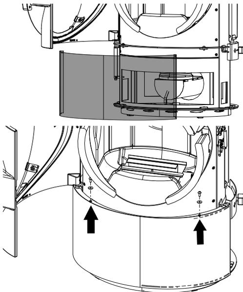
Fig. 19: Installer l'habillage avant inférieur
