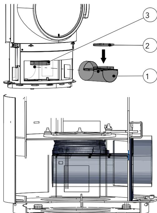
Fig. 18: Installer l'adaptateur d'arrivée d'air
