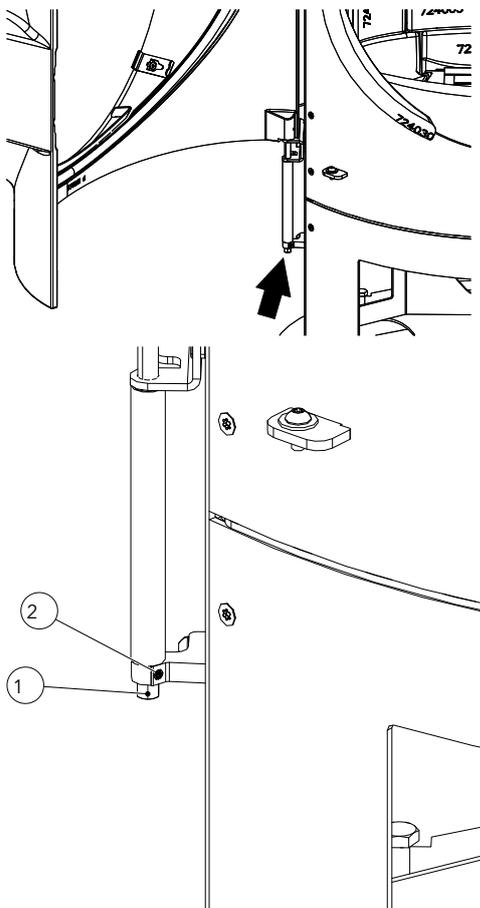
Fig. 28: Régler la force de fermeture de la porte
