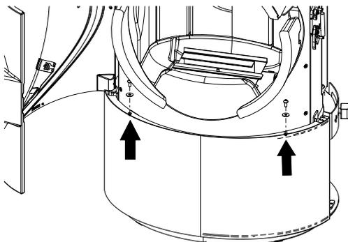
Fig. 42: Dévisser les vis de l'habillage avant inférieur
