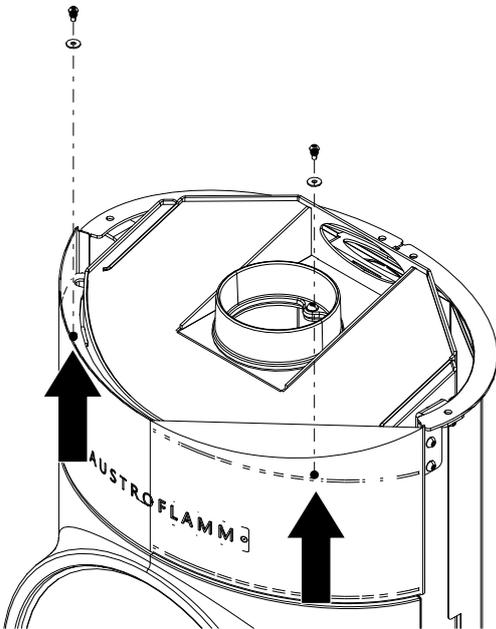
Fig. 39: Dévisser les vis de l'habillage avant supérieur
