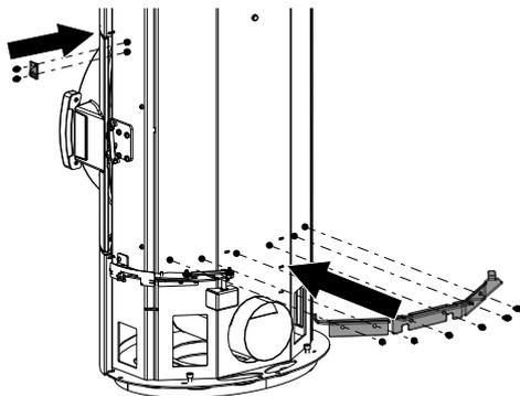
Fig. 15: Installer les appuis HMS
