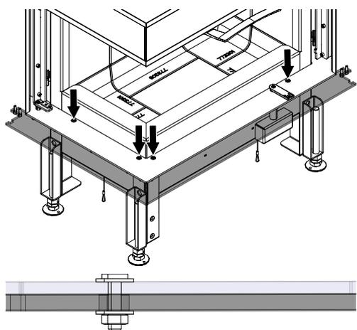
Fig. 66: Installer le cadre design en bas
