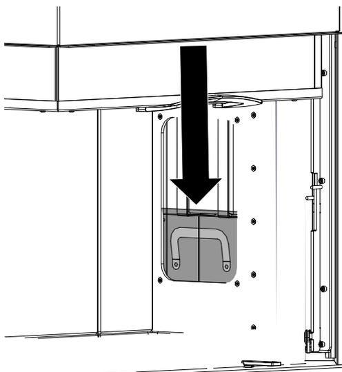
Fig. 75: Appuyer sur le couvercle pour l'abaisser
