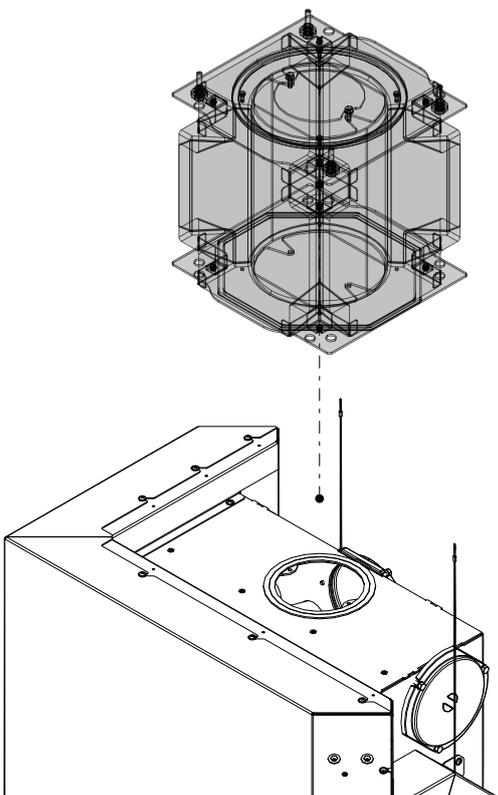
Fig. 38: Poser le caisson d'accumulation
