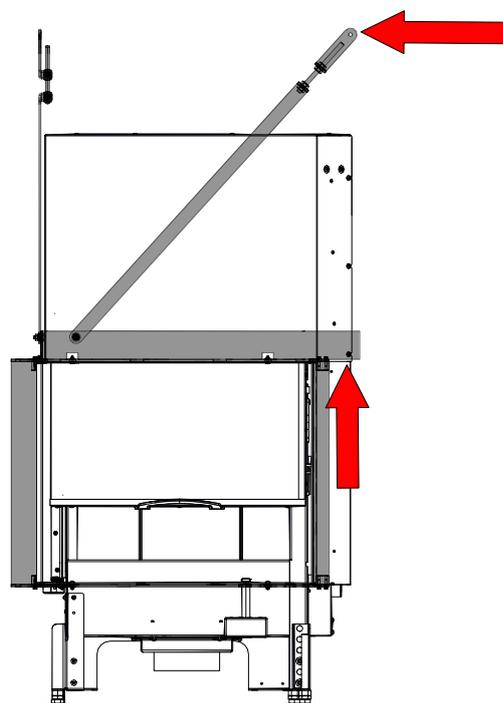
Fig. 70: Mettre le cadre design en charge (modèle gauche)
