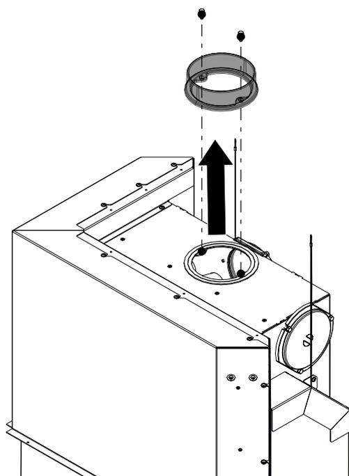
Fig. 35: Démontez la tubulure de fumées
