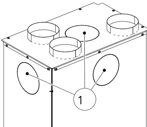
Fig. 57: Découpe perforée pour conduit de fumée.
