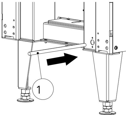
Fig. 51: Enfiler le câble Bowden
