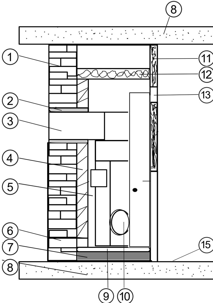
Fig. 5: Construction devant / à côté d'un mur à protéger
