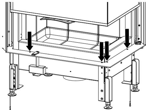
Fig. 61: Ouvrir légèrement la porte et dévisser les vis.
