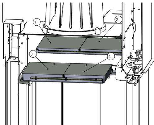
Fig. 19: Plaques déflectrices 69x49x57 droite
