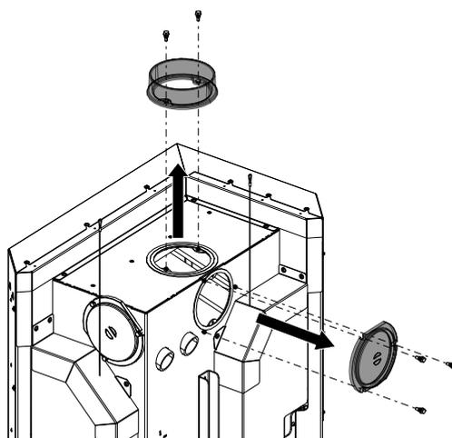
Fig. 30: Démontez le recouvrement et la tubulure de fumées
