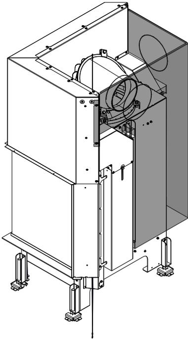
Fig. 33: Démontez la plaque de protection anti-radiations
