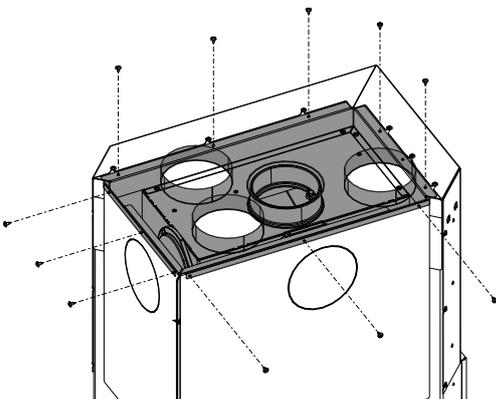
Fig. 60: Poser le couvercle du kit de convection et le fixer
