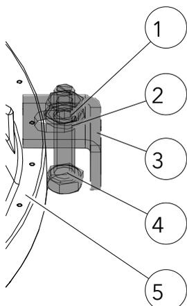
Fig. 40: Installer l'avaloir de fumées sur le caisson d'accumulation
