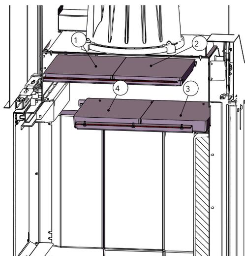
Fig. 18: Plaques déflectrices 69x49x57 gauche
