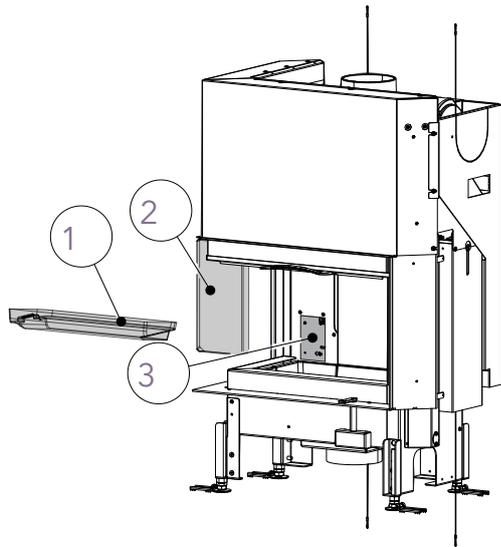
Sur les appareils en angle, la plaque signalétique (3) se trouve sur le panneau arrière, derrière la Keramott (2), à côté de la charnière de la porte. Enlevez d'abord la plaque déflectrice (1), puis la Keramott arrière (2) (gauche ou droite).
