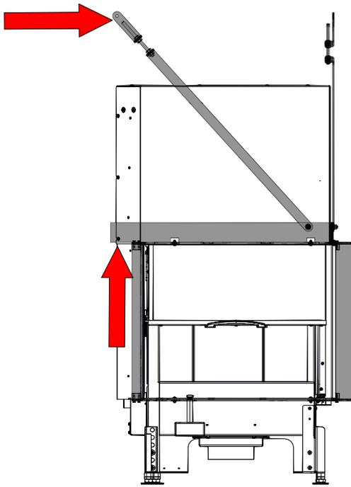
Fig. 71: Mettre le cadre design en charge (modèle gauche)
