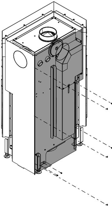
Fig. 59: Poser la partie arrière du kit de convection et la fixer
