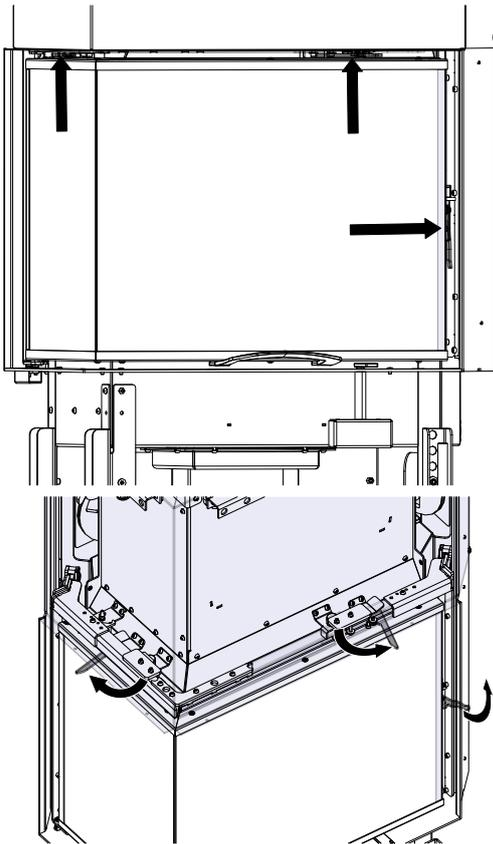
Fig. 82: Ouvrir la remontée de la porte
