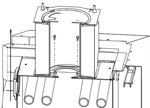
Fig. 39: Installer le caisson d'accumulation
