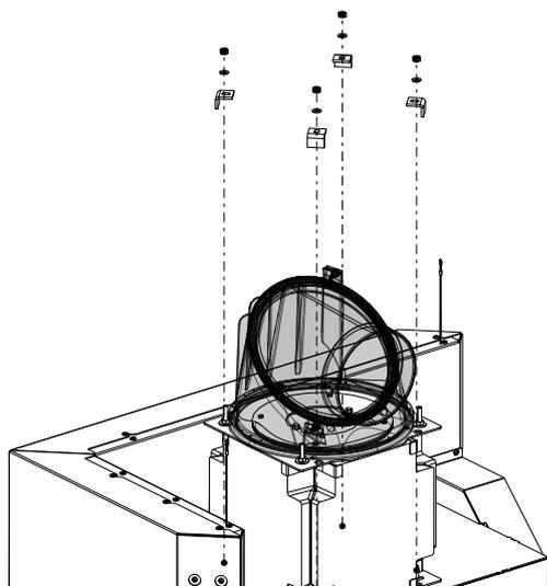
7) Mettre l'avaloir de fumées (5) sur le petit caisson d'accumulation et le fixer sur les boulons (4) avec les griffes de serrage (3), les rondelles (2) et les écrous hexagonaux (3).
