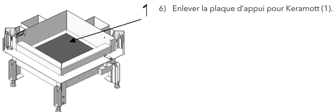
Fig. 48: Enlever la plaque d'appui pour Keramott
