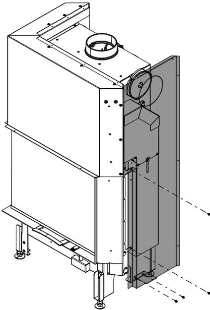
Fig. 58: Poser la partie latérale du kit de convection et la fixer
