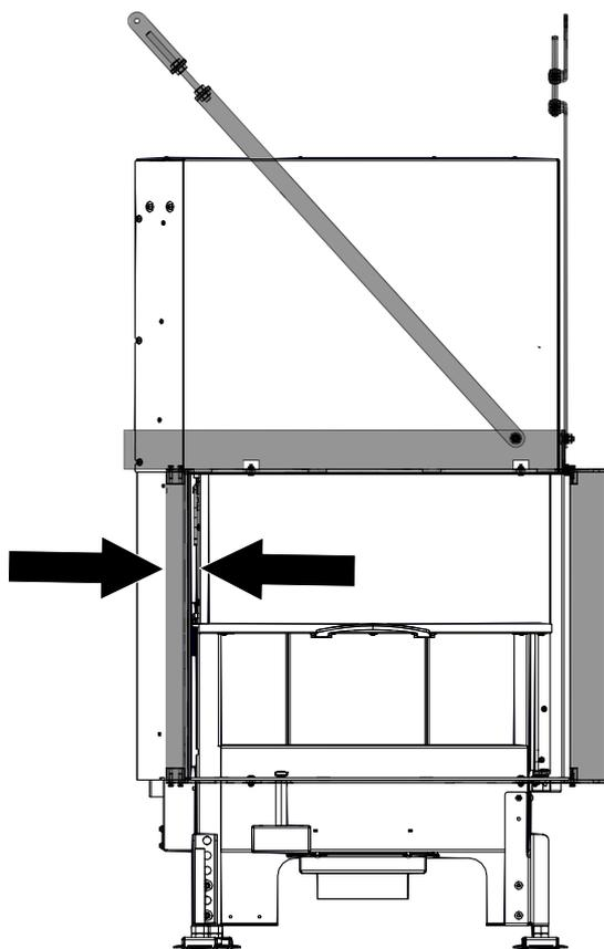
Fig. 69: Ajuster uniformément le cadre design (modèle gauche)
