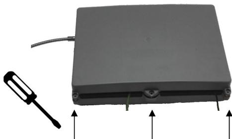
Fig. 55: Débrancher le bloc d'alimentation
