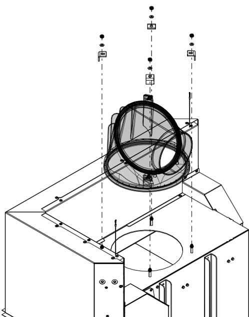
Fig. 37: Déposer l'avaloir de fumées
