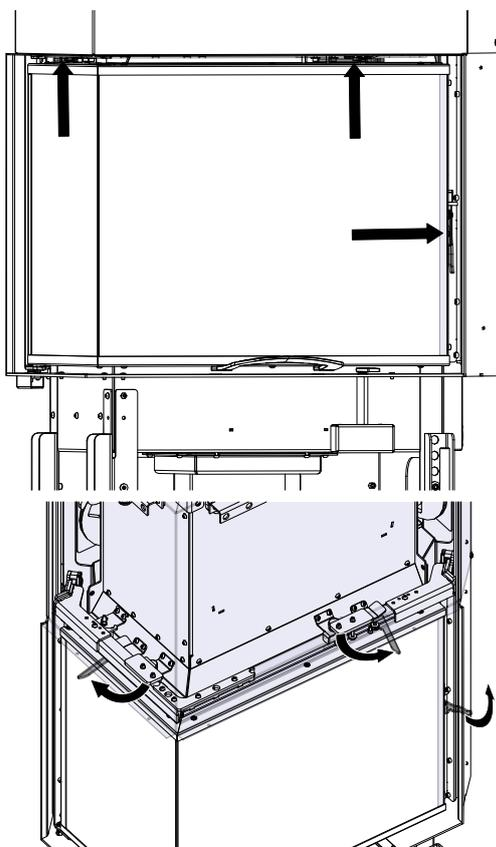
Fig. 25: Ouvrir la remontée de la porte
