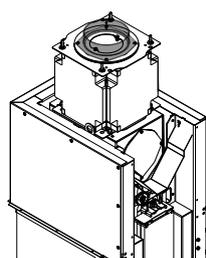
Fig. 29: Montaggio della presa della canna fumaria
