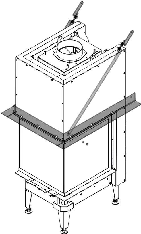
Fig. 45: Fissaggio e allineamento della struttura portante
