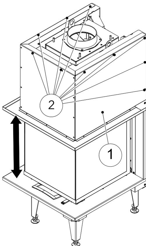
Fig. 67: Regolazione della distanza del telaio di design
