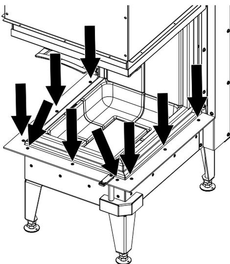
Fig. 33: Allentamento della filettatura
