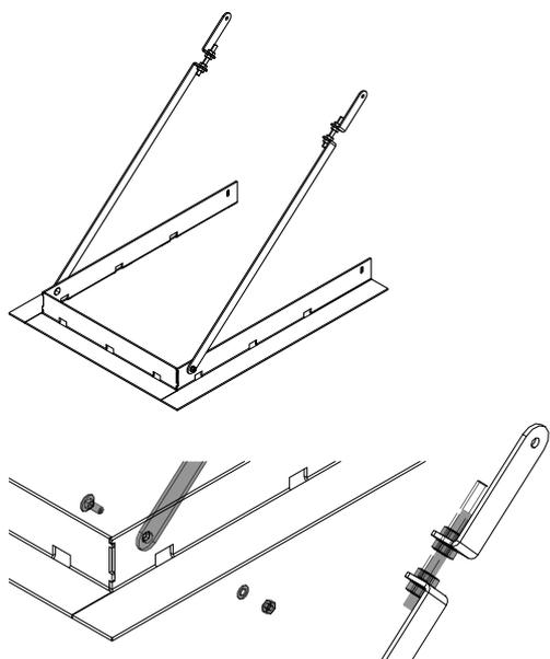
Fig. 37: Assemblaggio del telaio di design
