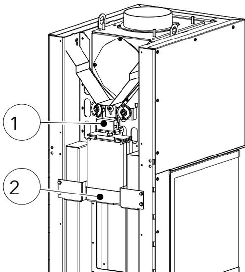
Fig. 4: Rimozione delle sicurezze per il trasporto
