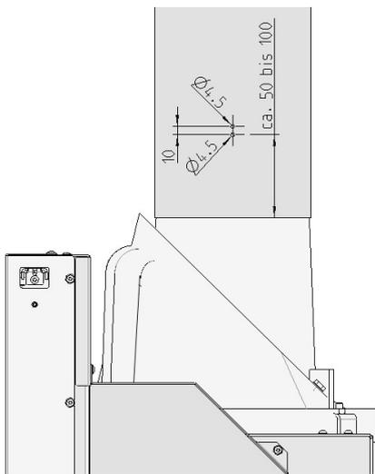
Fig. 51: Diagramma di perforazione - tubo dei fumi
