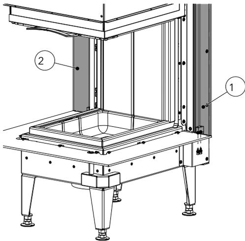
Fig. 39: Montaggio del telaio di design a sinistra/destra
