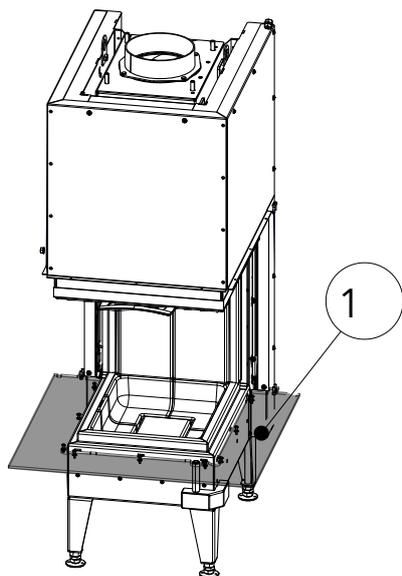
Fig. 38: Montaggio del telaio di design in basso
