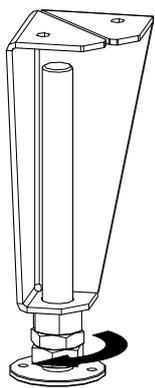
Fig. 15: Regolazione dei piedini regolabili con SW24
