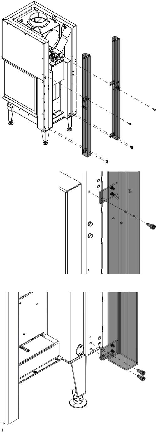
Fig. 48: Montaggio dell'incastellatura
