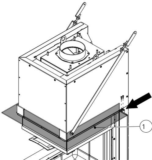
Fig. 40: Montaggio del telaio nella parte superiore
