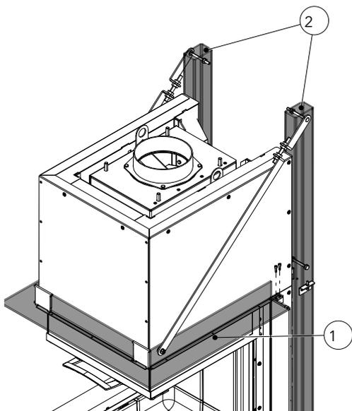
Fig. 41: Montaggio del telaio di progettazione sul controtelaio
