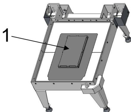
Fig. 55: Rimozione della piastra di supporto Keramott
