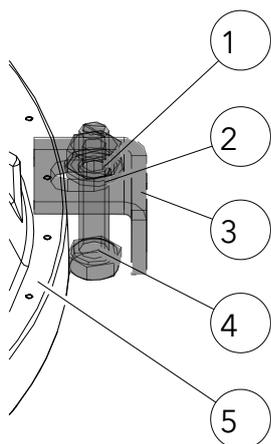
Fig. 44: Montaggio del collettore dei gas di scarico
