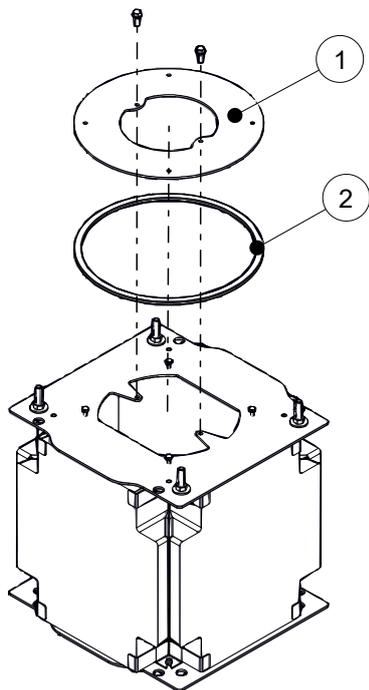
Fig. 41: Rimozione della guarnizione e dell'adattatore in lamiera
