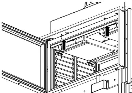
Fig. 89: Fissaggio superiore della struttura di design
