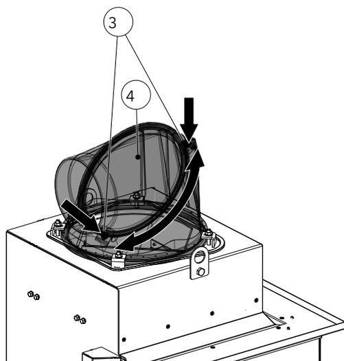
Fig. 102: Regolazione del supporto del collettore del fumo
