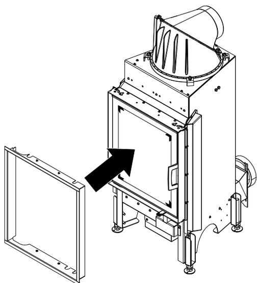
Fig. 83: Posizionamento della struttura di design
