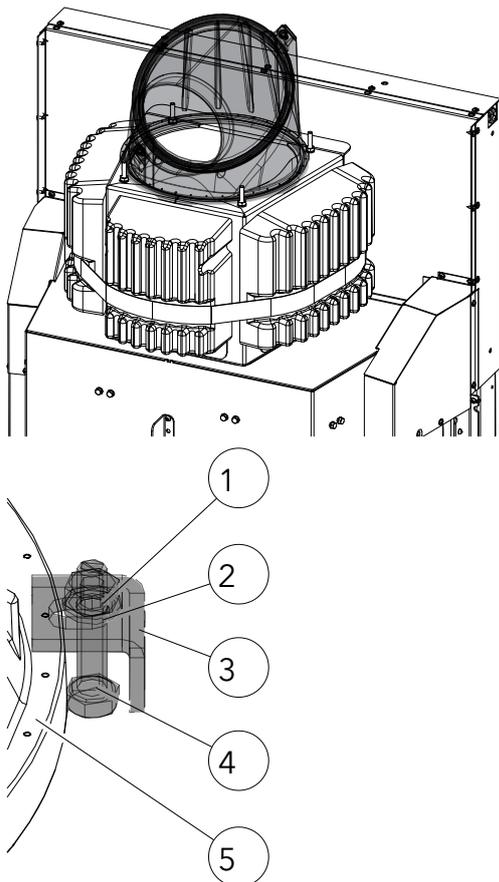
Fig. 37: Montaggio del collettore di scarico dei gas
