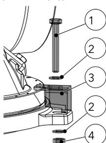
Fig. 34: Montaggio del collettore dei fumi
