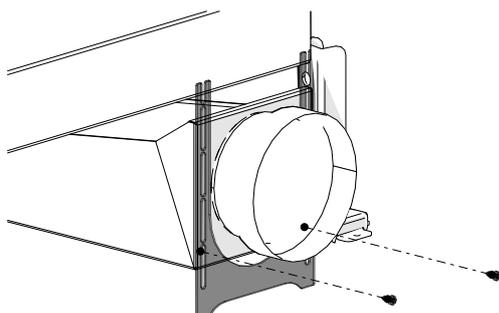
Fig. 40: Montaggio del fissaggio
