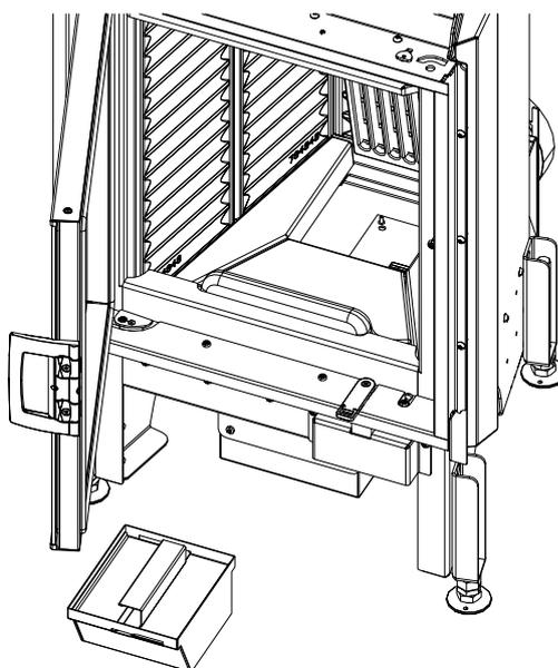
Fig. 108: Rimozione e svuotamento del box cenere
