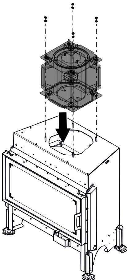
Fig. 43: Posizionamento della cassetta di
