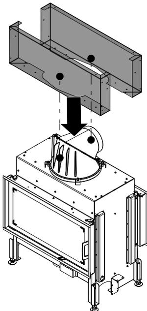
Fig. 75: Montaggio della parete KV superiore (anteriormente + posteriormente)
