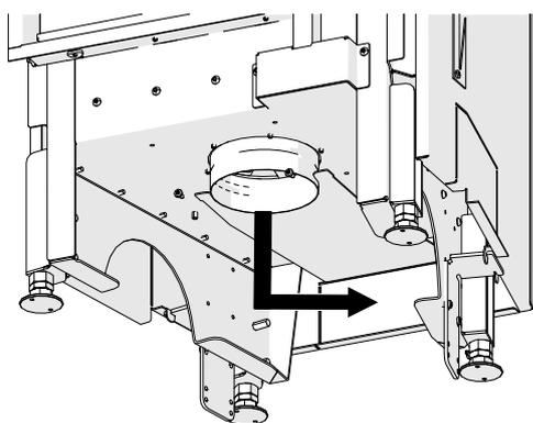
Il raccordo dell'aria comburente deve essere sempre collegato, altrimenti è impossibile immettere aria nella camera di combustione.
