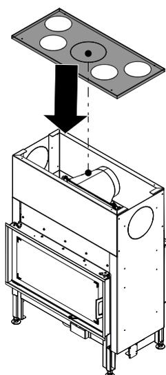
Fig. 78: Montaggio del coperchio KV (conv.)
