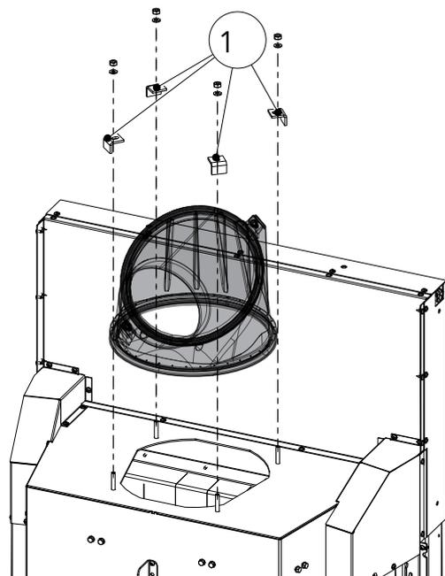
Fig. 35: Smontaggio del collettore dei fumi
