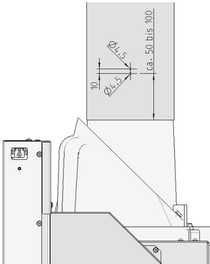
Fig. 48: Diagramma di perforazione - tubo dei fumi
