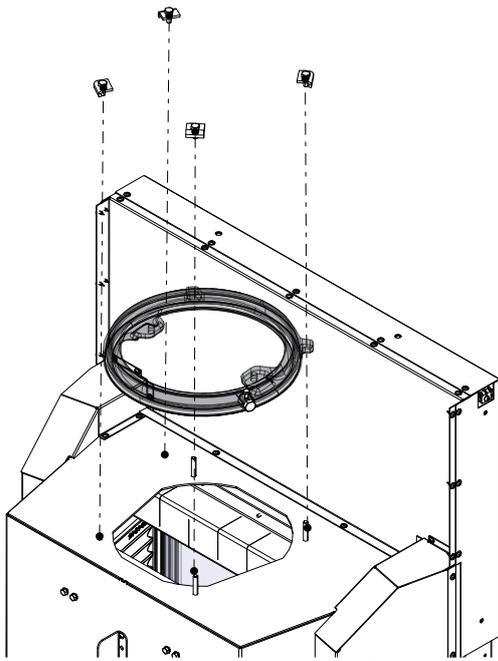
Fig. 29: Montaggio dell'anello inferiore
