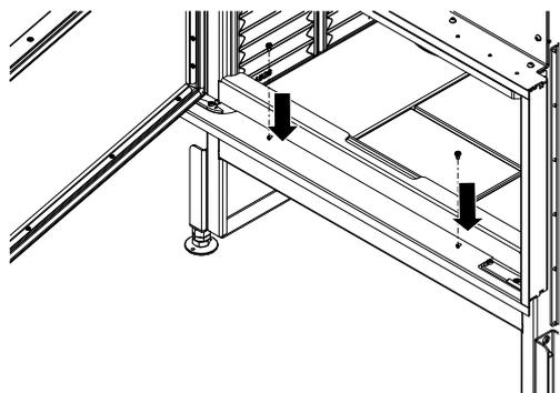
Fig. 87: Fissaggio inferiore della struttura di design
