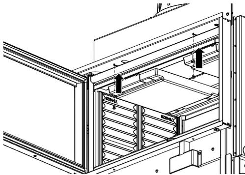
Fig. 82: Fissaggio superiore della struttura di design
