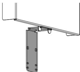
Fig. 62: Innesto della parete KV a destra e a sinistra
