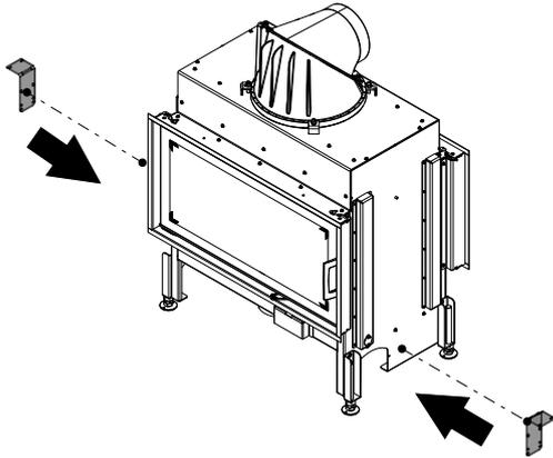
Fig. 65: Montaggio del supporto a sinistra e a destra
