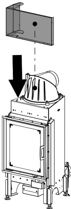
Fig. 59: Montaggio della parete KV anteriore
