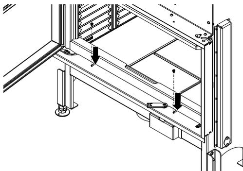
Fig. 83: Fissaggio inferiore della struttura di design
