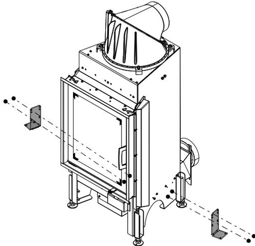
Fig. 55: Montaggio del supporto a sinistra e a destra
