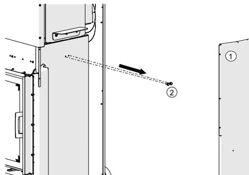
Fig. 25: Smontaggio della copertura e delle viti
