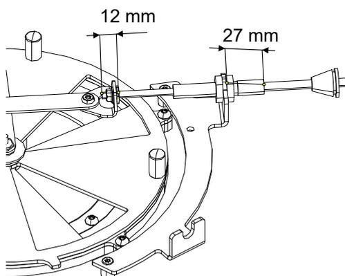
Fig. 50: Collegamento del cavo Bowden
