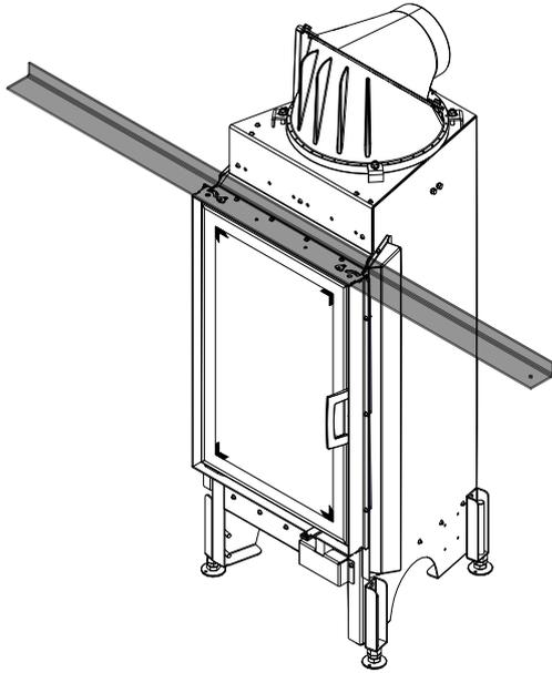
La struttura portante viene accorciata in lunghezza in base al modello. La struttura portante viene appoggiata a quella muraria e non richiede alcun tipo di ancoraggio.
