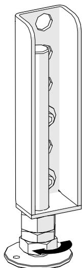
Fig. 16: Regolazione dei piedini regolabili con SW24
