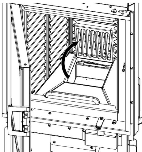
Fig. 97: Rimozione o ribaltamento della griglia
