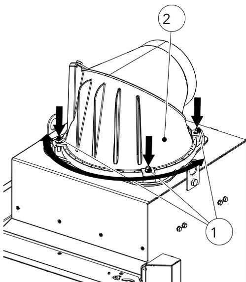
Fig. 93: Rotazione del collettore del fumo nella posizione desiderata
