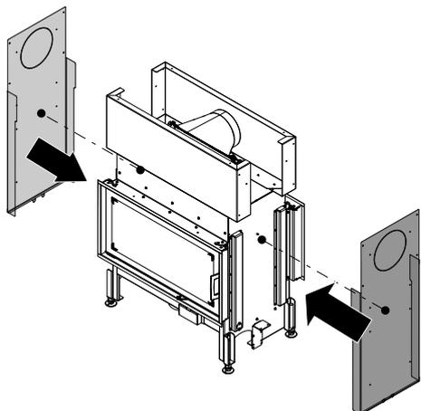
Fig. 69: Applicazione della parete KV a sinistra e a destra
