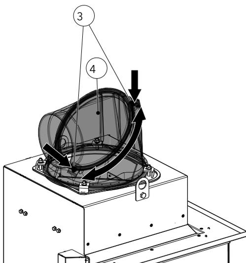
Fig. 94: Regolazione del supporto del collettore del fumo
