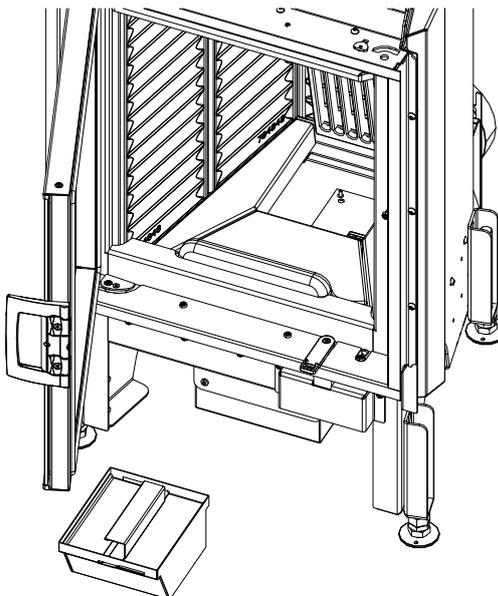
Fig. 100: Rimozione e svuotamento del box cenere
