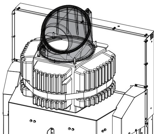
4) Posizionare il collettore dei gas di scarico (5) sulla cassetta portaoggetti e fissarlo ai bulloni (4) con la staffa di fissaggio (3), la rondella (2) e il dado SK (3).
