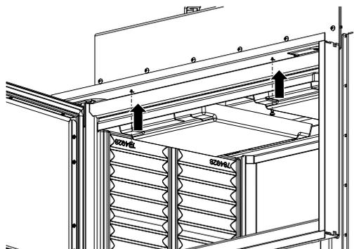
Fig. 86: Fissaggio superiore della struttura di design
