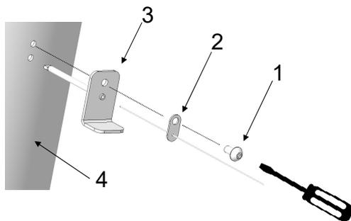
Fig. 42: Montaggio del sensore di temperatura
