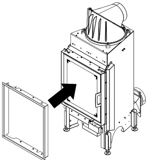
Fig. 76: Posizionamento della struttura di design
