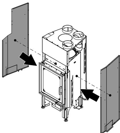
Fig. 61: Applicazione della parete KV a destra e a sinistra
