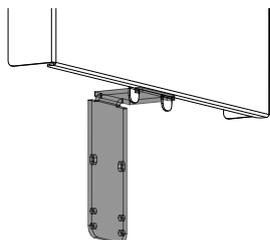
Fig. 70: Innesto della parete KV a sinistra e a destra
