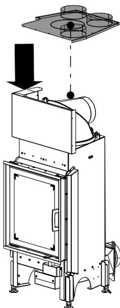
Fig. 60: Montaggio del coperchio KV (conv.)
