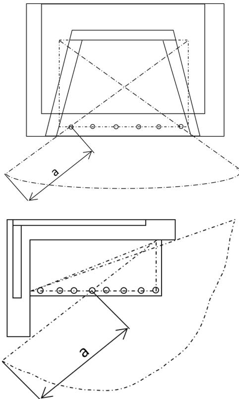
Nell'area di irradiazione dell'inserto per caminetto non devono essere collocati oggetti infiammabili fino a una determinata distanza (vedere Dati tecnici), che viene misurata dal bordo anteriore dell'apertura della camera di combustione (indicata come distanza di sicurezza nei dati tecnici).
