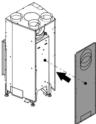
Fig. 63: Montaggio della parete KV posteriore
