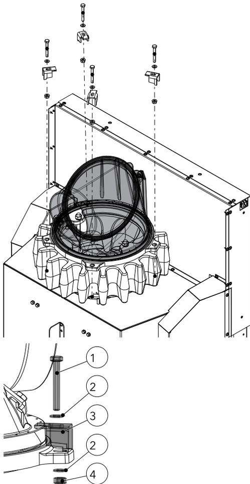
Fig. 34: Montaggio del collettore dei fumi
