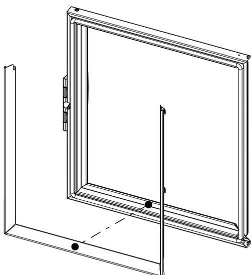
3) Montare il pannello radiante sul lato destro e piegare le linguette verso il telaio con una pinza.
