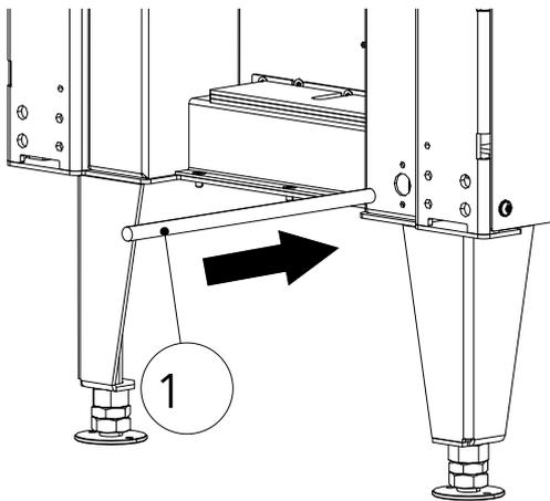
Fig. 49: Inserimento del cavo Bowden
