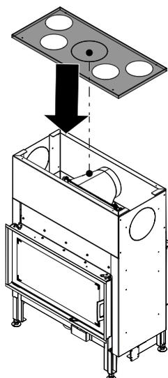
Fig. 71: Montaggio del coperchio KV (conv.)
