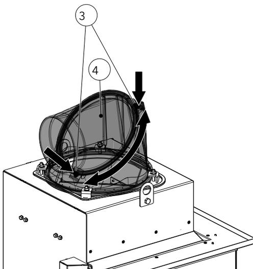
Fig. 102: Régler la buse de l'avaloir de fumées
