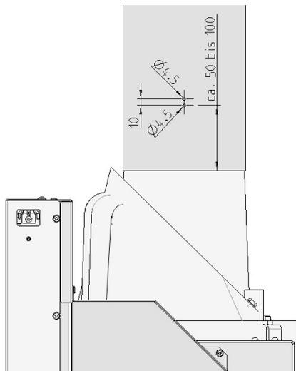
Fig. 48: Schéma de perçage pour conduit de fumée
