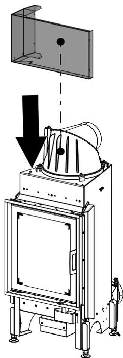
Fig. 66: Installer la paroi de convection avant
