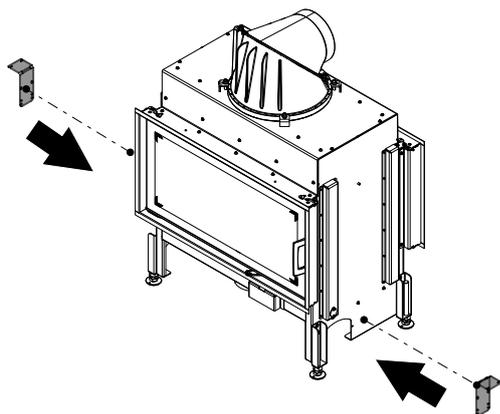
Fig. 72: Installer les fixations gauche et droite
