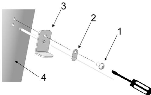
Fig. 49: Installer la sonde de température
