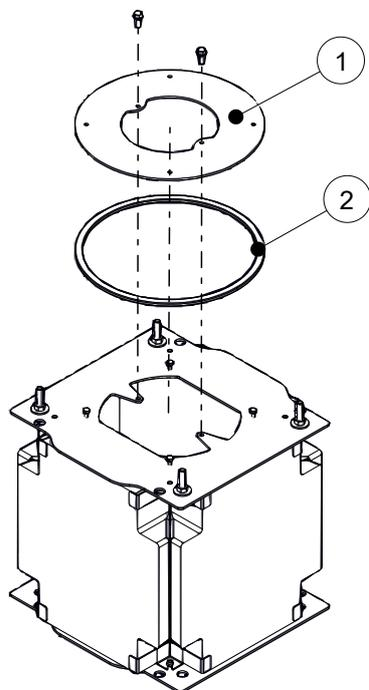
Fig. 41: Enlever le joint et la plaque d'adaptation
