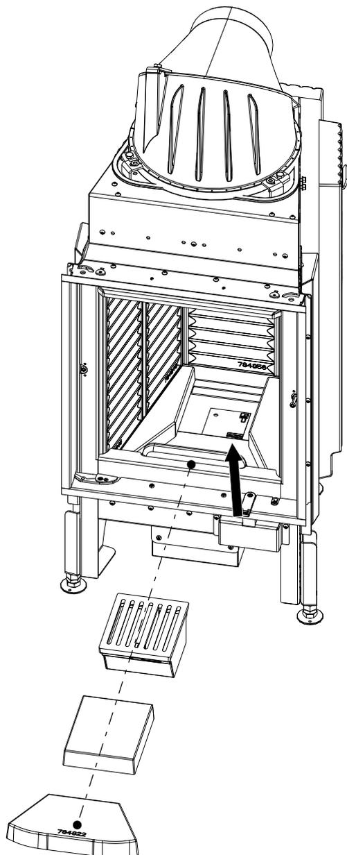
Fig. 97: Mettre le bac à cendres en place
