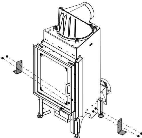
Fig. 62: Installer les fixations gauche et droite
