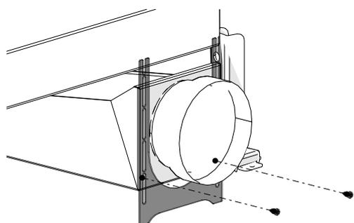
Fig. 40: Installer la fixation
