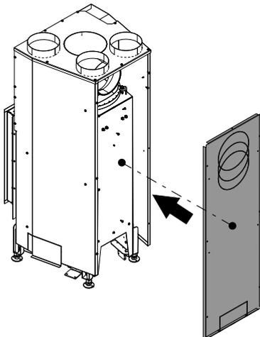
Fig. 70: Installer la paroi de convection arrière
