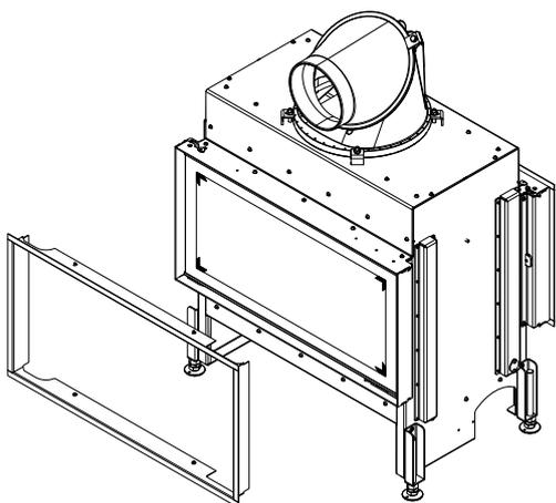
Fig. 91: Positionner le cadre design au dos
