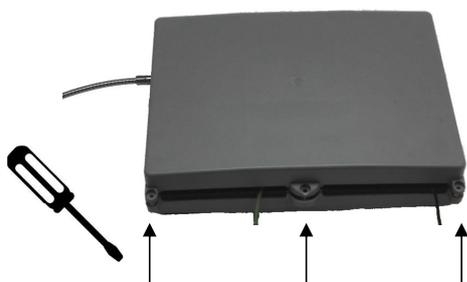
Fig. 53: Débrancher le bloc d'alimentation
