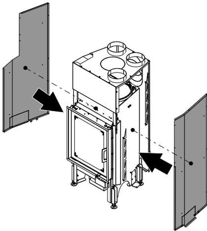
Fig. 61: Poser les parois de convection droite et gauche
