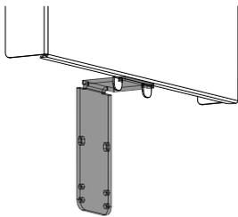
Fig. 62: Enclencher les parois de convection droite et gauche
