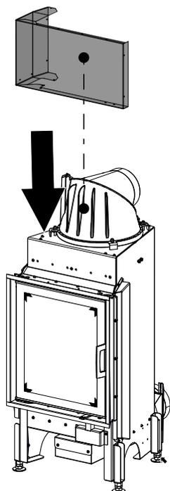
Fig. 59: Installer la paroi de convection avant
