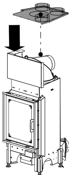
Fig. 60: Installer le couvercle de convection
