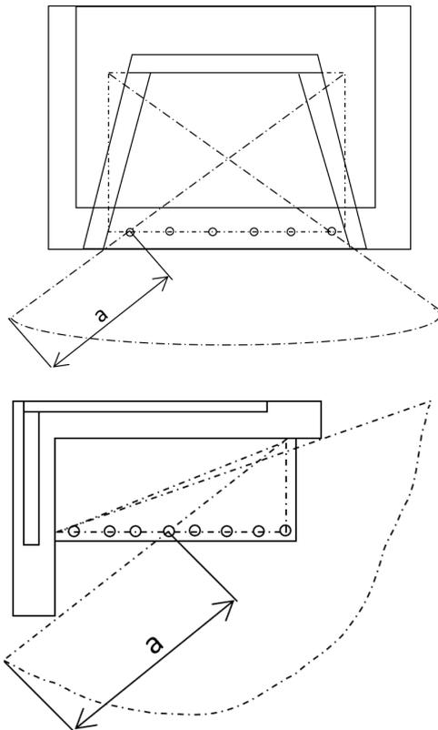
Dans le périmètre de rayonnement du foyer, ne pas poser d'objet inflammable à une distance définie dans les Données techniques mesurée à partir du rebord avant de l'ouverture du foyer (a Distance de sécurité dans les données techniques).
