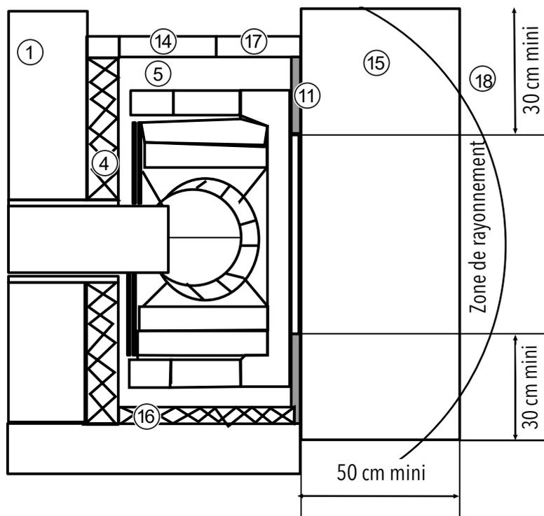
Fig. 6: Construction devant / à côté d'un mur protecteur
