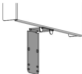
Fig. 70: Enclencher les parois de convection gauche et droite
