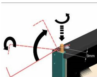
6) Accrocher le ressort et le tendre jusqu'à la butée de l'axe.
