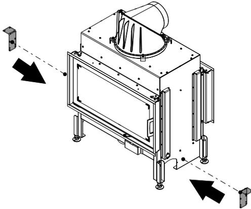
Fig. 65: Installer les fixations gauche et droite
