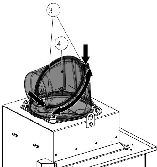
Fig. 94: Régler la buse de l'avaloir de fumées
