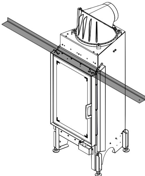
Le cadre porteur doit être raccourci en longueur (en fonction du modèle). Le cadre porteur se pose sur la maçonnerie latérale et ne nécessite aucun ancrage supplémentaire.
