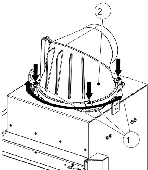
Fig. 93: Orienter l'avaloir de fumées dans la position souhaitée
