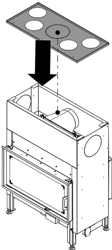
Fig. 71: Installer le couvercle de convection
