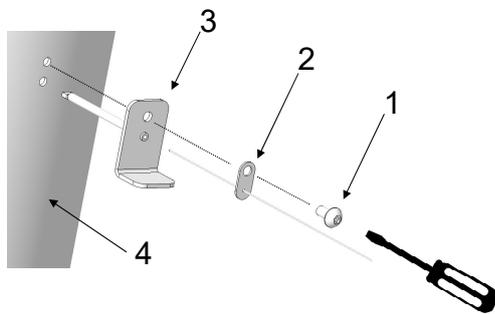
Fig. 42: Installer la sonde de température
