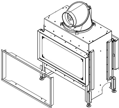
Fig. 84: Positionner le cadre design au dos
