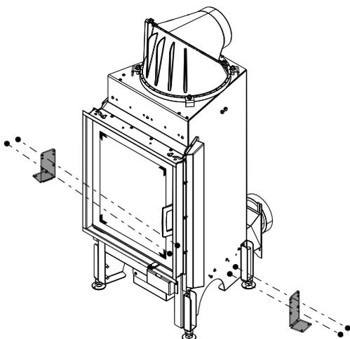
Fig. 55: Installer les fixations gauche et droite
