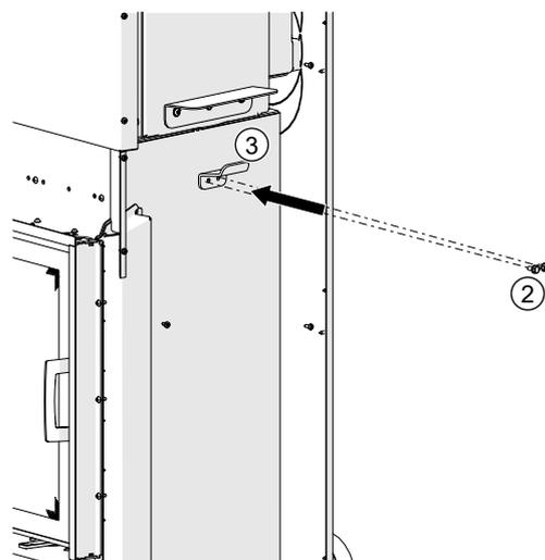
Fig. 26: Installez la fixation HMS
