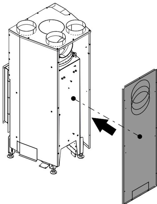
Fig. 63: Installer la paroi de convection arrière
