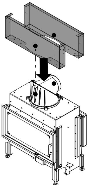
Fig. 68: Installer les parois de convection supérieures (avant + arrière)
