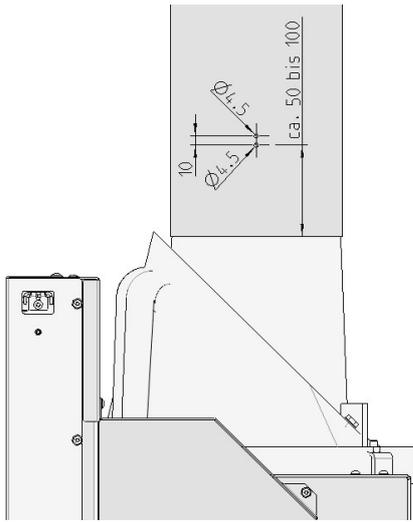
Fig. 41: Schéma de perçage pour conduit de fumée
