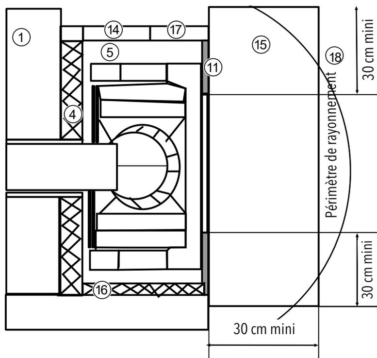
Fig. 6: Construction devant / à côté d'un mur à protéger
