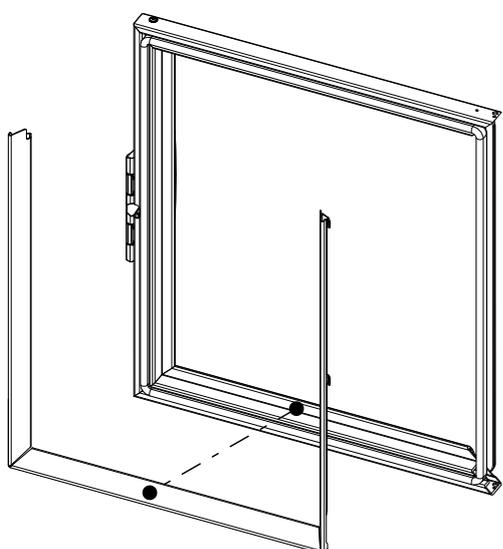
3) Installer les tôles de protection contre le rayonnement sur le côté droit et replier les languettes à la pince pour les fixer au cadre.
