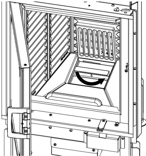
Fig. 97: Mettre le couvercle sur le bac à cendres
