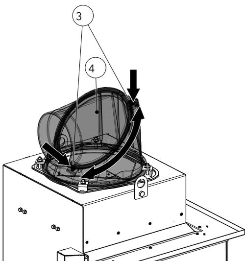
Fig. 93: Régler la buse de l'avaloir de fumées
