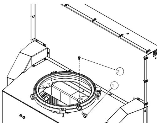
Fig. 29: Fixer la vis ou la sonde
