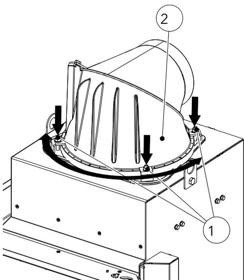
Fig. 92: Orienter l'avaloir de fumées dans la position souhaitée
