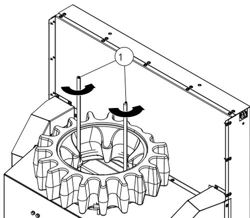
Fig. 31: Installer les tiges filetées
