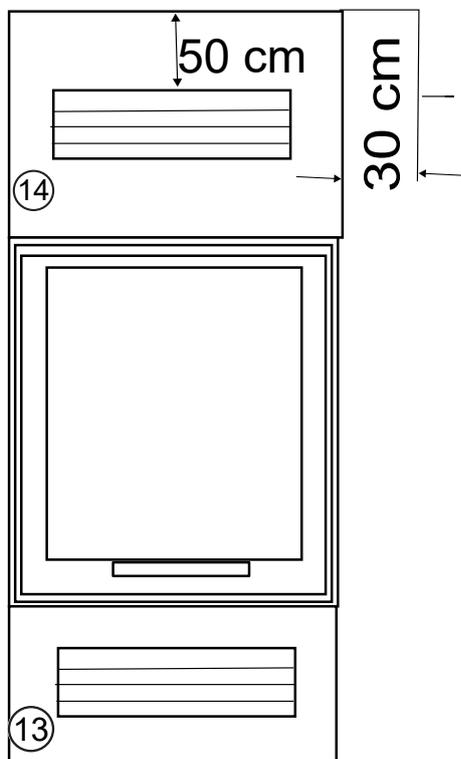
Fig. 8: Circulation de l'air de convection
