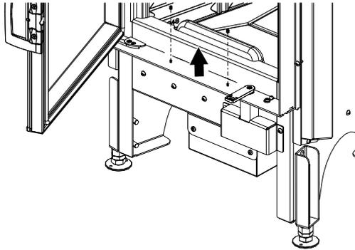
Fig. 74: Dévisser les boulons du bas
