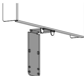
Fig. 69: Enclencher les parois de convection gauche et droite
