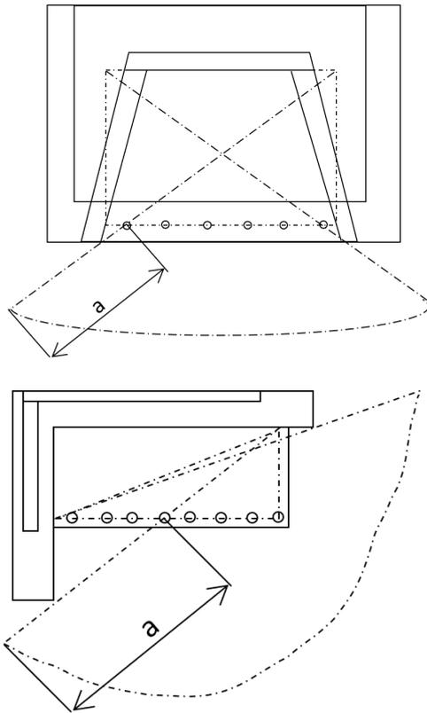
Dans le périmètre de rayonnement du foyer, ne pas poser d'objet inflammable à une distance inférieure à celle définie au chapitre **Données techniques** mesurée à partir du rebord avant de l'ouverture du foyer.
