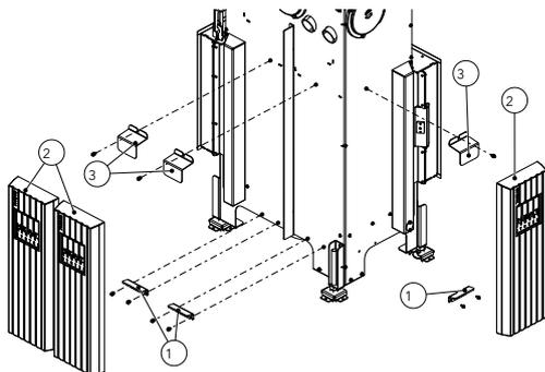
Fig. 36: Installer l'HMS 63x40x42
