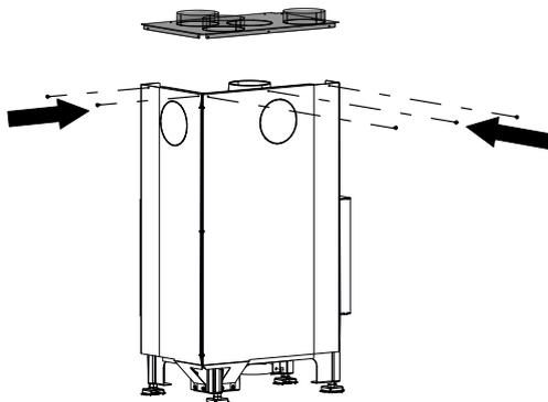
Fig. 71: Fixer le couvercle du kit de convection
