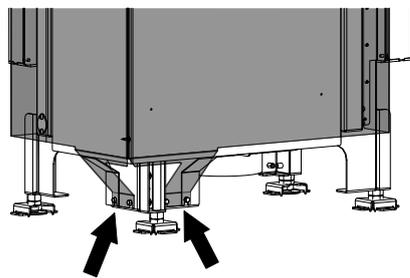
Fig. 70: Poser l'arrière et le côté du kit de convection sur le foyer
