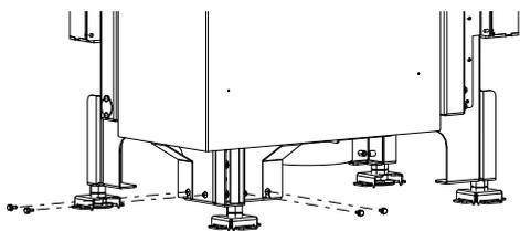
Fig. 68: Visser légèrement les vis hexagonales.
