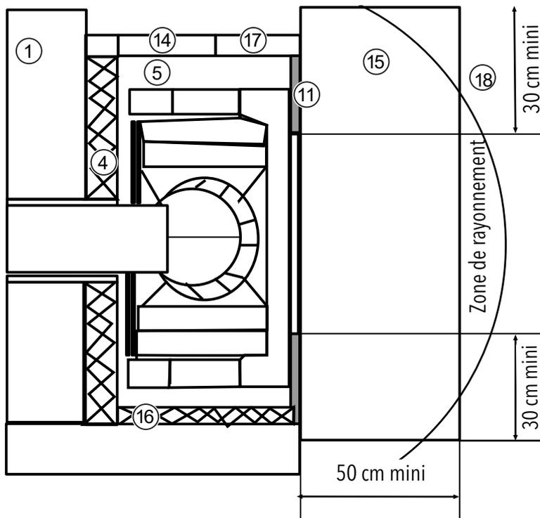
Fig. 7: Construction devant / à côté d'un mur protecteur
