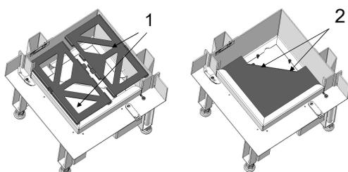
Fig. 57: Déposer les pièces du 38x
