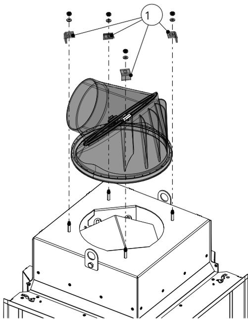
Fig. 37: Déposer l'avaloir de fumées
