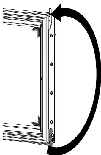
Fig. 25: Décrocher/raccrocher le ressort de la porte
