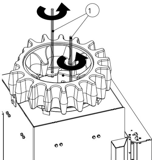
Fig. 47: Installer les tiges filetées
