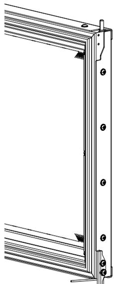
Fig. 24: Inverser la butée de la porte
