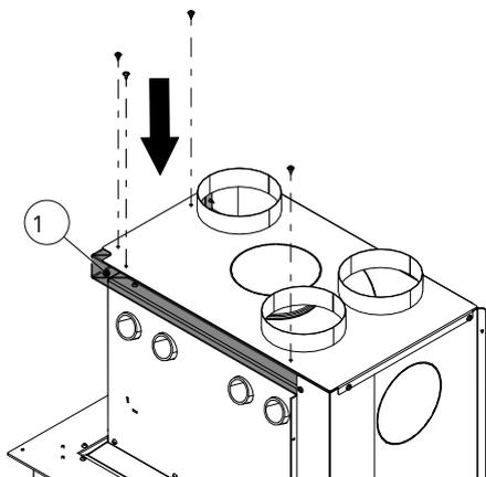
Fig. 72: Installer l'avant du kit de convection
