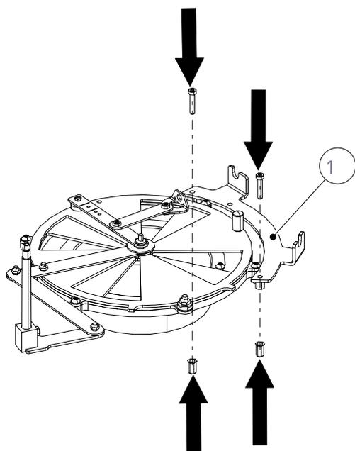
Fig. 60: Installer le kit de montage
