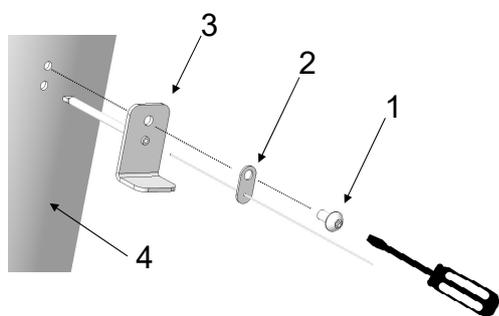
Fig. 55: Installer la sonde de température
