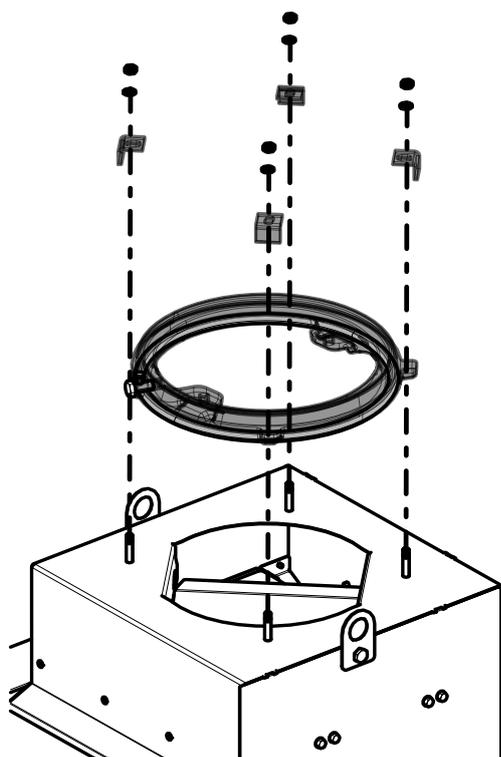
Fig. 44: Installer l'anneau de fixation inférieur
