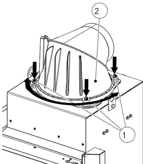
Fig. 80: Orienter l'avaloir de fumées dans la position souhaitée
