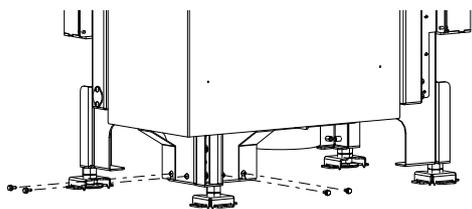
Fig. 68: Visser légèrement les vis hexagonales.
