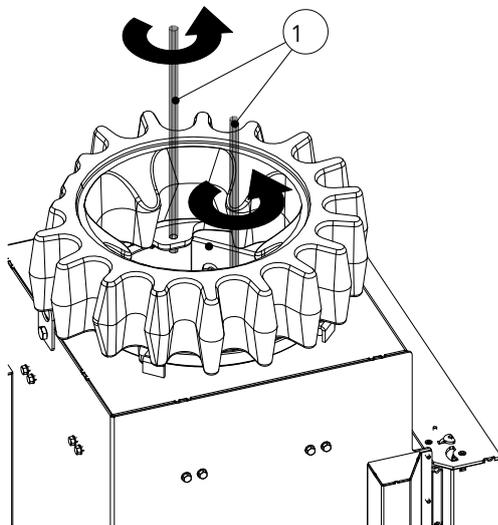
Fig. 47: Installer les tiges filetées
