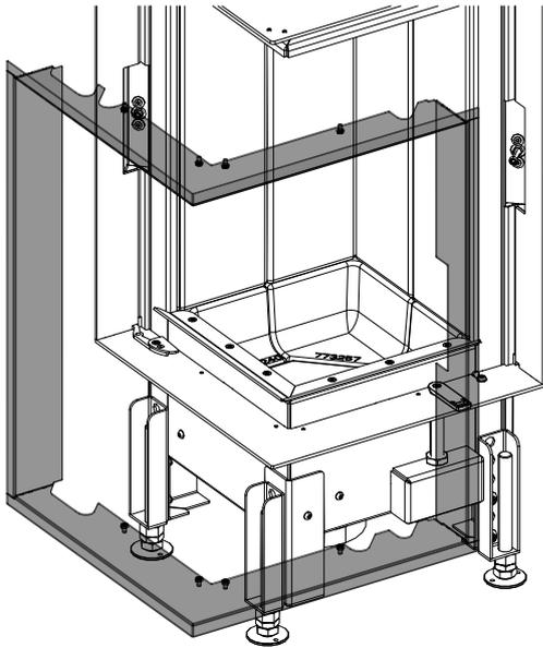
Fig. 74: Poser et fixer le cadre design
