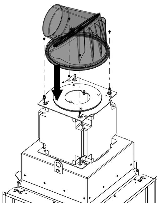
4) Mettre l'avaloir de fumées (5) sur le petit caisson d'accumulation et le fixer sur les boulons (4) avec les griffes de serrage (3), les rondelles (2) et les écrous hexagonaux (3).
