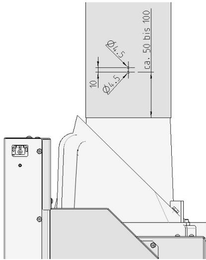
Fig. 54: Schéma de perçage pour conduit de fumée
