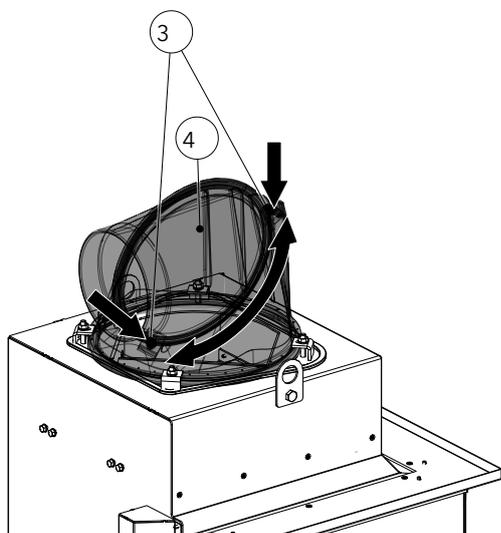
Fig. 81: Régler la buse de l'avaloir de fumées
