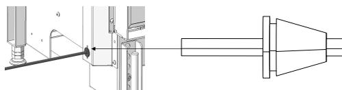
Fig. 64: Enclencher le bouchon en caoutchouc
