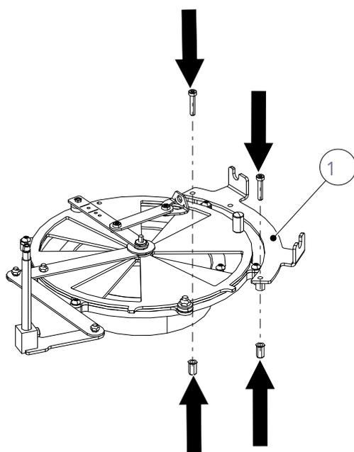
Fig. 60: Installer le kit de montage
