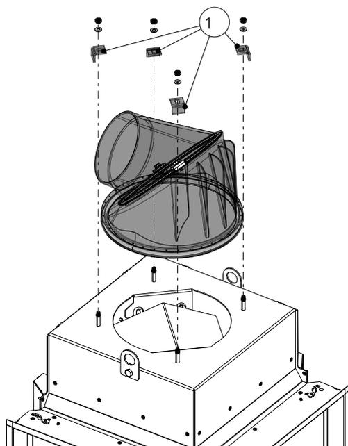
Fig. 37: Déposer l'avaloir de fumées.
