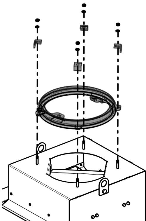
Fig. 44: Installer l'anneau de fixation inférieur
