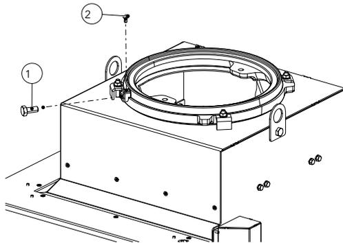
Fig. 45: Fixer la vis ou la sonde
