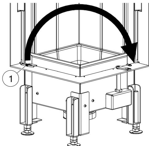
5) Déposer les recouvrements (1) et les installer de l'autre côté.
