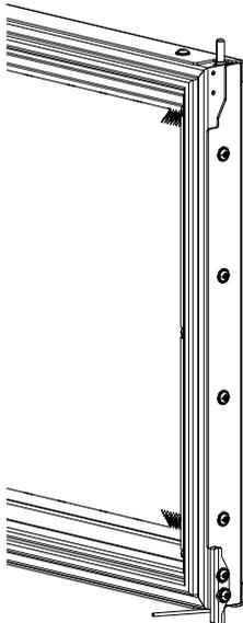
Fig. 24: Inverser la butée de la porte
