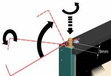
4) Accrocher le ressort et le tendre jusqu'à la butée de l'axe.
