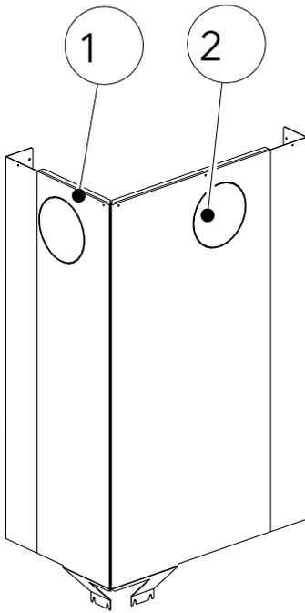
Fig. 69: Assembler l'arrière et le côté du kit de convection
