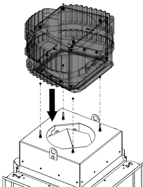
Fig. 38: Poser le grand caisson d'accumulation sur les boulons.
